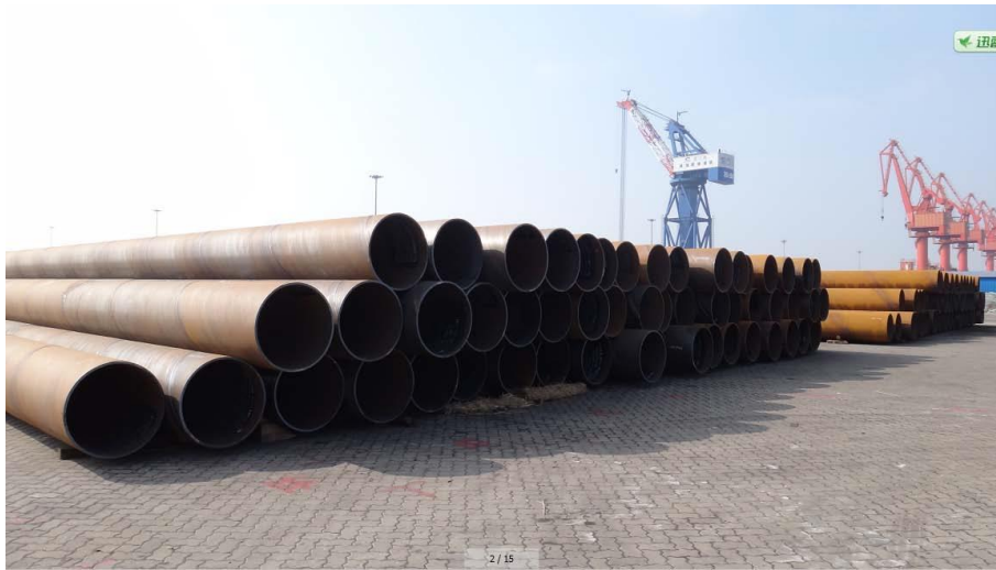
Figura N° 36 Acopio de pilotes
