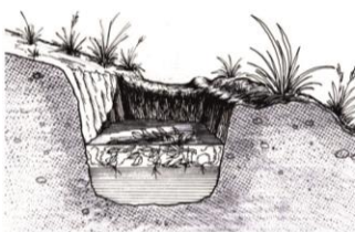
Sección transversal de una zanja de infiltración
