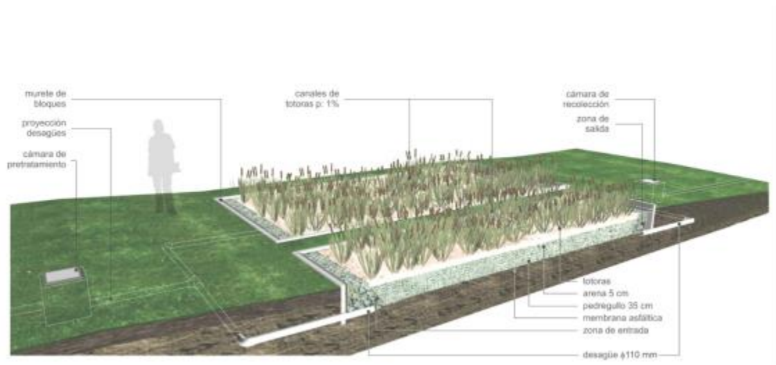
Imagen 38: Sistema de tratamiento de aguas servidas con humedales artificiales. Fuente: Waterscapes. Tratamiento de aguas residuales mediante sistemas vegetales. Hélène Izembart; Bertrand Le Boudec.
