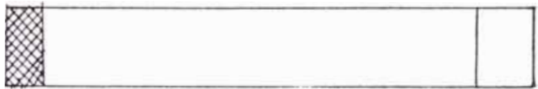
Figura 7 -9 Falta de Abrillantador Primario
