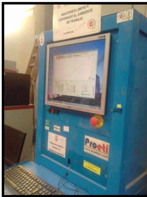
Fotografía N° 25: Resultado el ensayo de tracción por compresión diametral.
