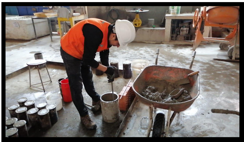
Fotografía N° 14: Compactación de la mezcla para el ensayo de Peso Unitario Compactado (Pág. 60).
