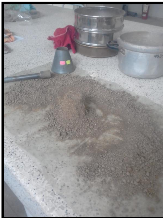
Fotografía N° 7: Método del cono, estado S.S.S en agregado fino.
