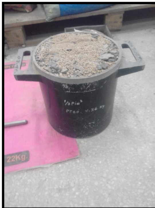
Fotografía N° 6: Agregado global antes del pesado.
