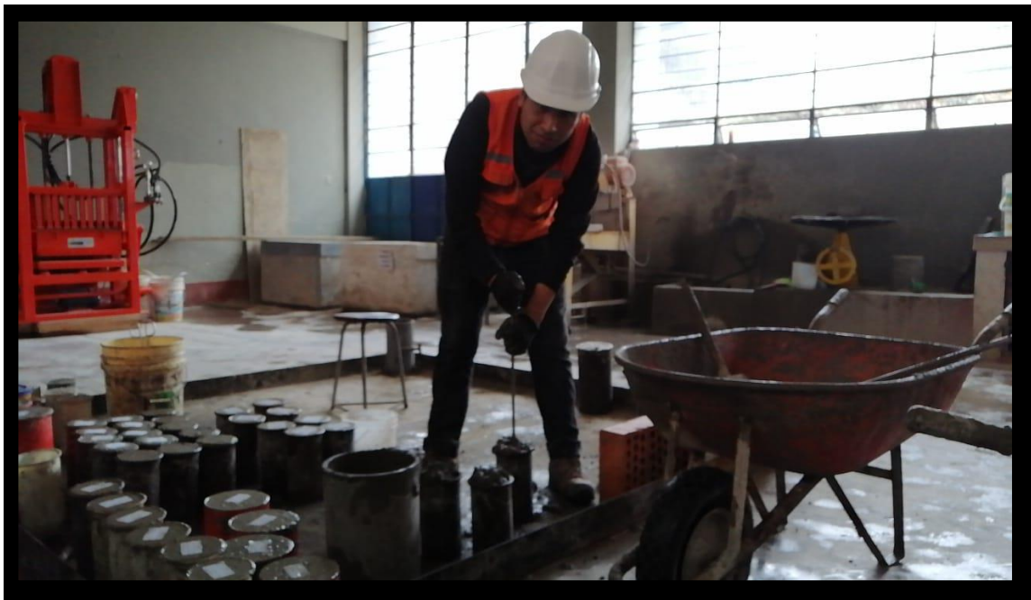
Fotografía N° 17: Varillado del concreto en la elaboración de probetas.
