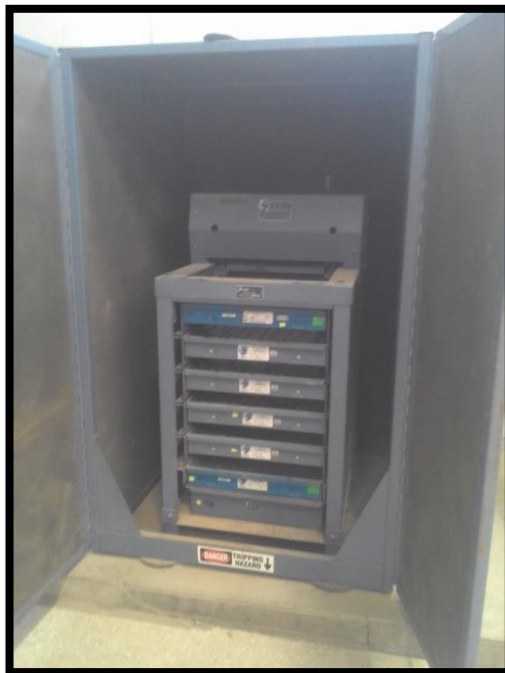
Fotografía N° 3: Equipo vibrador y tamices para agregado grueso.
