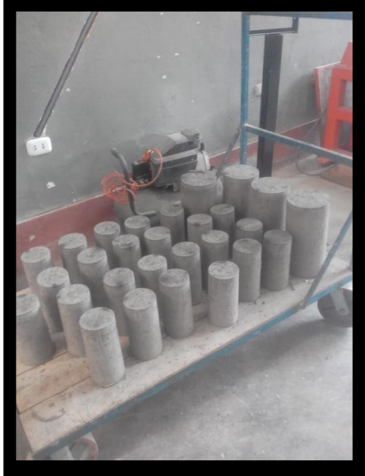
Fotografía N° 19: Probetas después del desmoldado.
