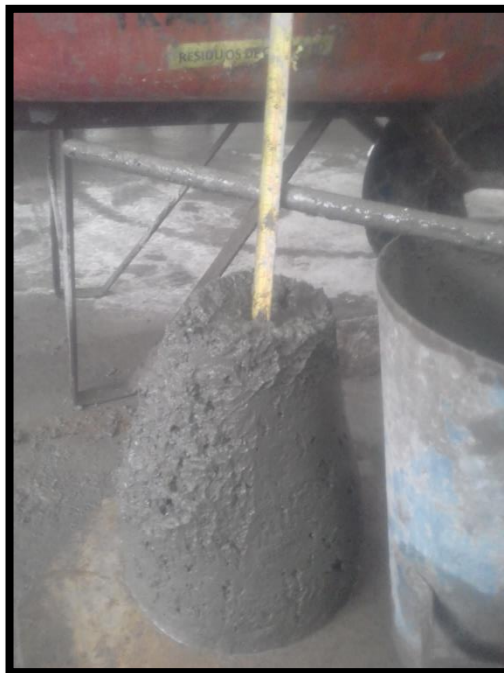
Fotografía N° 13: Ensayo de asentamiento del concreto en estado fresco.
