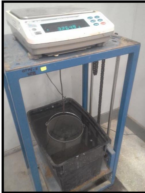
Fotografía N° 9: Pesado del agregado grueso saturado sumergido en agua.
