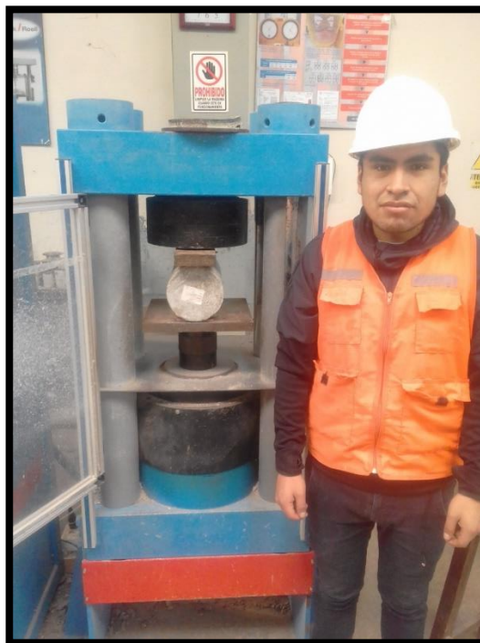
Fotografía N° 24: Equipo usado para el ensayo de tracción por compresión diametral.
