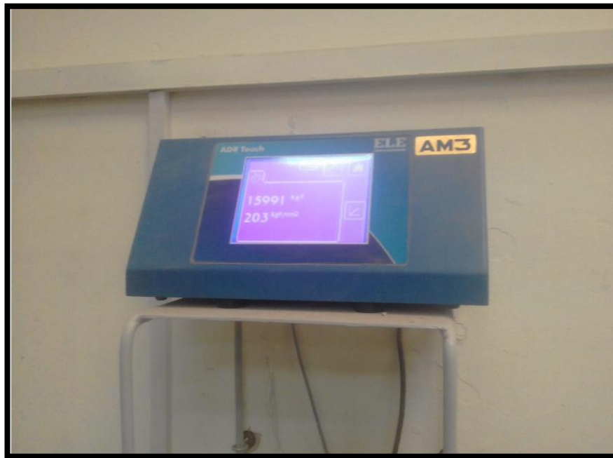
Fotografía N° 23: Resultado del ensayo a compresión.
