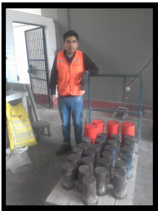
Fotografía N° 18: Probetas antes del desmoldado.
