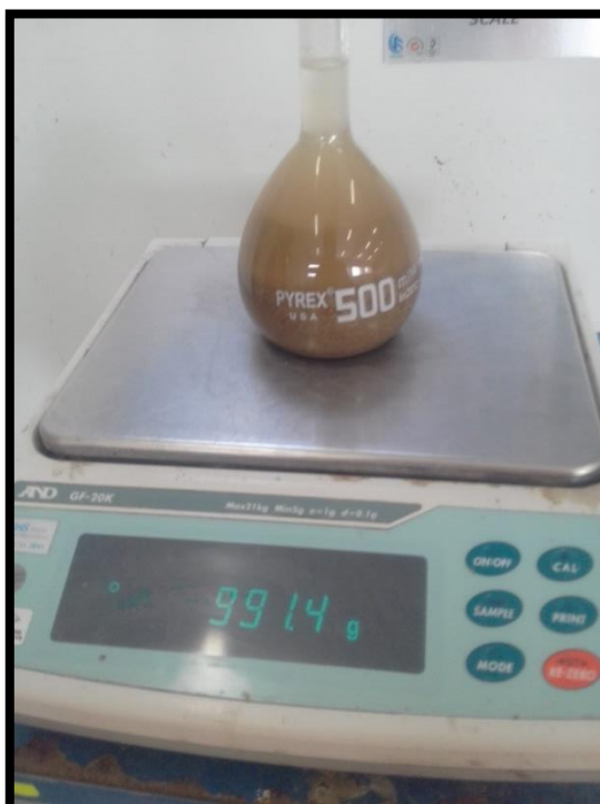
Fotografía N° 8: Pesado de la fiola con el agregado fino en estado S.S.S y agua hasta 500cc.
