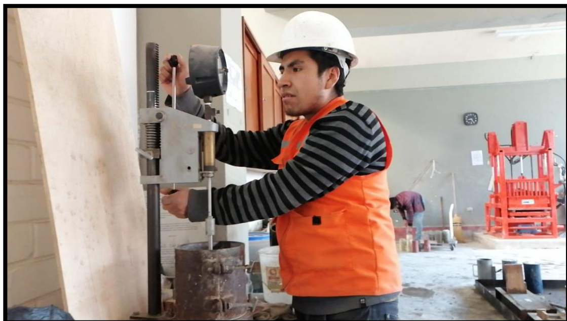
Fotografía N° 16: Registro de la fuerza aplicada en el penetrómetro para el ensayo de tiempo de fraguado.
