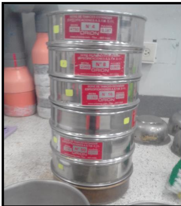
Fotografía N° 1: Tamices utilizados para la granulometría de agregado fino.
