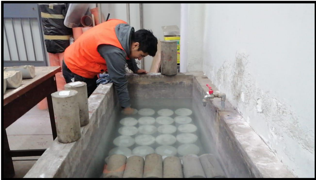
Fotografía N° 21: Curado de probetas de 15 x 30cm.
