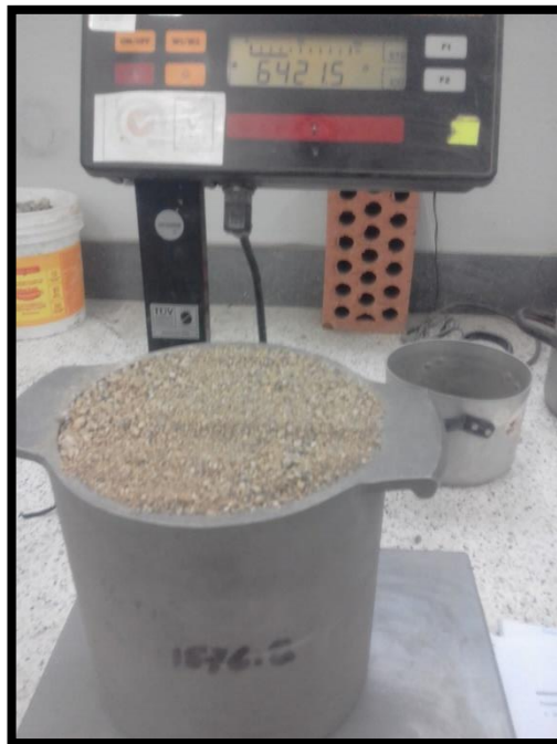
Fotografía N° 5: Pesado de agregado fino (P.U.S.).
