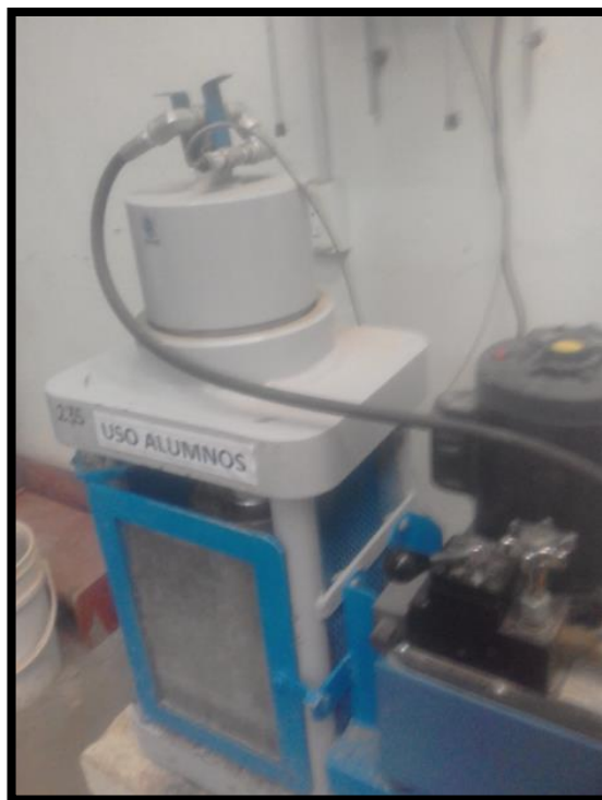
Fotografía N° 22: Equipo usado para el ensayo a compresión.
