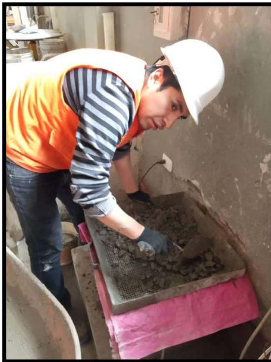
Fotografía N° 15: Tamizado de la mezcla de concreto a través de la malla N°4 en la mesa vibradora.
