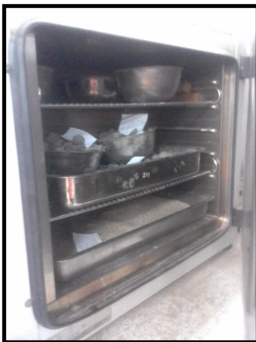
Fotografía N° 4: Horno para el secado del agregado fino y grueso.
