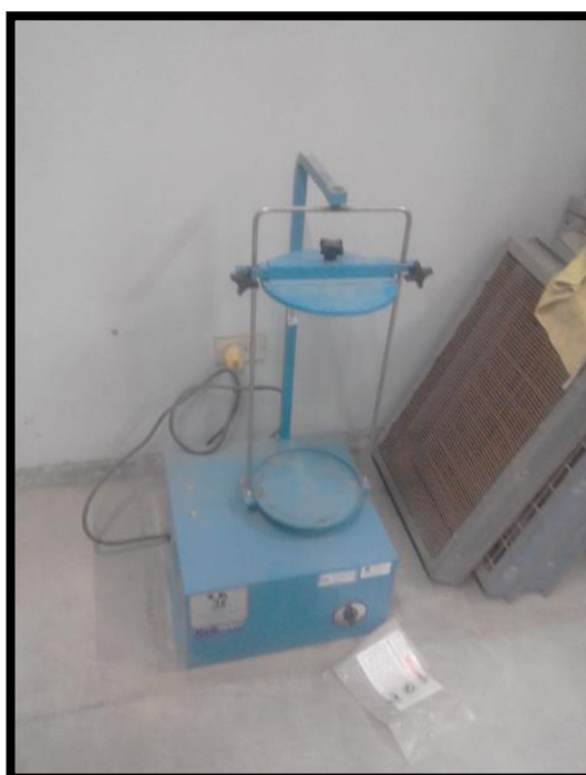
Fotografía N° 2: Equipo vibrador para ensayo de granulometría del agregado fino.
