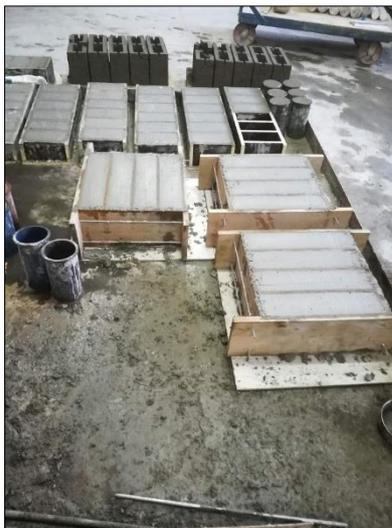
Figura N° 6.5 Proceso de fraguado de los bloques de concreto ligero.
