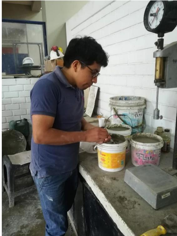
Ensayo de exudación del concreto ligero.
