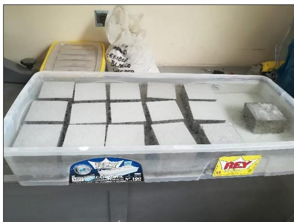
Figura N° 5.4 Poza de curado para los cubos de concreto ligero.
