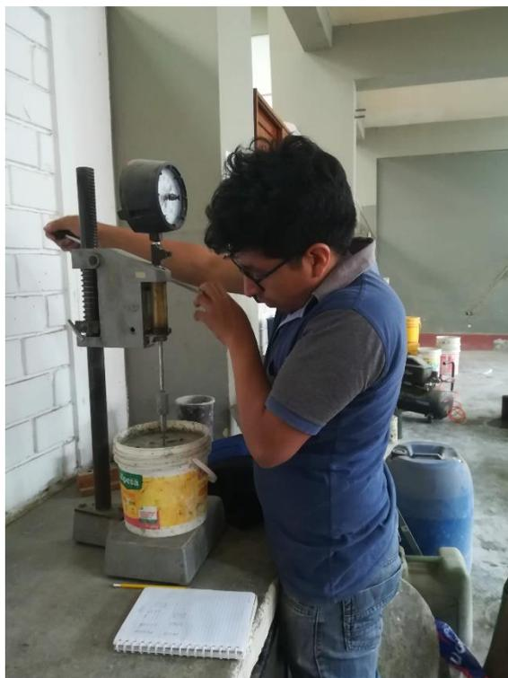
Ensayo del tiempo de fragua del concreto ligero.
