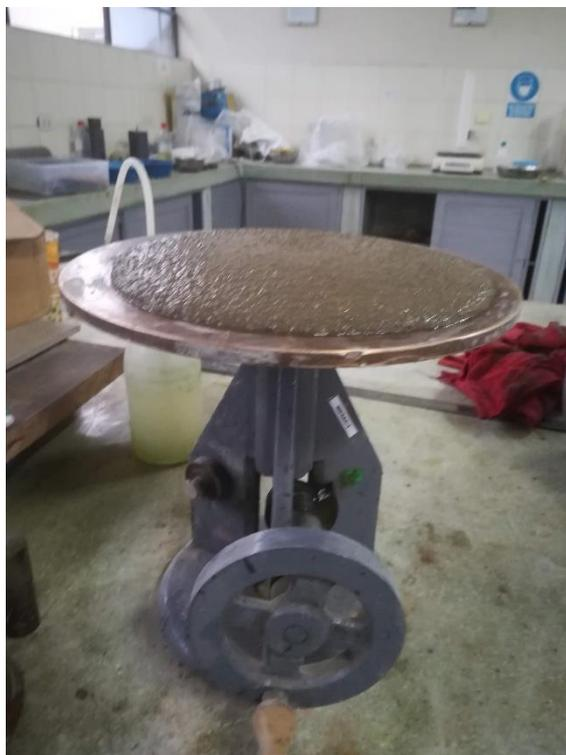
Fluidez del mortero de albañilería.
