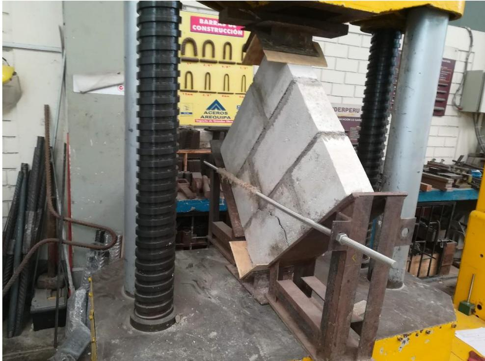
Ensayo de resistencia a la compresión diagonal de muretes (carga de falla).
