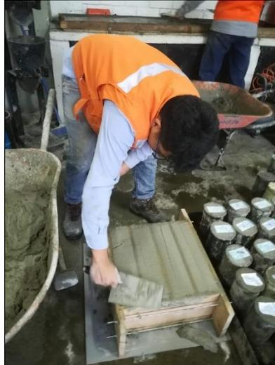
Figura N° 6.4 Vaciado del concreto ligero en los moldes.
