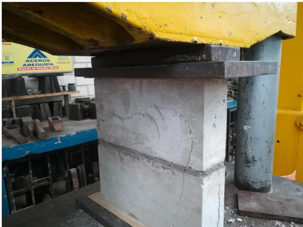
Ensayo de resistencia a la compresión de pilas (carga de falla).
