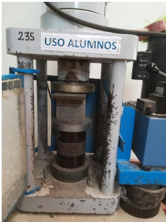
Ensayo de resistencia a la compresión de cubos de concreto ligero de 10cm.
