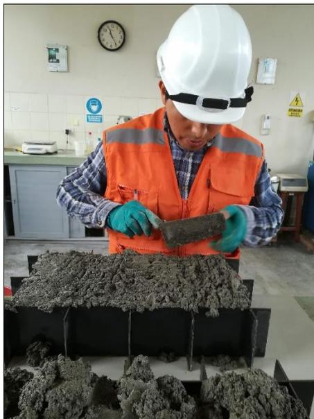
Figura N° 5.3 Vaciado de concreto ligero en los moldes cúbicos de 10 x 10 x 10 cm.
