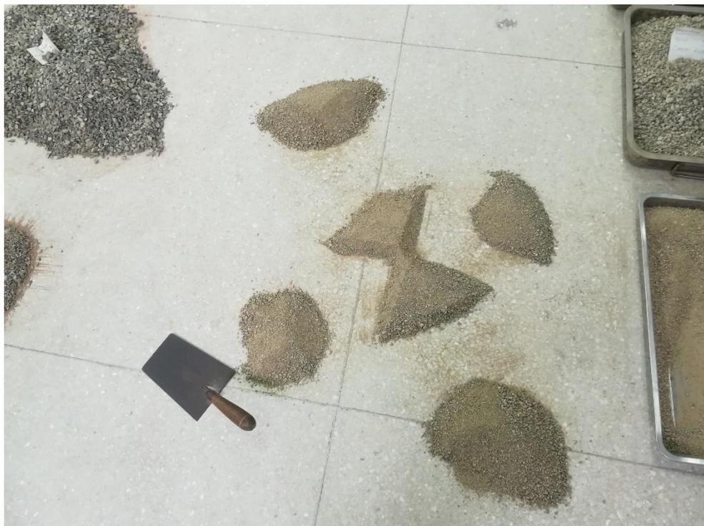
Cuarteo del agregado para ensayo de granulometría.
