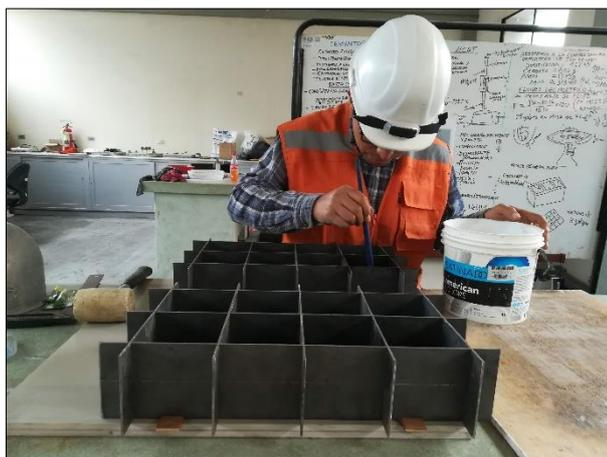
Figura N° 5.1 Molde cubico metálico de 10 x 10 x 10 cm, aplicación del desmoldante.
