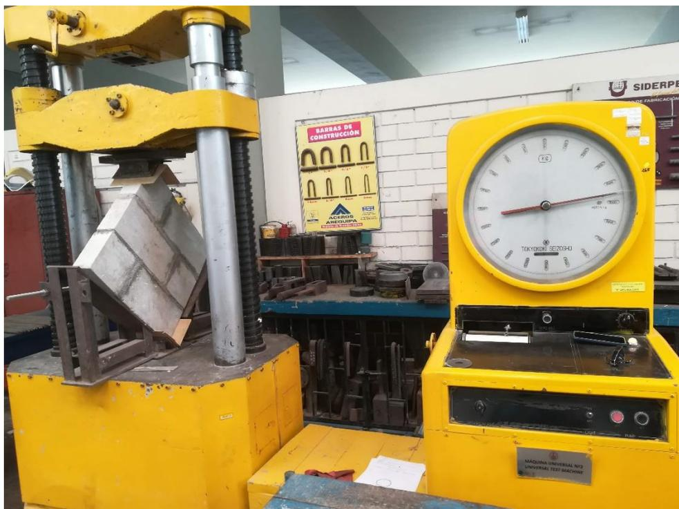
Ensayo de resistencia a la compresión diagonal de muretes.
