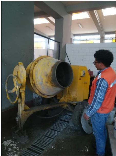
Figura N° 6.3 Mezclado de los materiales de la dosificación C1 para una tanda de 0.085 m<sup>3</sup> de concreto ligero.
