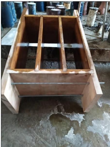
Figura N° 6.2 Estructura del molde formada por tablas de espesores de 1.5 cm, y aplicación de petróleo (desmoldante).
