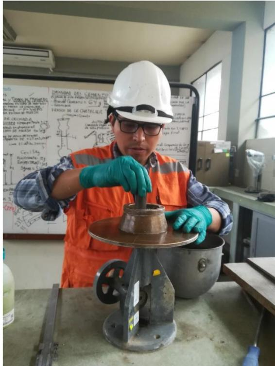
Proceso de ensayo de fluidez del mortero de albañilería.
