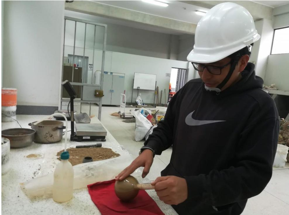
Ensayo de Peso Específico del agregado fino.
