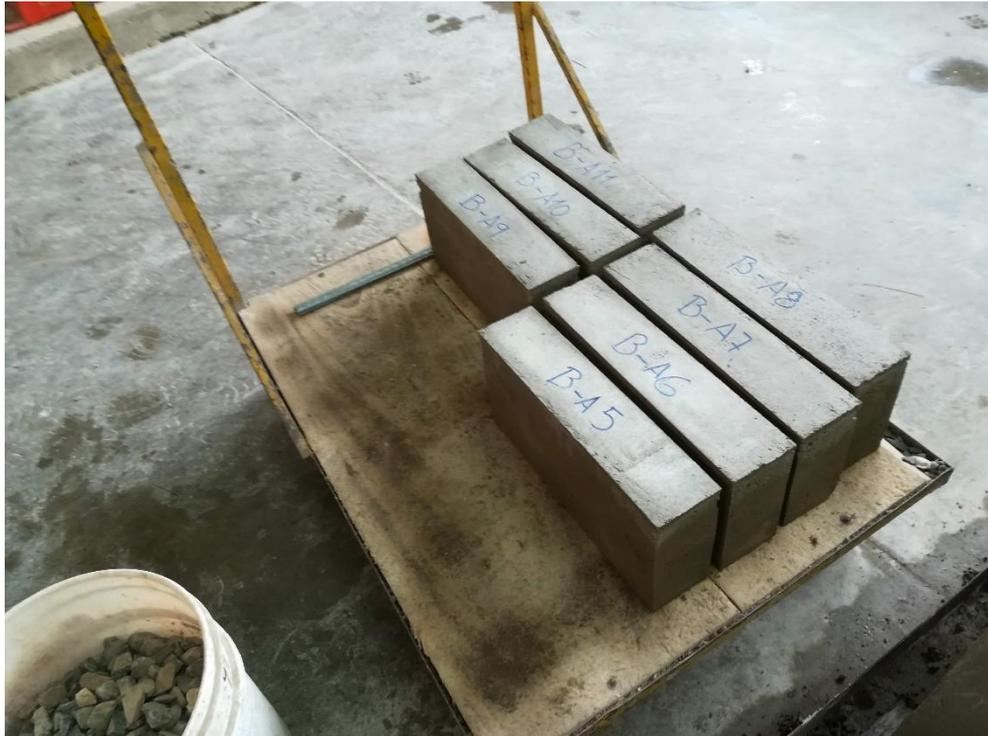
Bloque de concreto ligero (después del desencofrado).
