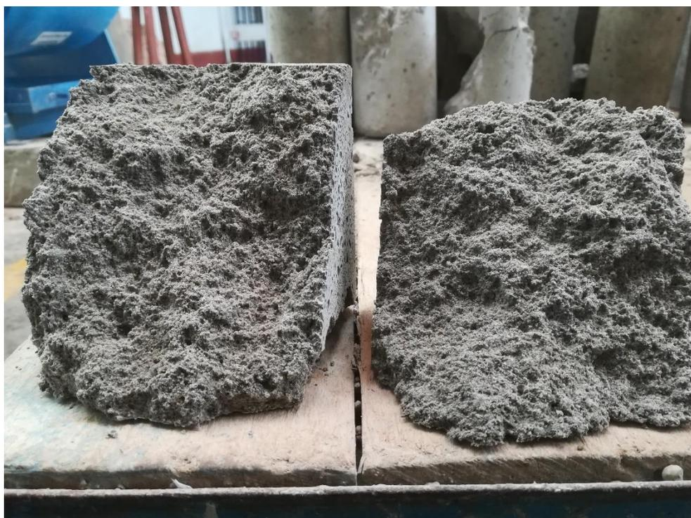
Plano de falla después del ensayo del cubo de concreto ligero.
