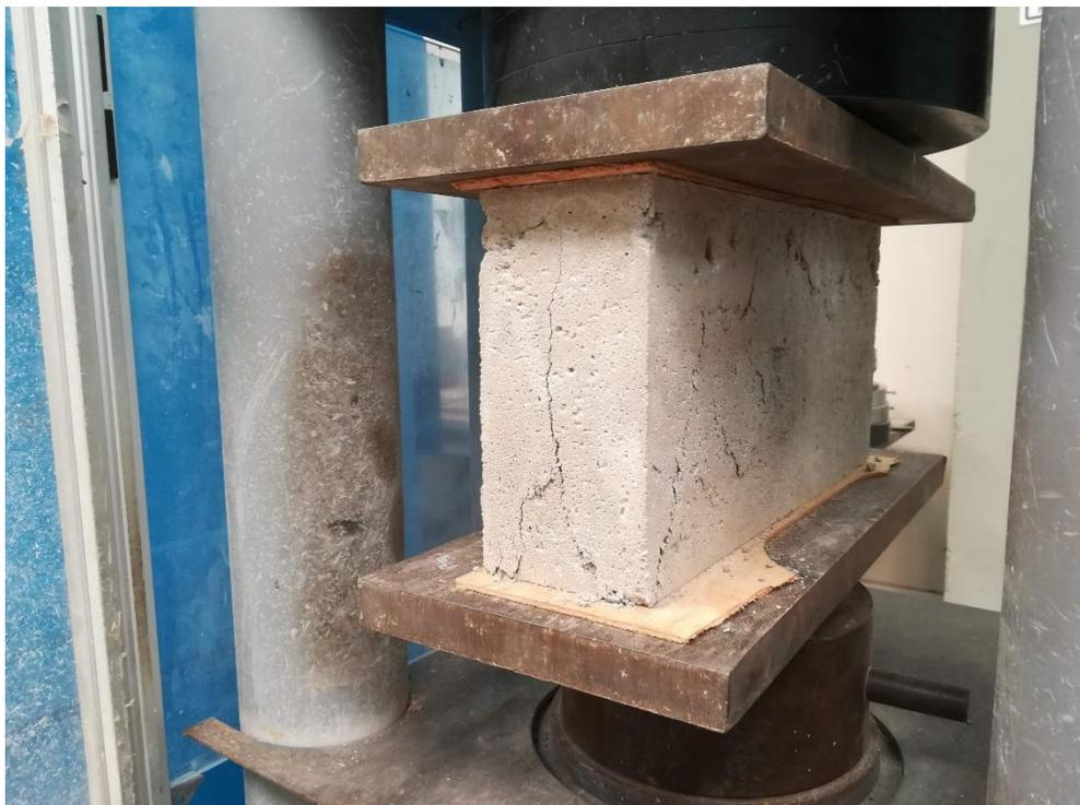
Ensayo de resistencia a la compresión de bloque de concreto ligero.
