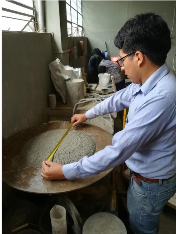
Ensayo de la fluidez del concreto ligero.
