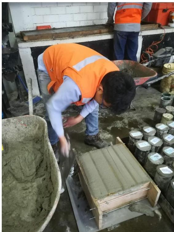
Llenado del concreto ligero en moldes para bloques de concreto ligero
