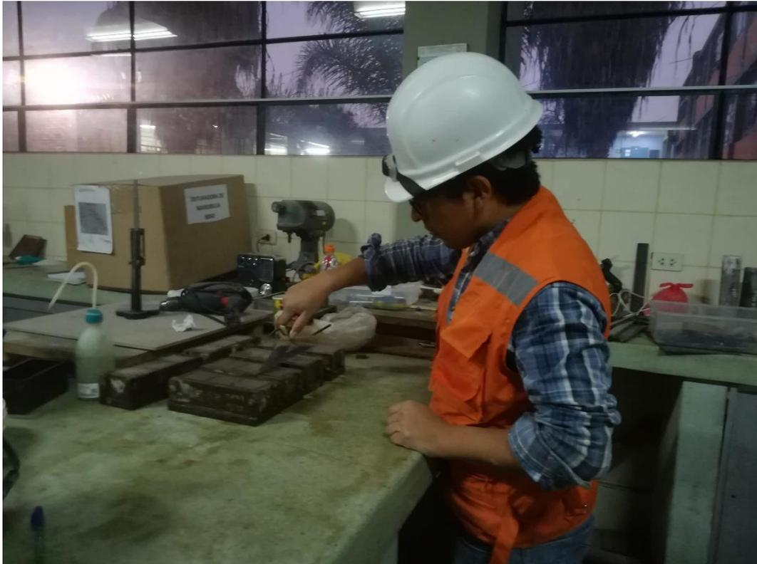
Llenado del mortero de albañilería en moldes cúbicos de 5cm.
