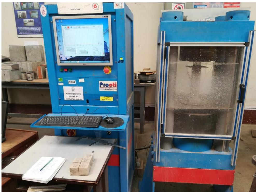
Ensayo a la compresión de cubos de mortero de albañilería.
