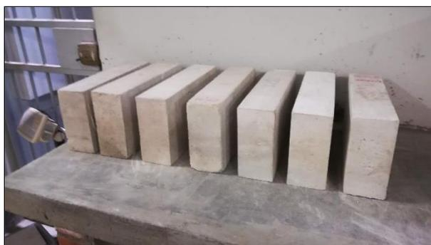
Figura N° 6.7 Proceso de secado y almacenamiento de los bloques de concreto ligero.
