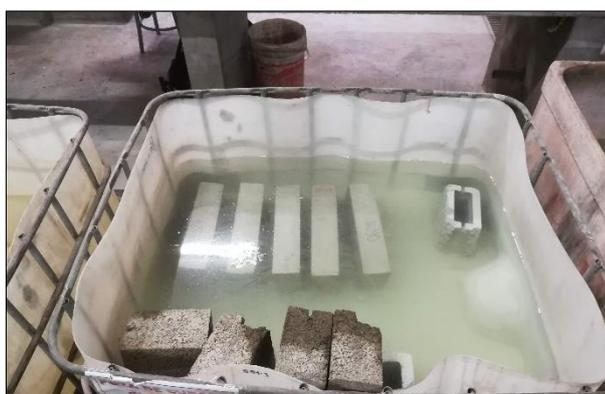
Figura N° 6.6 Pozas de curado para los bloques de concreto ligero.
