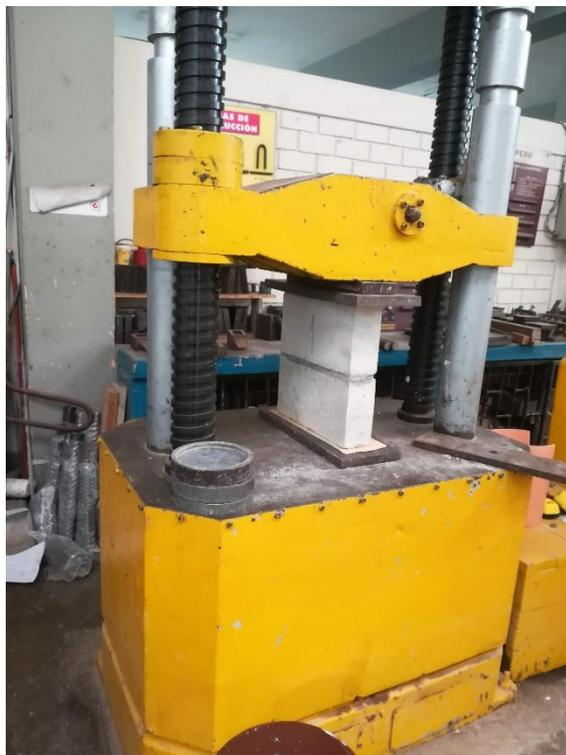
Ensayo de resistencia a la compresión de pilas de bloques de concreto ligero.
