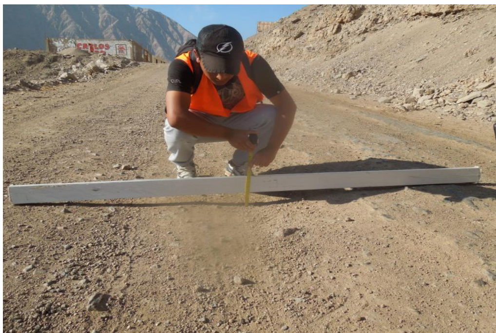
Figura N° 126 Medición de la falla superficial perdida de agregado. Prog.km 10+400, foto tomada a los 22 meses de haberse rehabilitado el camino (16-05-2016)
