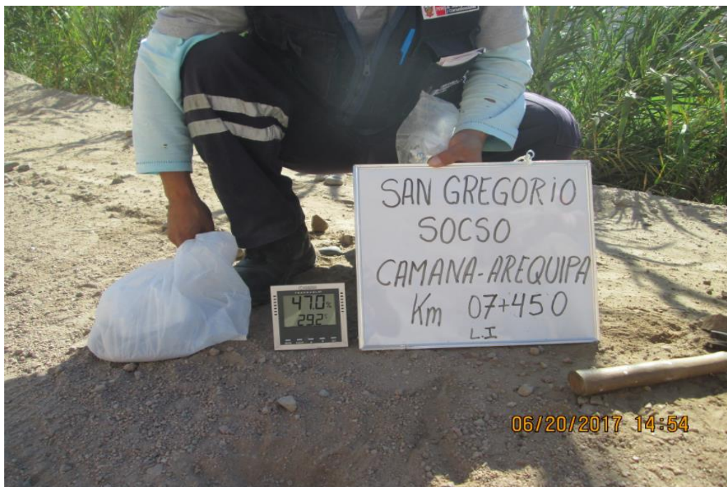
Figura N° 138 Toma de datos de humedad y Temperatura. Prog.km 07+450, foto tomada a los 35 meses de haberse rehabilitado el camino San Gregorio Socso (20-06-2017)
