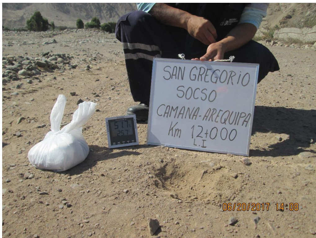
Figura N° 139 Toma de datos de humedad y Temperatura. Prog.km 12+000, foto tomada a los 35 meses de haberse rehabilitado el camino San Gregorio Socso (20-06-2017)
