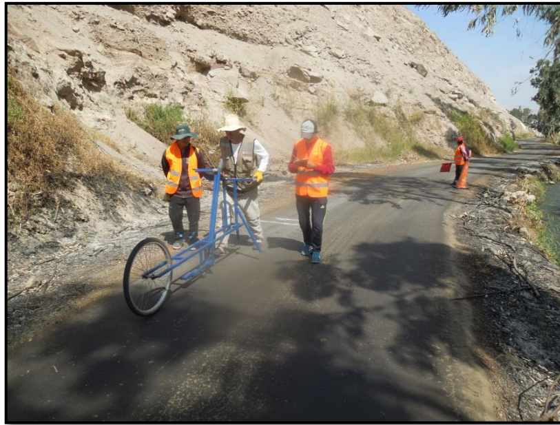
Figura N° 40 Vista de los dos trabajadores y el técnico responsable encargado de realizar la medición de la rugosidad en la huella derecha, al fondo de la imagen se puede observar a la persona encargada del desvío del tráfico.
