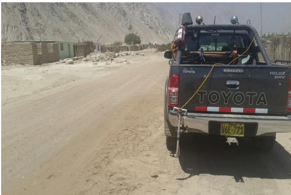
Figura N° 134 Medición de polvo empleando el equipo DUSTMATE. Prog.km 24+100, foto tomada a los 27 meses de haberse rehabilitado el camino (12-10-2016).
