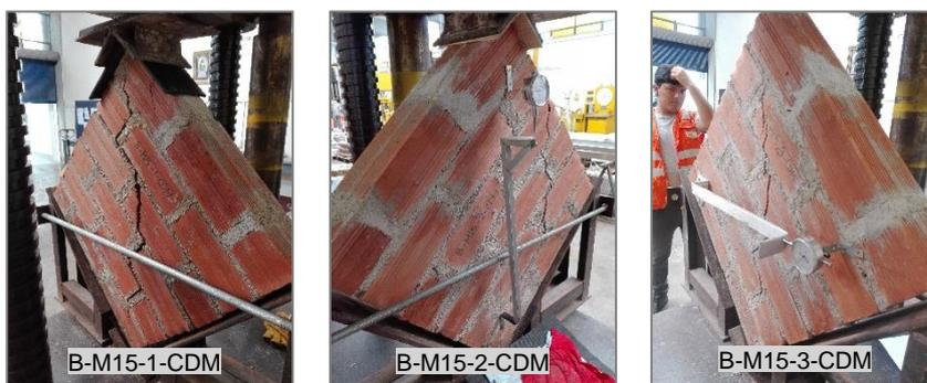
Figura N° 5.32 Fallas en muretes de ladrillo Clase B y mortero convencional C:A 1:5
