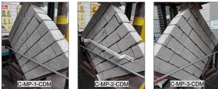
Figura N° 5.38 Fallas en muretes de ladrillo Clase C y mortero polimérico
