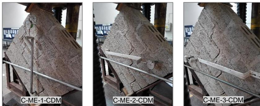
Figura N° 5.37 Fallas en muretes de ladrillo Clase C y mortero embolsado
