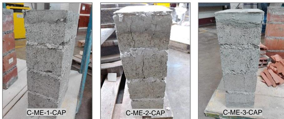
Figura N° 5.17 Vista lateral de las fallas en las pilas (Ladrillo: Clase C – Mortero: Embolsado)
