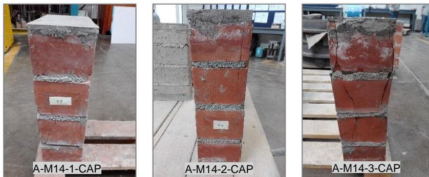
Figura N° 5.7 Vista lateral de fallas en las pilas (Ladrillo: Clase A – Mortero: Convencional C:A 1:4)
