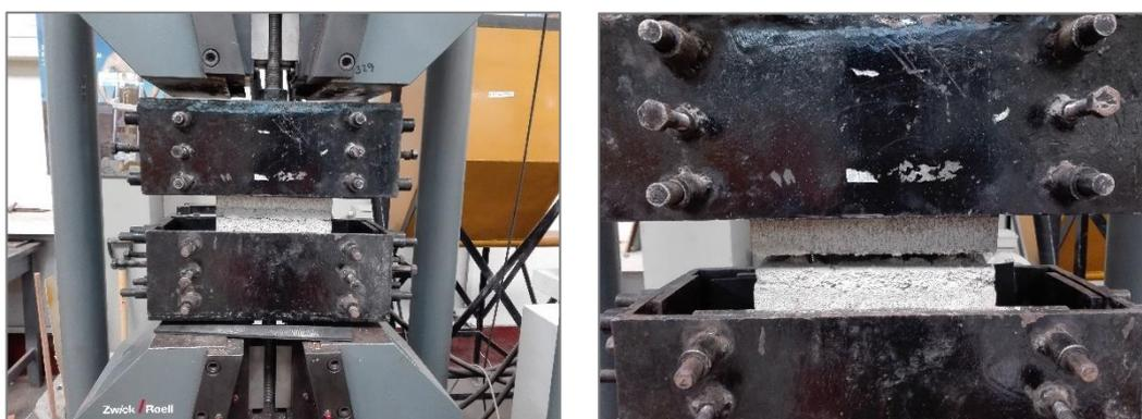
Figura N° 5.43 Ensayo de adherencia en pilas de albañilería de ladrillos Konkreto y mortero de cemento (derecha); Falla en la adherencia del mortero de cemento, el ladrillo se despega totalmente de la capa de mortero (derecha)
