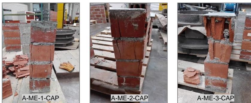
Figura N° 5.9 Vista lateral de fallas en las pilas (Ladrillo: Clase A – Mortero: Embolsado)
