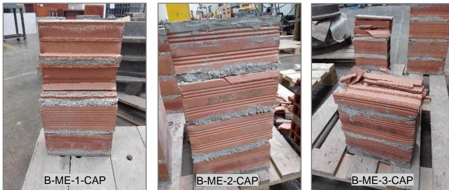
Figura N° 5.13 Vista lateral de fallas en pilas (Ladrillo: Clase B – Mortero: Embolsado)
