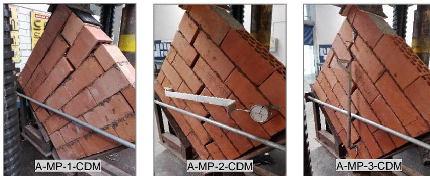
Figura N° 5.30 Fallas en muretes de ladrillo Clase A y mortero polimérico
