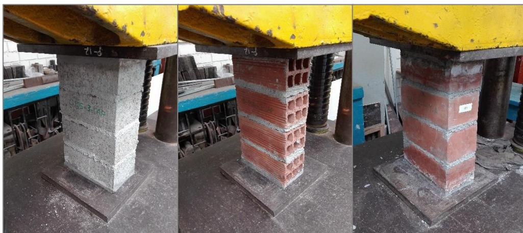
Figura N° 5.5 Ensayo de compresión axial en pilas de albañilería de ladrillos (King Kong 18 huecos, Pandereta Acanalada y Konkreto) y morteros de cemento (Convencional C:A 1:4, Convencional C:A 1:5 y Embolsado)
