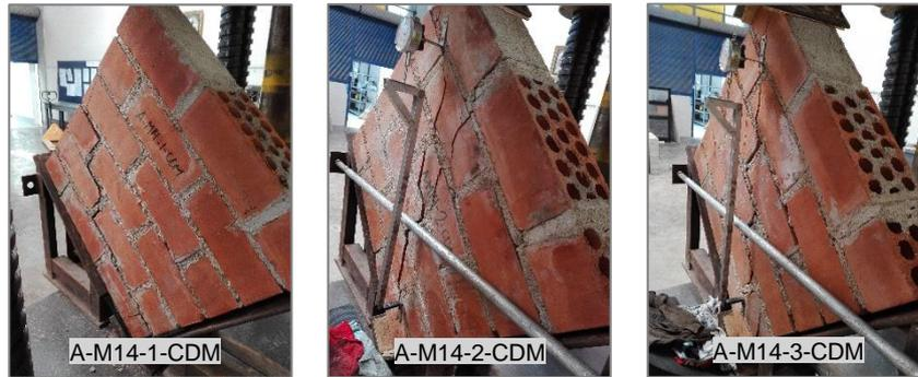
Figura N° 5.27 Fallas en muretes de ladrillo Clase A y mortero convencional C:A 1:4
