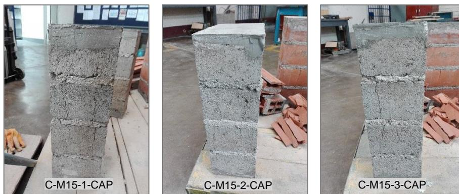
Figura N° 5.16 Vista lateral de fallas en pilas (Ladrillo: Clase C – Mortero: Convencional C:A 1:5)
