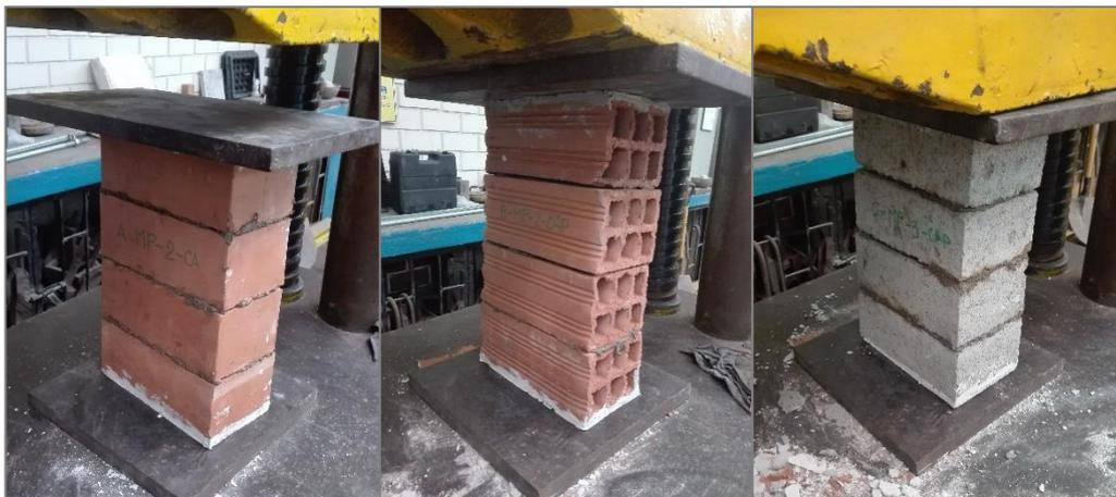
Figura N° 5.6 Ensayo de compresión axial en pilas de albañilería de ladrillos (King Kong 18 huecos, Pandereta Acanalada y Konkreto) y mortero polimérico
