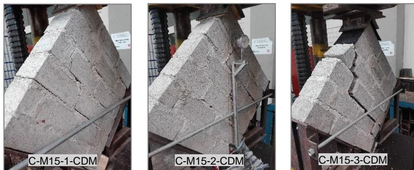
Figura N° 5.36 Fallas en muretes de ladrillo Clase C y mortero convencional C:A 1:5
