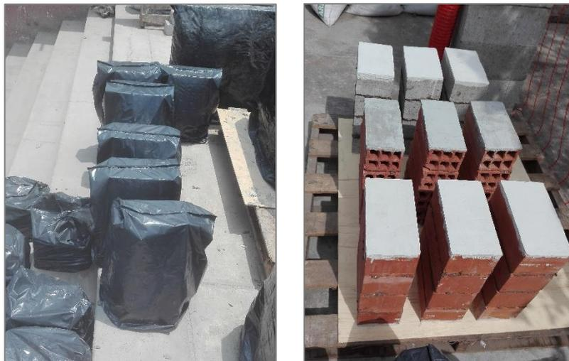
Figura N° 5.4 Protección de pilas empleando polietileno (izquierda); Refrendado de pilas de albañilería de mortero polimérico (derecha)
