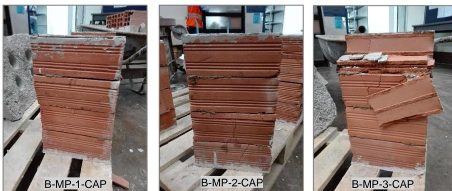
Figura N° 5.14 Vista lateral de fallas en pilas (Ladrillo: Clase B – Mortero: Polimérico)
