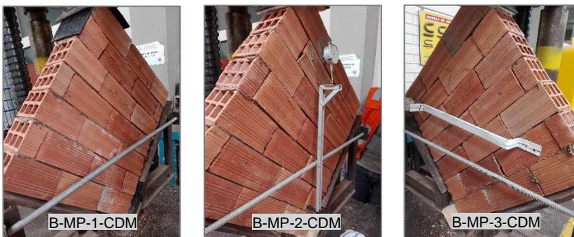
Figura N° 5.34 Fallas en muretes de ladrillo Clase B y mortero polimérico
