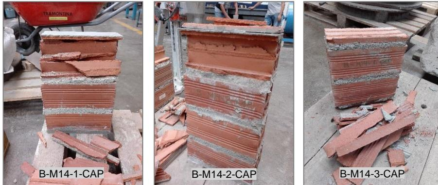
Figura N° 5.11 Vista lateral de fallas en pilas (Ladrillo: Clase B – Mortero: Convencional C:A 1:4)
