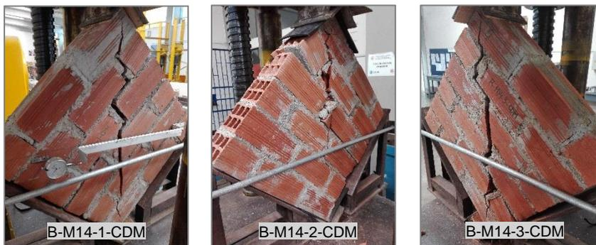
Figura N° 5.31 Fallas en muretes de ladrillo Clase B y mortero convencional C:A 1:4
