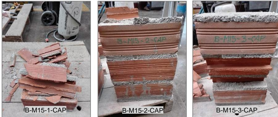
Figura N° 5.12 Vista lateral de fallas en pilas (Ladrillo: Clase B – Mortero: Convencional C:A 1:5)
