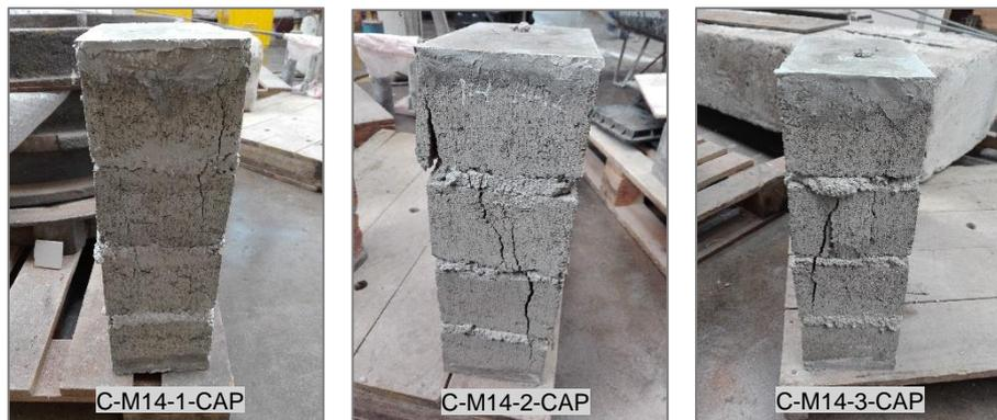
Figura N° 5.15 Vista lateral de fallas en pilas (Ladrillo: Clase C – Mortero: Convencional C:A 1:4)
