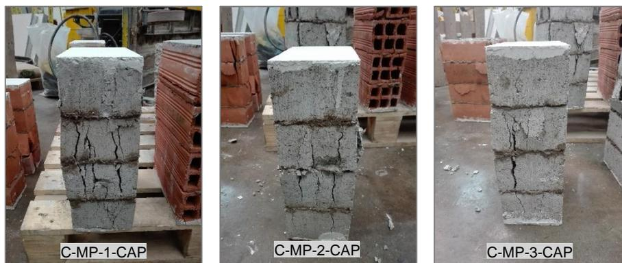
Figura N° 5.18 Vista lateral de las fallas en las pilas (Ladrillo: Clase C – Mortero: Polimérico)
