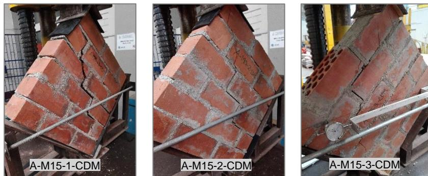
Figura N° 5.28 Fallas en muretes de ladrillo Clase A y mortero convencional C:A 1:5
