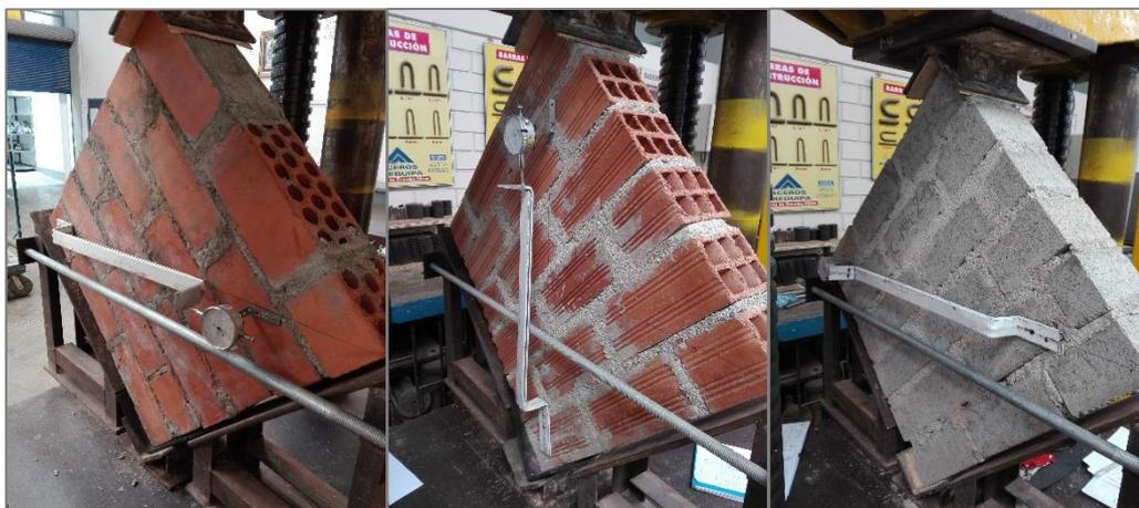
Figura N° 5.25 Ensayo de compresión diagonal en muretes de albañilería de ladrillos (King Kong 18 huecos, Pandereta Acanalada y Konkreto) y morteros de cemento (Convencional C:A 1:4, Convencional C:A 1:5 y Embolsado)
