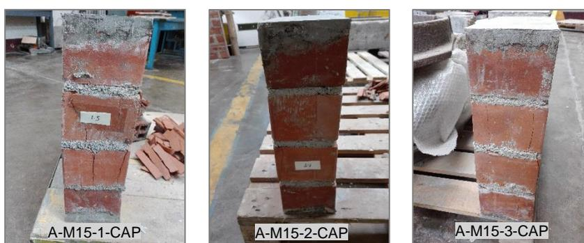
Figura N° 5.8 Vista lateral de fallas en las pilas (Ladrillo: Clase A – Mortero: Convencional C:A 1:5)
