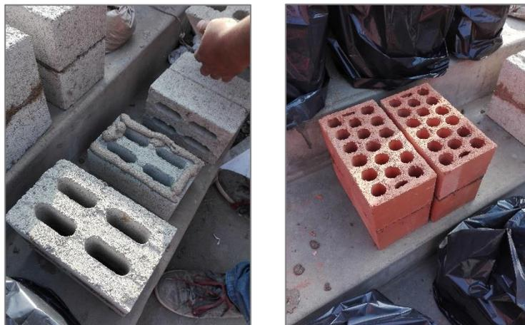
Figura N° 5.40 Aplicación de mortero polimérico en pilas de concreto (izquierda); Pilas de dos ladrillos Clase A con mortero polimérico (derecha)
