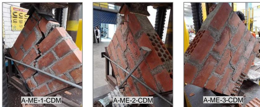
Figura N° 5.29 Fallas en muretes de ladrillo Clase A y mortero embolsado
