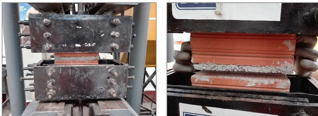
Figura N° 5.42 Ensayo de adherencia en pilas de albañilería de ladrillos Pandereta Acanalada y mortero de cemento (derecha); Falla en la adherencia del mortero de cemento, el ladrillo se despega totalmente de la capa de mortero (derecha)
