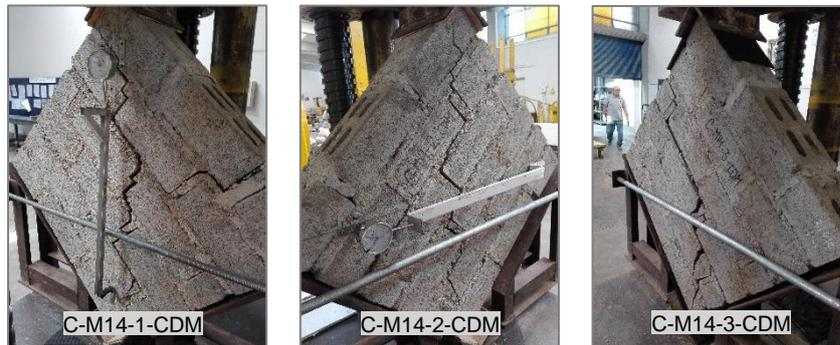
Figura N° 5.35 Fallas en muretes de ladrillo Clase C y mortero convencional C:A 1:4
