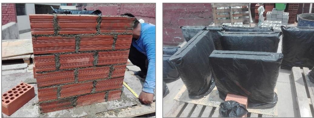
Figura N° 5.20 Murete de albañilería concluido (izquierda); Protección de muretes utilizando polietileno (derecha)
