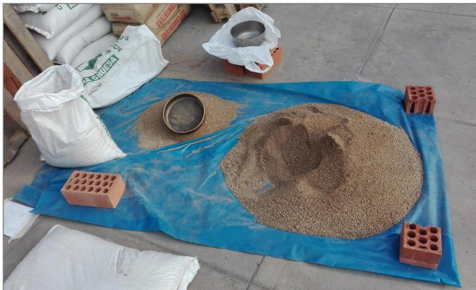
Figura N° 4.1 Tamizado del agregado con las Mallas N°4 y N° 8
