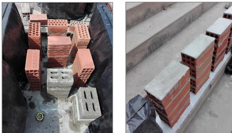
Figura N° 5.2 Pilas de albañilería de diferentes combinaciones de mortero de cemento y ladrillaría (izquierda); Refrendado de pilas de albañilería (derecha)
