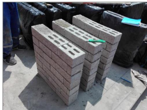
Figura N° 5.24 Muretes construidos con ladrillos Konkreto y mortero polimérico
