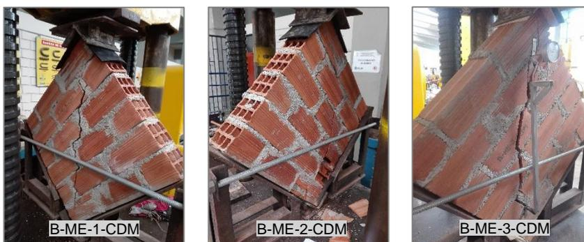
Figura N° 5.33 Fallas en muretes de ladrillo Clase B y mortero embolsado
