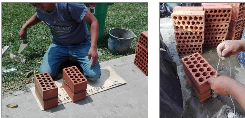
Figura N° 5.39 Construcción y aplomado de pilas de dos de ladrillos
