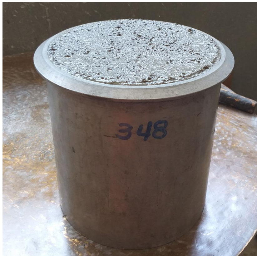
Recipiente enrasado con concreto fresco, listo para ser pesado en la balanza electrónica y calcular el Peso Unitario.
