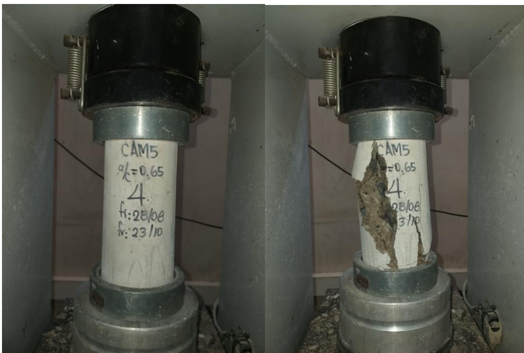
Probeta N°4 de 10x20cm, a/c:0.65 del diseño Concreto con Aditivo más Micromineral al 5% (CAM5) antes y después de ser ensayada a Compresión a la edad de 56 días.
