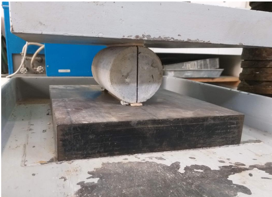
Probeta N°2 de 10x20cm, a/c: 0.65 del diseño Concreto patrón más Aditivo (CPA) listo y ubicado con listones de triplay diametralmente opuestos para ser sometido a ensayo de Tracción por Compresión Diametral.
