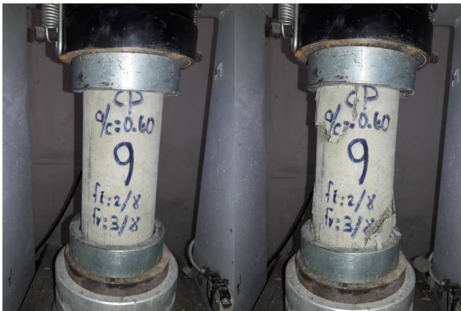
Probeta N°9 de 10x20cm, a/c:0.60 del diseño Concreto Patrón (CP) antes y después de ser ensayada a Compresión a la edad de 1 día.
