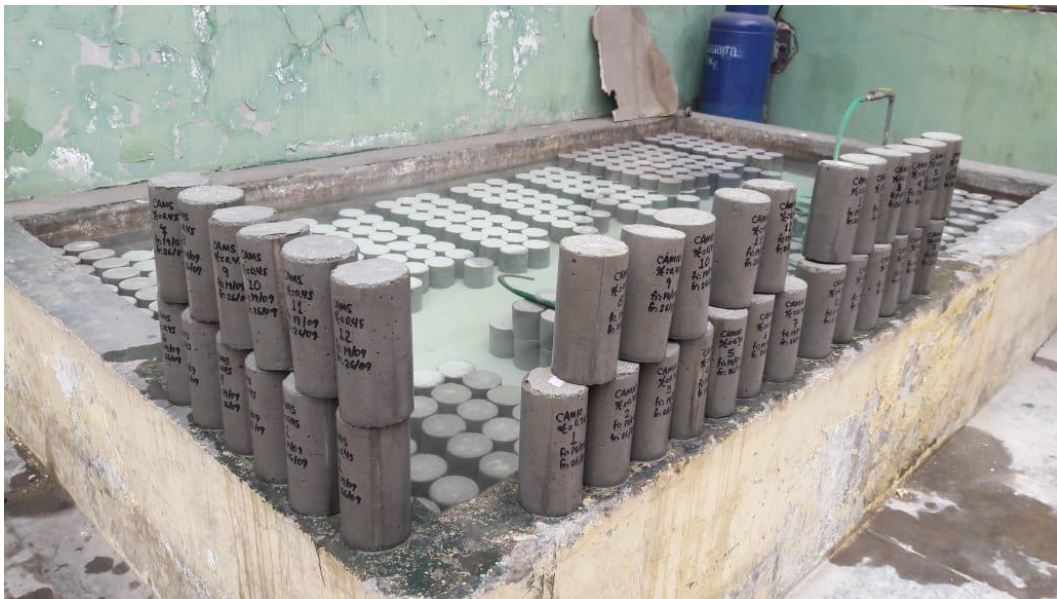
Oreado de probetas de los diseños Concreto con Aditivo más Micromineral al 5% y 10% (CAM5 Y CAM10), horas antes de ser ensayadas a Compresión.
