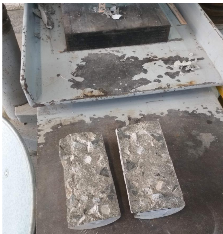
Probeta de 10x20cm después del ensayo de Tracción por compresión diametral.
