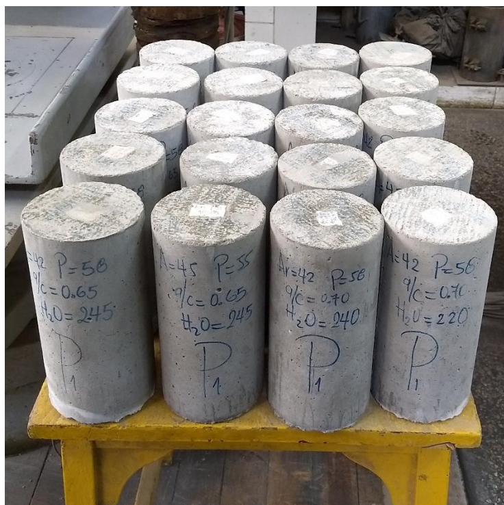
Probetas de 10x20 cm listas para ser ensayadas a compresión a los 7 días.
