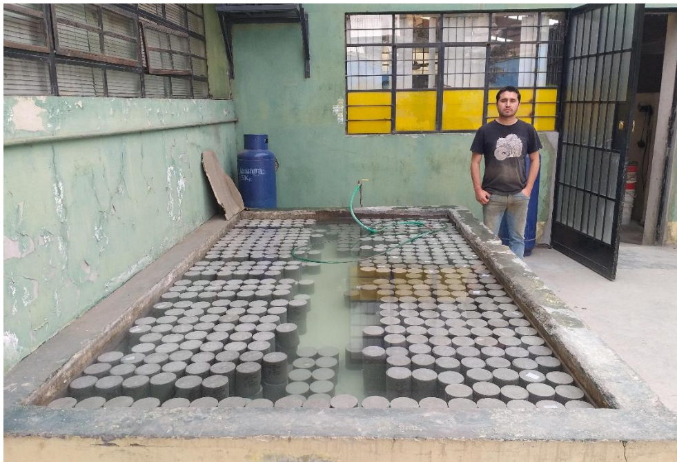
Proceso de curado de probetas de 10x20cm en la etapa de producción masiva para realizar los ensayos de Resistencia a la compresión y Tracción por compresión diametral.
