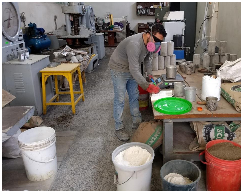
Pesado de las componentes del concreto: Arena, Piedra, agua, cemento, aditivo plastificante y Micromineral SiO 400
