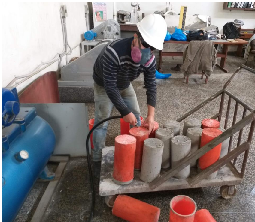
Desenfofrado de probetas de 15x30cm con presión de aire mediante una Compresora
