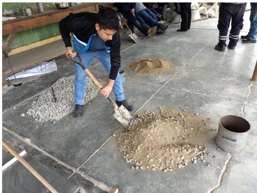
Combinación de agregado grueso y fino para el ensayo de máxima compacidad
