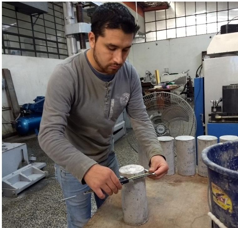
Medición de probetas con vernier digital antes de ser ensayadas a Compresión.
