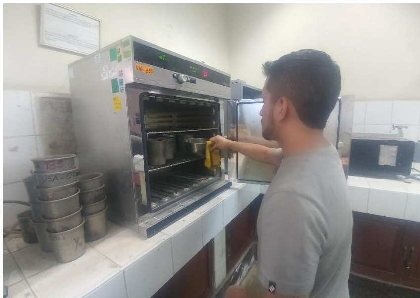
Colocación de muestras de agregado fino y agregado grueso al horno.
