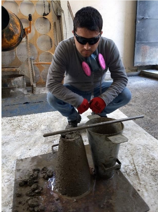
Haciendo el ensayo de consistencia, buscando un slump de 3 a 4 pulgadas
