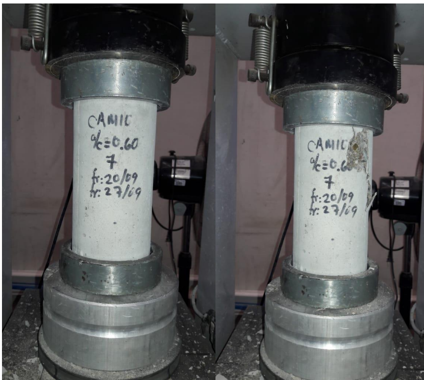
Probeta N°7 de 10x20cm, a/c:0.65 del diseño Concreto con Aditivo más Micromineral al 10% (CAM10) antes y después de ser ensayada a Compresión a la edad de 7 días.
