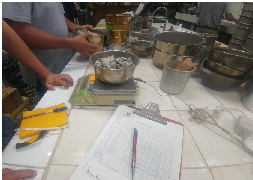
Ensayo de granulometría del agregado grueso.
