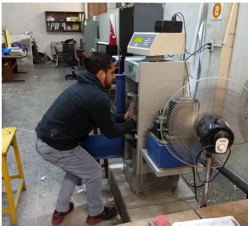
Colocación de probeta en la máquina digital de Compresión, lista para ser ensayada.
