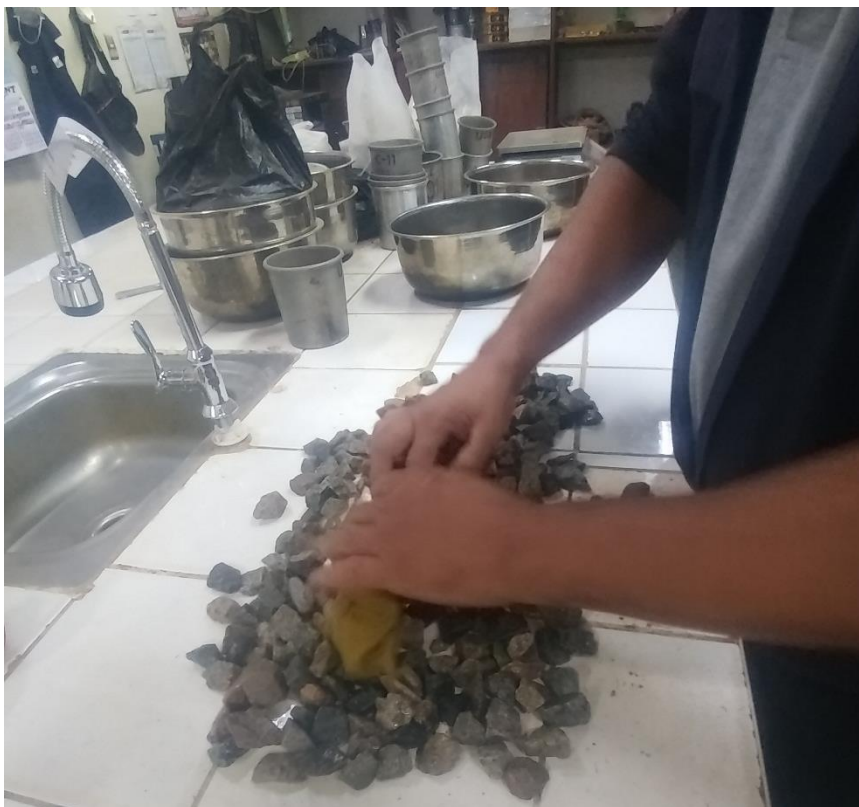
Secando el agregado grueso saturado con franela luego de 24 horas de sumergido bajo el agua para obtener la muestra en condición Saturada Superficialmente Seca
