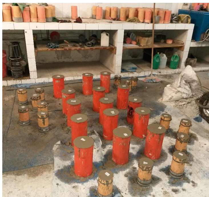
Probetas de 15x30cm y 10x20cm etiquetadas con acabado final, para realizar posteriormente el ensayo de Módulo elástico a la edad de 56 días.
