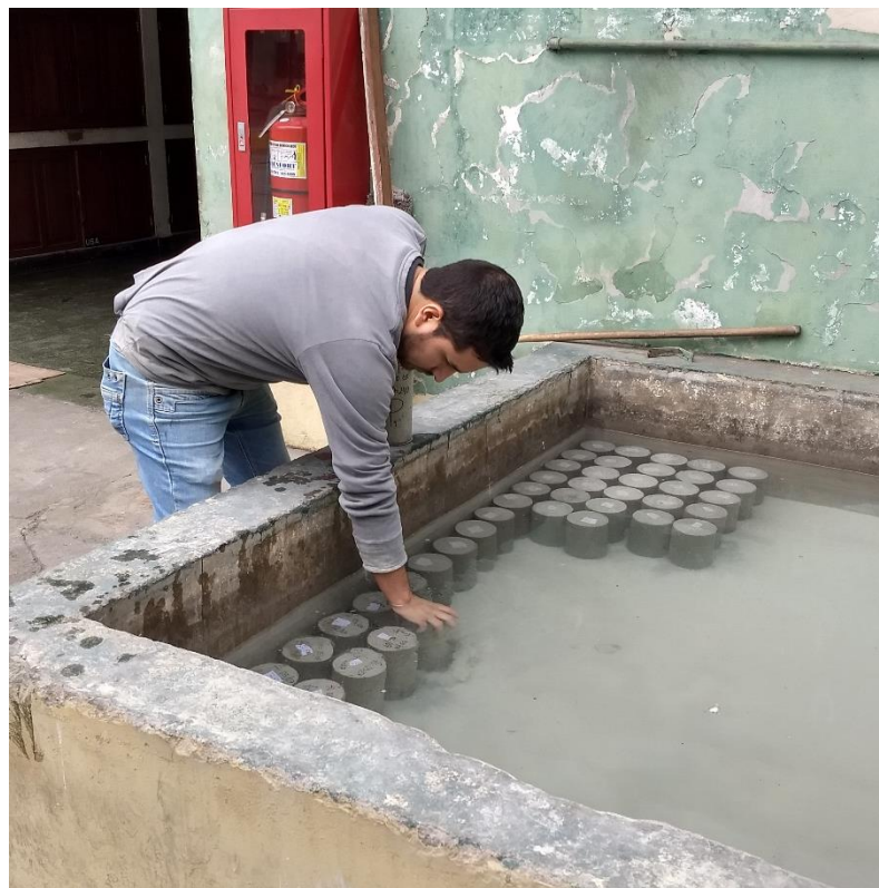
Colocación de las probetas de 10x20 cm en el pozo de curado.
