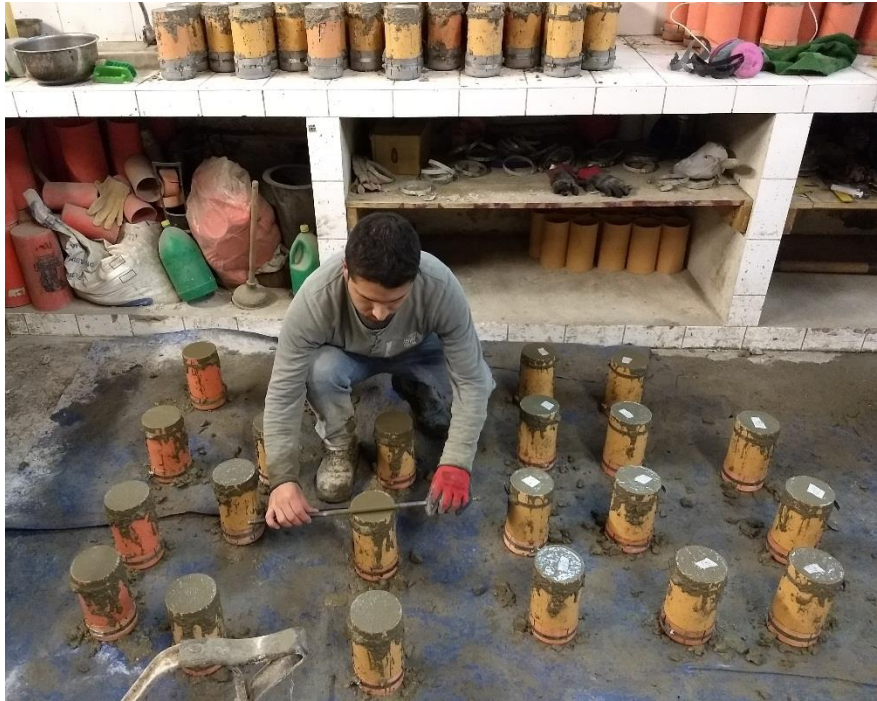
Elaboración masiva de probetas de 10x20cm y realizando su acabado.
