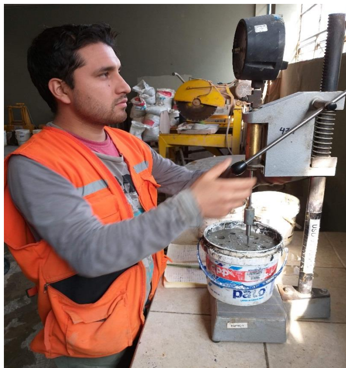
Ensayo de tiempo de fragua mediante la resistencia a la penetración del mortero que resulta luego de tamizar el concreto por la malla N°4.
