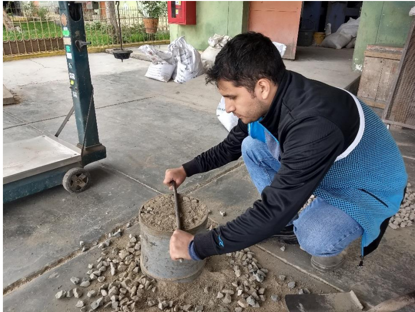
Enrasado del agregado global con 45% de arena y 55% de piedra
