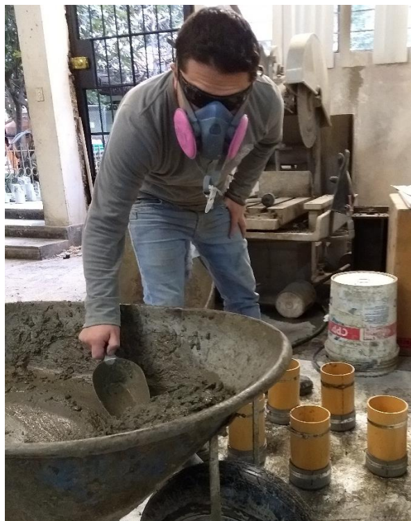
Preparación de probetas de 10x20 cm para determinar la combinación óptima de agregados
