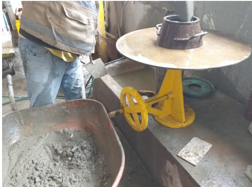
Ensayo de fluidez en la mesa de sacudidas.
