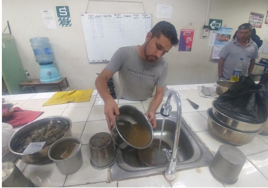
Lavado del agregado fino pasando la malla N°200
