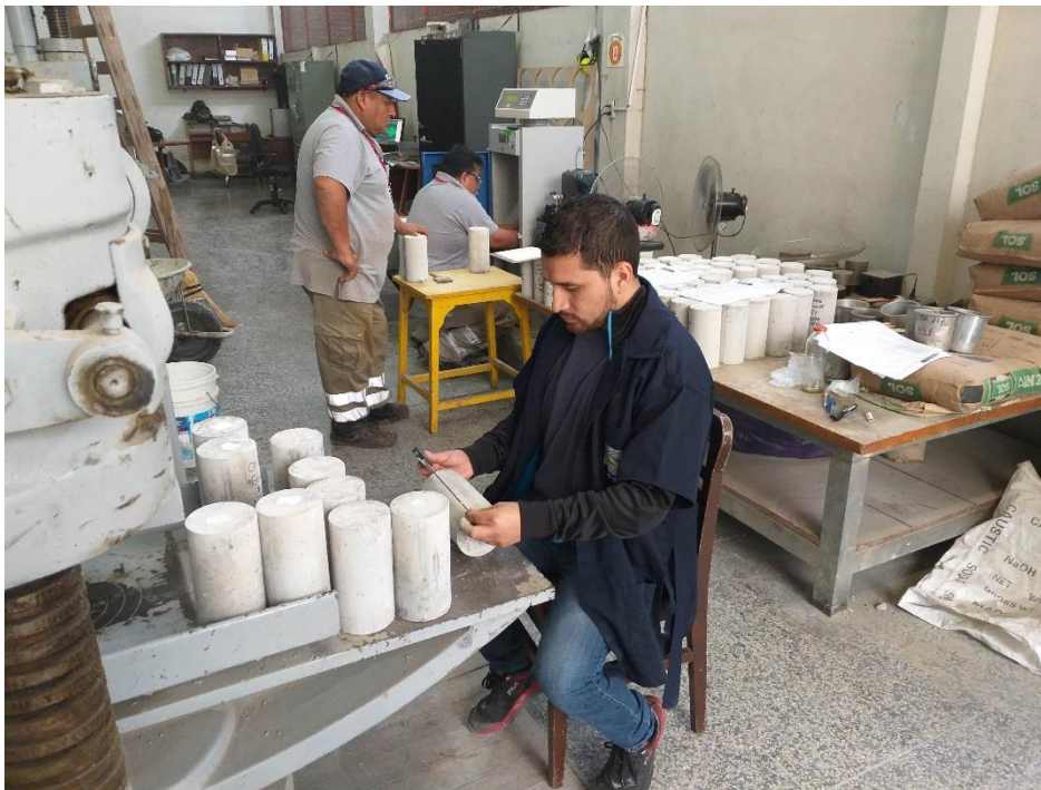
Medición de probetas con vernier digital previo al ensayo de Resistencia a la compresión.
