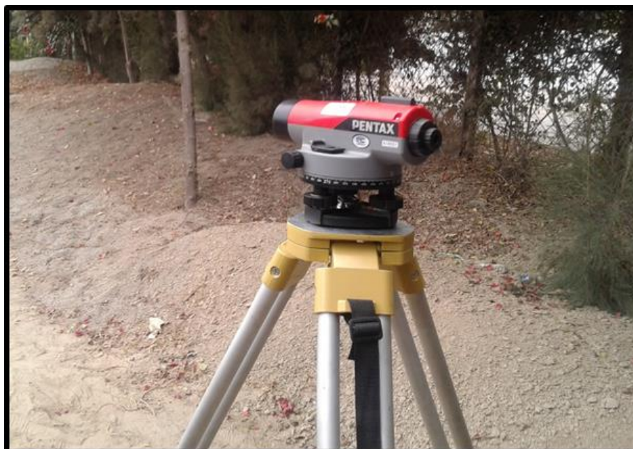
Foto N° 26 Nivel de ingeniero PENTAX modelo AFL-321.
