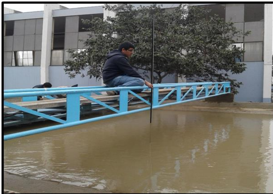
Foto N° 25 Uso de la mira limnimétrica para medir el nivel de agua
