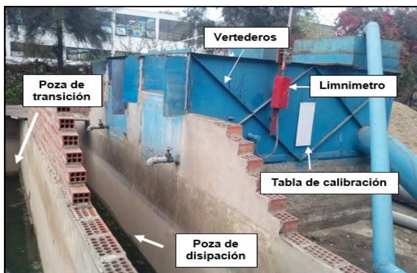
Foto N° 15 Ingreso del modelo hidráulico con vertederos rectangulares.
