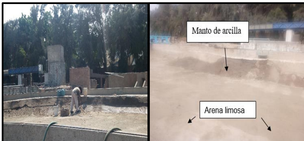
Foto N° 19 Lecho móvil a escala modelo con presencia de arena limosa en fondo y manto arcilloso en la ribera.
