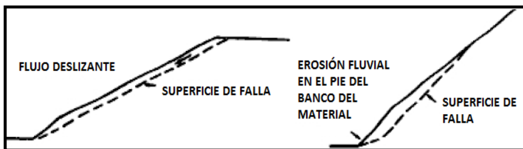
Figura N° 7 Tipos de erosión en riberas de material no cohesivo.
