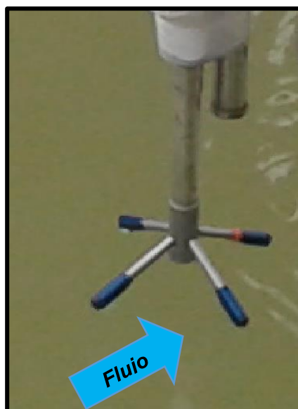
Foto N° 44 Posición correcta del vectrino para medir velocidades.
