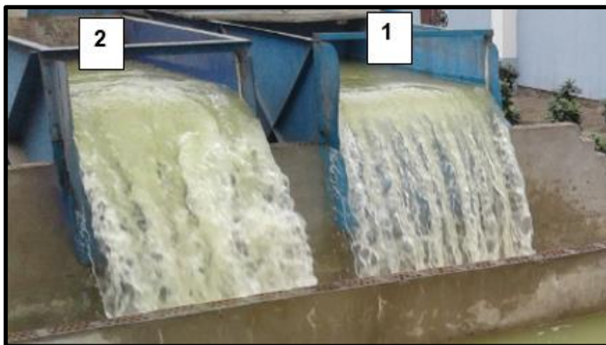
Foto N° 27 Descarga de agua sobre los dos vertederos rectangulares de ingreso al modelo.
