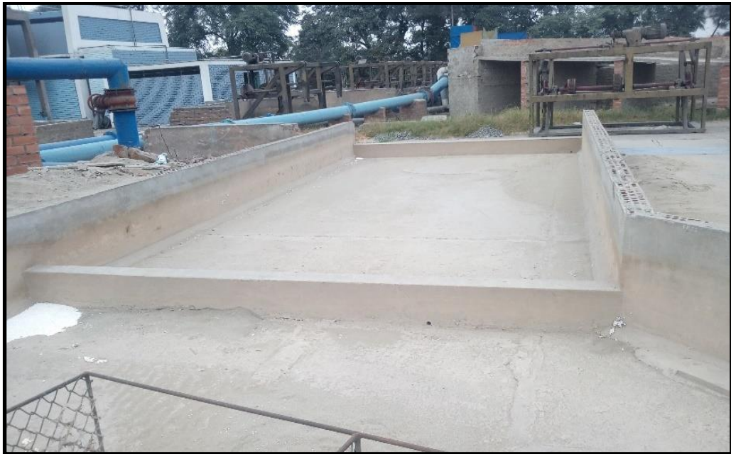
Foto N° 16 Salida del modelo hidráulico con la poza de sedimentación.
