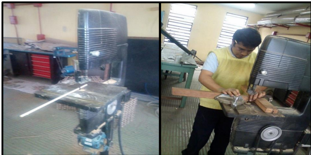
Foto N° 34 Colocación del tronco en la sierra de banda (lado izquierdo) y corte de troncos para diferentes longitudes (lado derecho).
