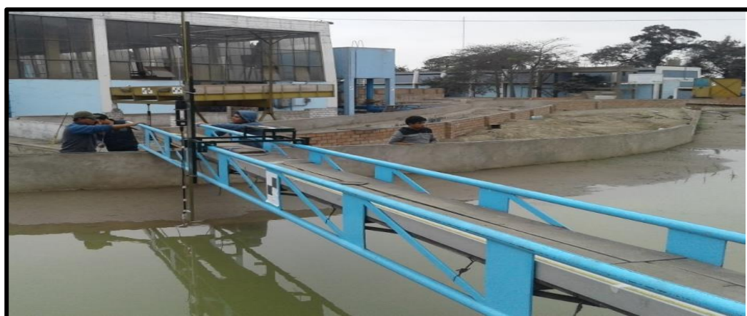
Foto N° 29 Soporte (puente metálico) para la medición de velocidades de flujo en cada sección transversal.
