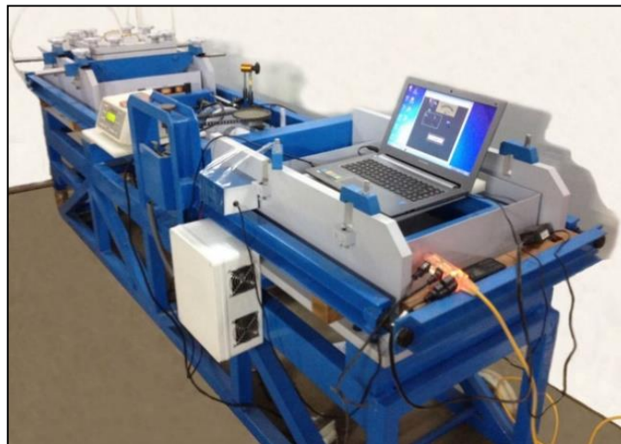
Figura 4.5 Equipo para ensayos de corte directo a gran escala con geosintéticos Fuente: Laboratorio Geotécnico de Anddes.
