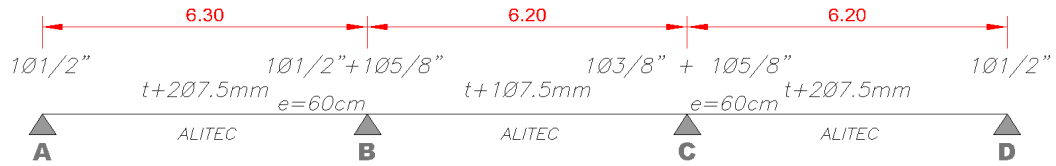
Figura N°5.29 Esquema en el Sentido de las viguetas Alitec con sus Aceros de Refuerzo y Ensanches.
