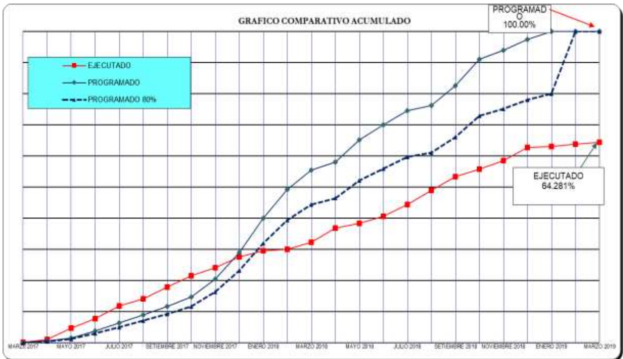
Figura N° 05: Curva “S” Comparativo Acumulado del Avance Programado y Ejecutado
