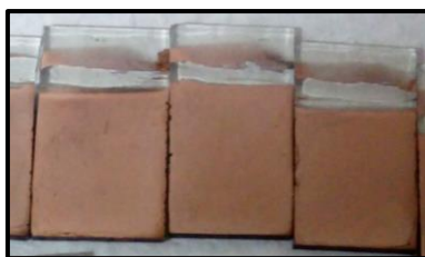
Fig. 30. Películas de \text{Cu}^\circ electrodepositadas sobre vidrio FTO.
