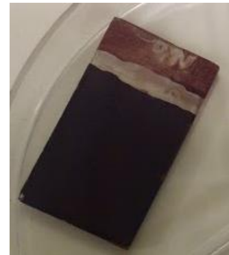
Fig. 61. Película de Cu 2 O sintetizadas por baño químico sobre la película de Cu 0 /Bi 2 Se 3 /Cu 2 O.
