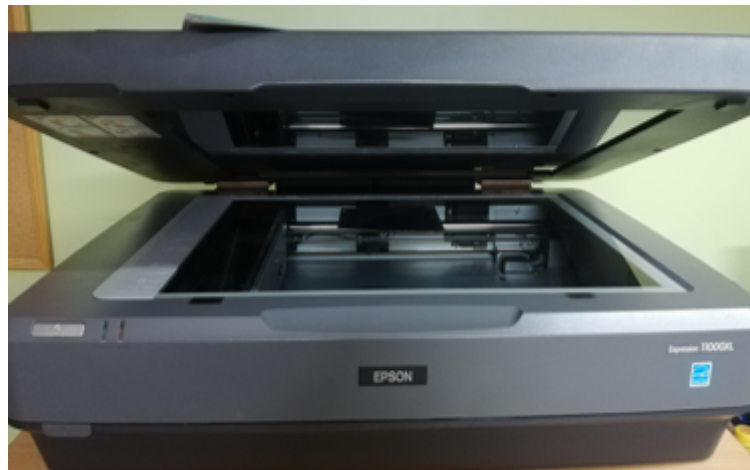
Figura 3.2: Escáner epon 11000XL empleada para realizar el escaneo de las películas radiocrómicas.
