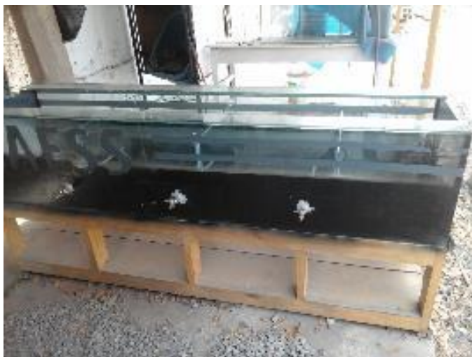
Fig.3: En la imagen se puede observar los 03 puntos de muestreo para cada compartimento del módulo de vidrio.
