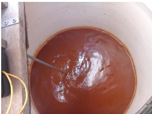
Fig. 12: Se observa la muestra en movimiento constante a 40 RPM consistente en la mezcla de reactivos en el tanque de almacenamiento.
