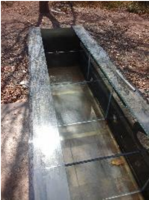
Fig.4: Módulo de vidrio de 8.00 mm de espesor con 03 pantallas de separación de 36.00, 34.00 y 32.00 cm, de altura, desde el ingreso de la muestra al humedal, hasta la salida respectivamente.
