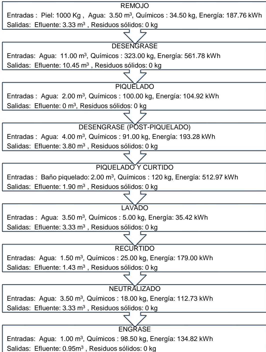
Figura 22. Entradas y salidas de la técnica de cutidos con compuestos fenólicos optimizada
