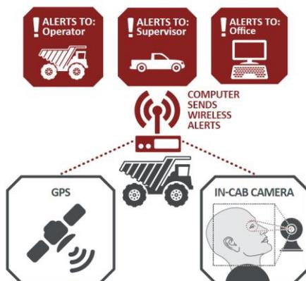
*Figura 4, 2 Esquema de la operatividad del sistema Guardvant.*
