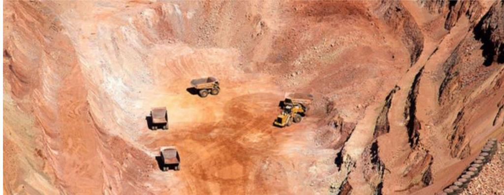
*Figura A2, 2 Carguío de camiones con un cargador frontal.
