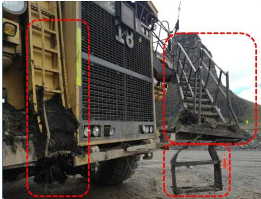
*Figura A1, 7 Daños ocasionados a la escalera del camión.
