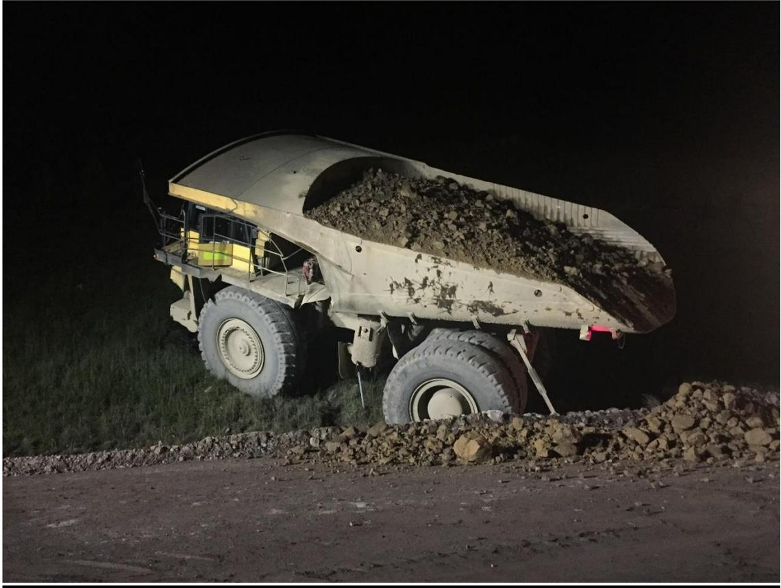
*Figura A1, 8 Posición final del camión minero, fuera de la vía.
