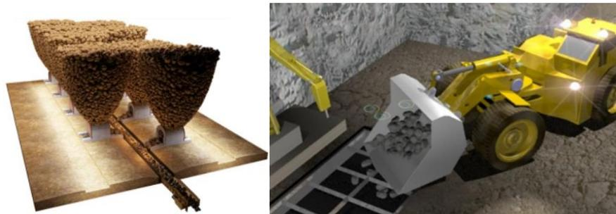
En el nivel de producción, el mineral que cae después de la voladura es retirado con maquinaria como scooptram y transportado a la cámara de acumulación donde se realiza el carguío de mineral con scooptram a volquete para el transporte de mineral a cancha de acumulación en superficie y al dumper para el traslado y descarga del mineral al echadero o estación de descarga).
