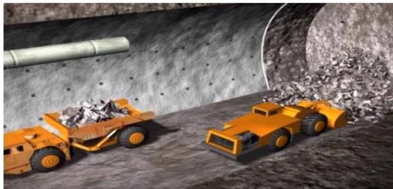
Para controlar los derrumbes es fundamental realizar el sostenimiento, este varía según la estructura geomecánica del yacimiento; la empresa minera evaluada realiza el sostenimiento antes de la voladura mediante el lanzamiento de shotcrete (mezcla de concreto) con el robot y/o sostenimiento con split set o perno hydrabolt con bolter y/o sostenimiento con split set o hydrabolt y malla electrosoldada con bolter, sostenimiento con cimbras y/o sostenimiento con cuadros de madera.
