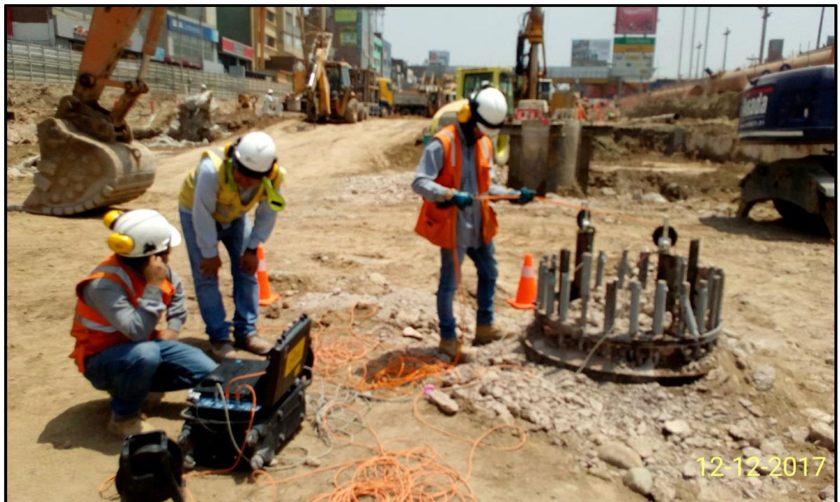
Figura 2.7: Tubos sónicos para ensayo Cross hole
