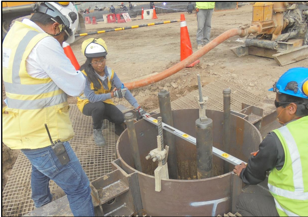
Figura 2.6: Tubos sónicos para ensayo Cross hole
