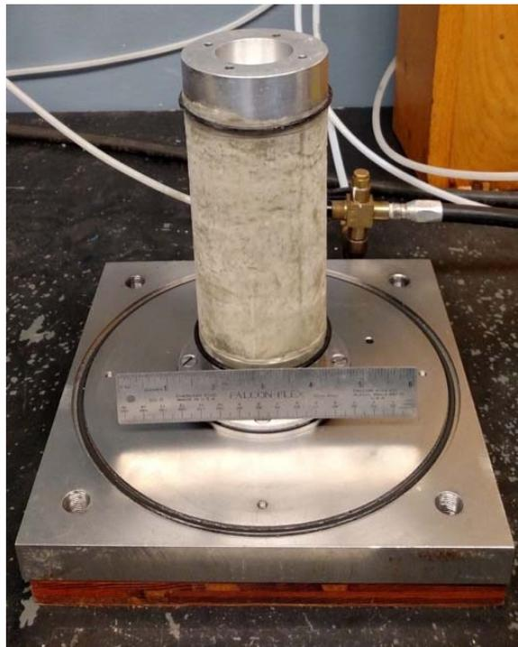
Figura N°3.7 Especimen SRK-01 durante el ensayo RCTS
