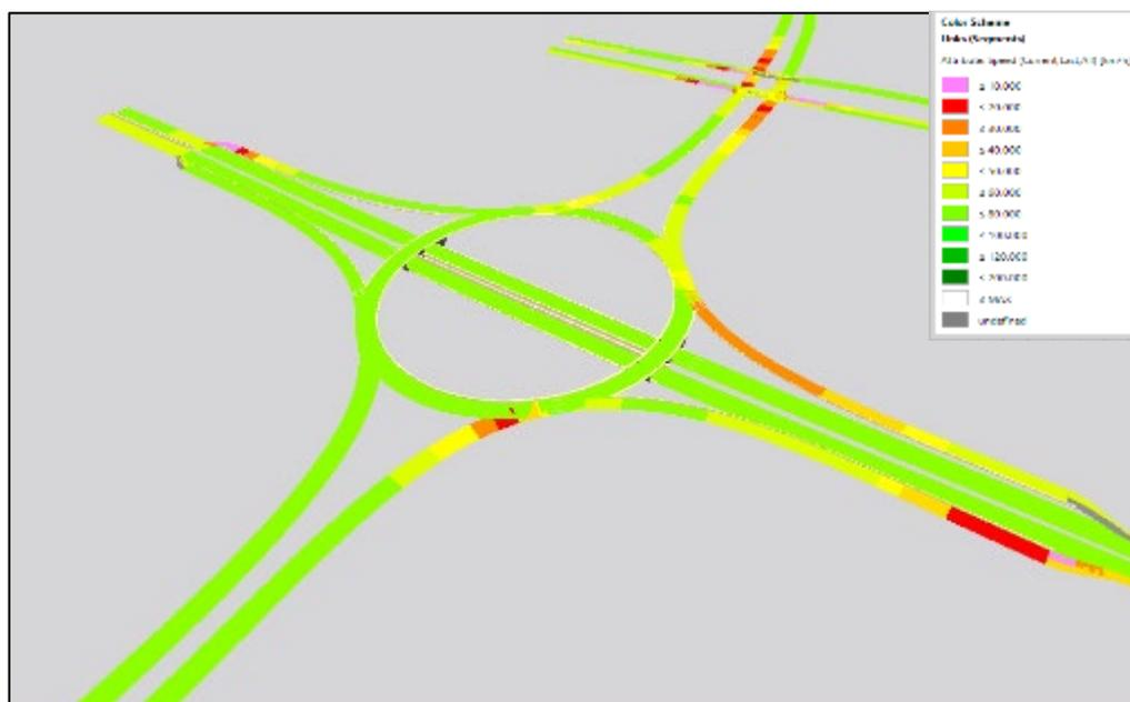
Figura N° 154 Diagrama de velocidades del intercambio vial a desnivel visto en 3D.
