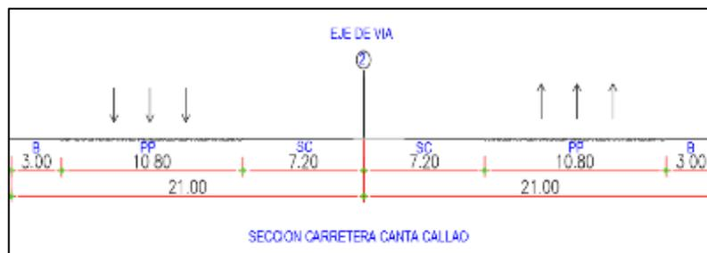
Figura N° 21 Sección transversal de la carretera Canta-Callao.
