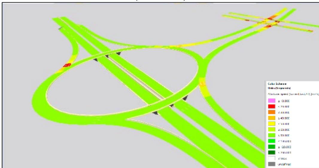
Figura N° 147 Diagrama de velocidades del intercambio vial a desnivel en vista 3D.
