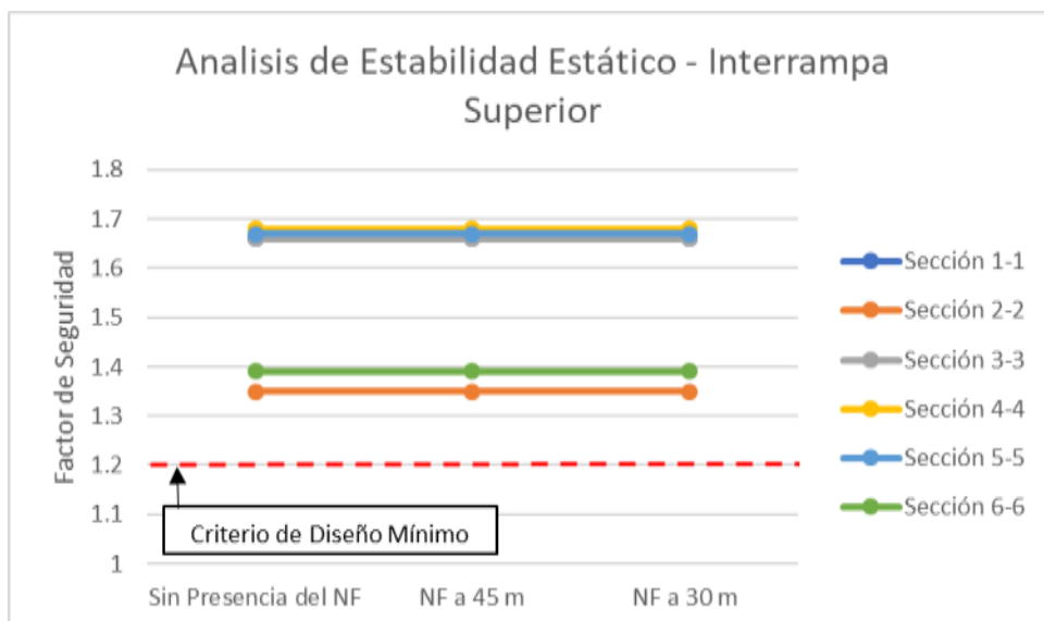
Figura 5.5. Variabilidad de los Factores de Seguridad para Análisis Interrampa Superior en función a los Niveles Freáticos para el Caso de Aplicación (Fuente: Elaboración Propia).
