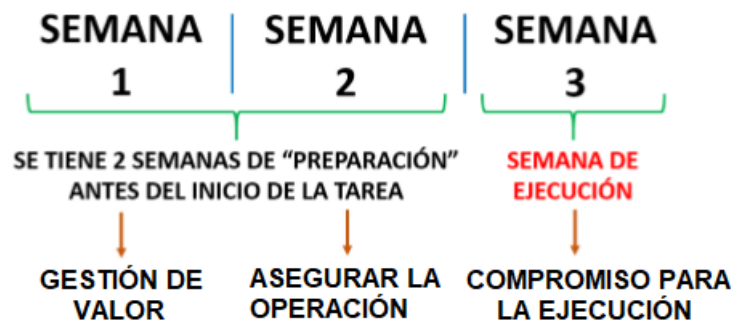
Figura N°2.15: Etapa de progreso de tres semanas Fuente: Adaptado de Gamarra G. (2008)
