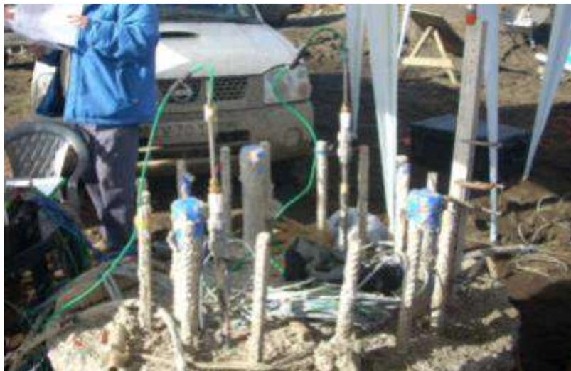
Figura 3 – Cabeza del pilote de prueba con instrumentación y cableado.
