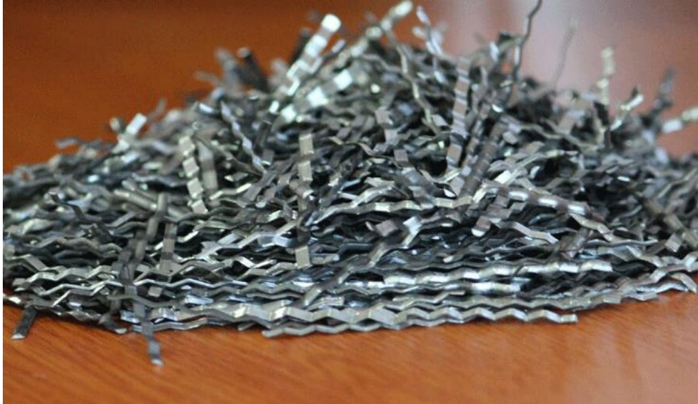
Fig. N° 3.10: Fibras metálicas para concreto
