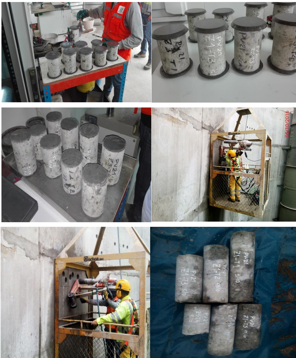
Fig. N°4.1 Ejecución de extracción testigos de concreto para pruebas de compresión, en la zona observada por el Reporte de No Conformidad.
