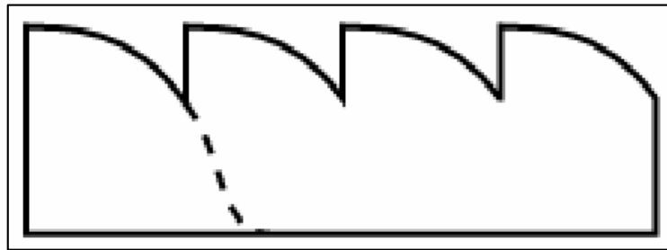
Figura N°9 Esquema del ciclo de conservación vial preventiva
