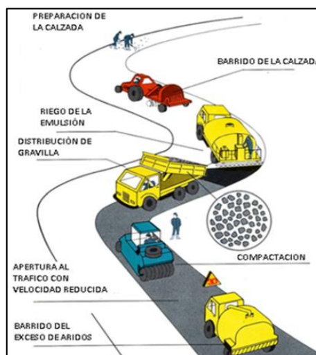
Figura N°51 Esquema de colocación de tratamiento superficial Monocapa
