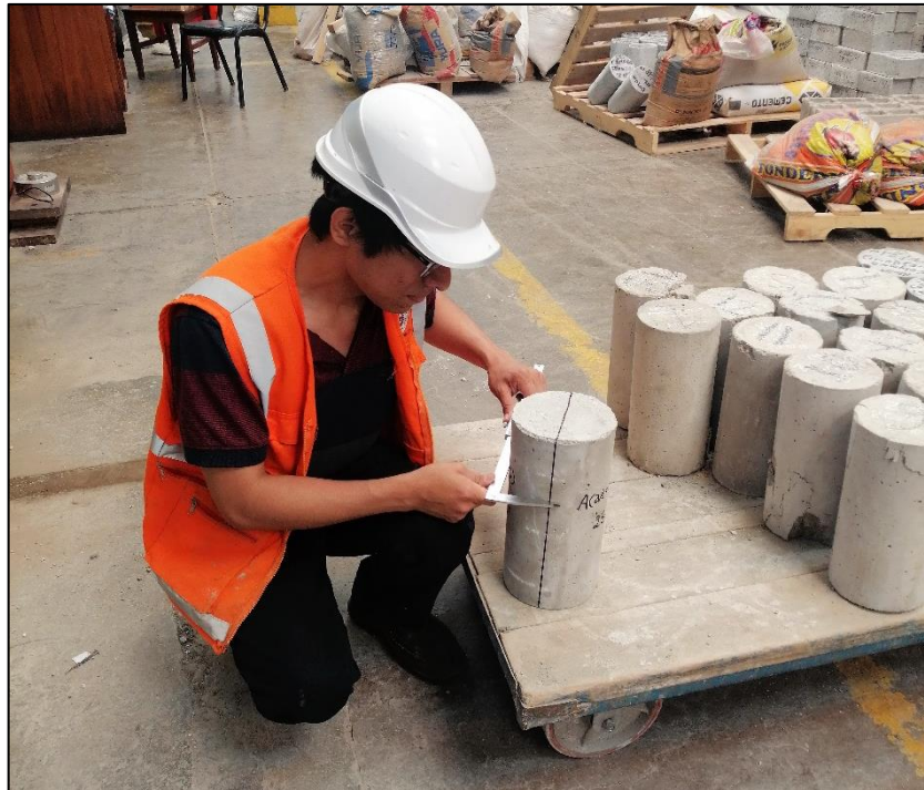
ANEXO 2. 13.- Medición de una probeta de 15x30 cm para el ensayo de tracción indirecta.
