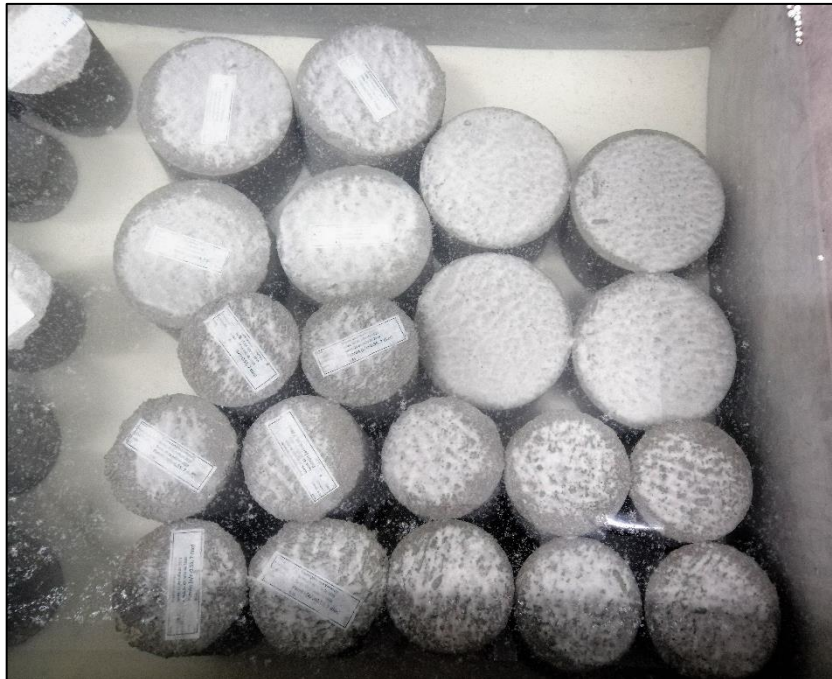
ANEXO 2. 11.- Curado de probetas en la poza de curado saturada con Cal.
