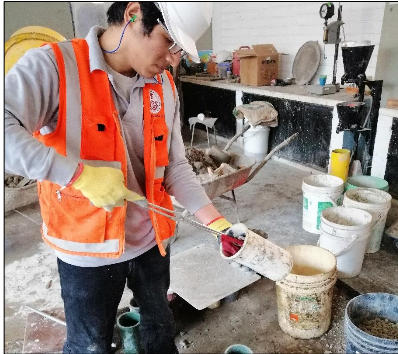
ANEXO 2. 5.- Aplicación de desmoldante en el molde de probeta de 10x20 cm.
