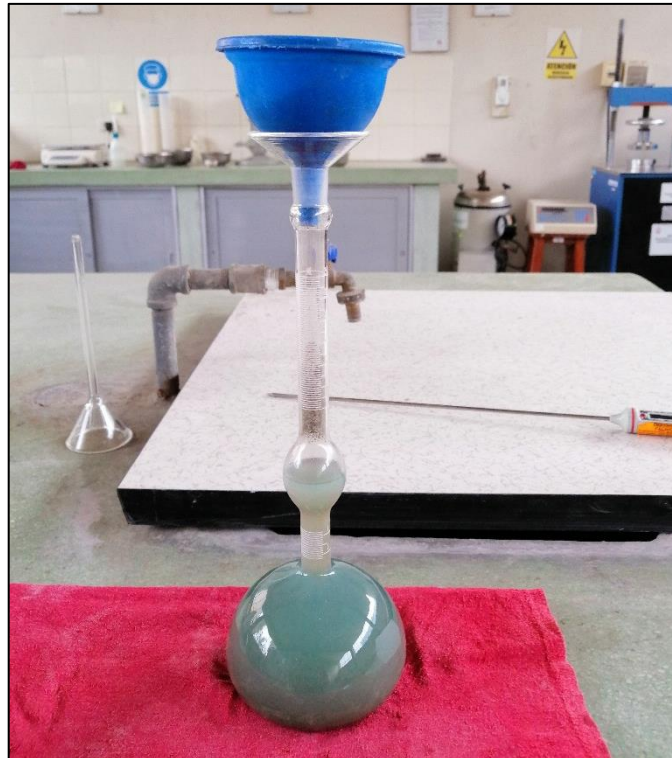
ANEXO 2. 1.- Proceso del ensayo de densidad del cemento "Sol" Portland tipo I en el frasco de Le Chatelier.
