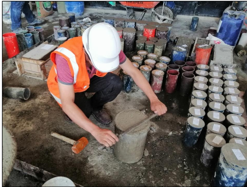
ANEXO 2. 9.- Enrasado de la mezcla en el recipiente de 1/3 \text{ pie}^3 para el ensayo de peso unitario del concreto fresco.
