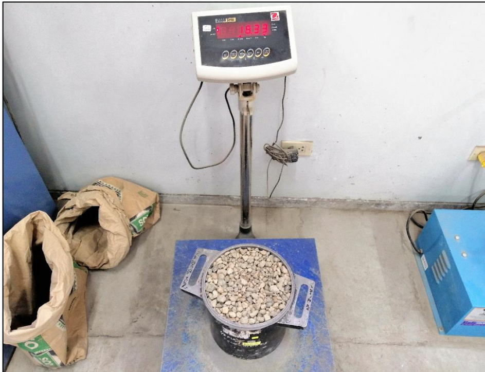
ANEXO 2. 3.- Proceso del ensayo de peso unitario compactado del agregado grueso.
