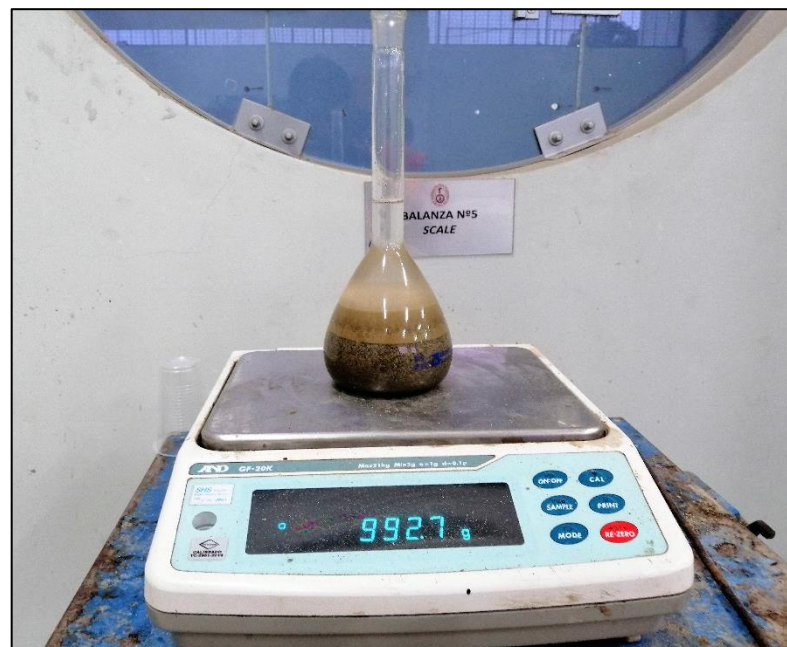
ANEXO 2. 2.- Peso de la fiola con agua y arena para el ensayo de peso específico y absorción del agregado fino.
