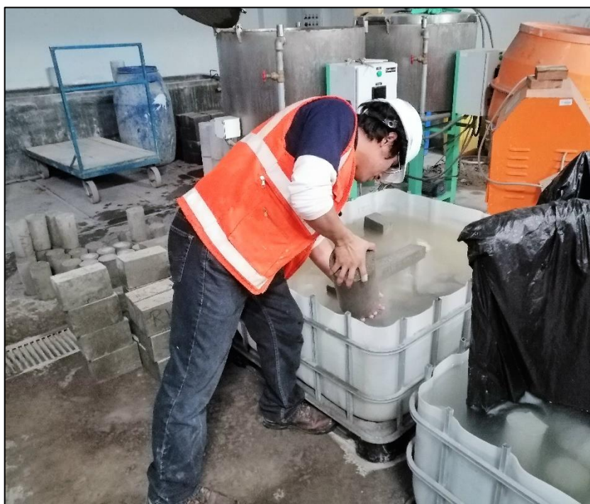
ANEXO 2. 12.- Colocación de probetas de 15x30 cm en la poza de curado saturada con Cal.
