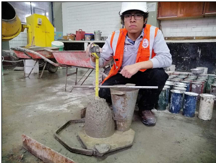
ANEXO 2. 8.- Resultado del ensayo de asentamiento "Slump" del concreto, 3 ½".
