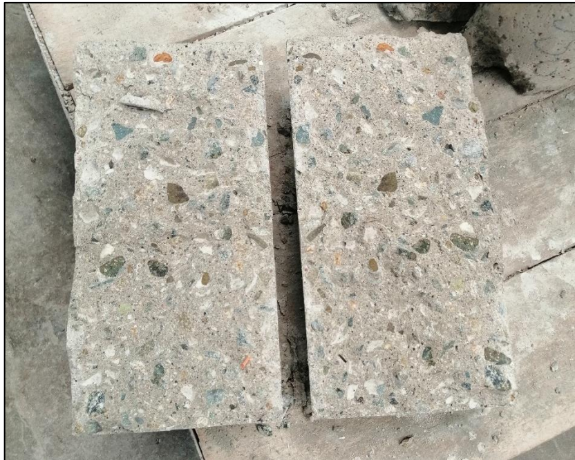
ANEXO 2. 15.- Probeta luego del ensayo de tracción indirecta.
