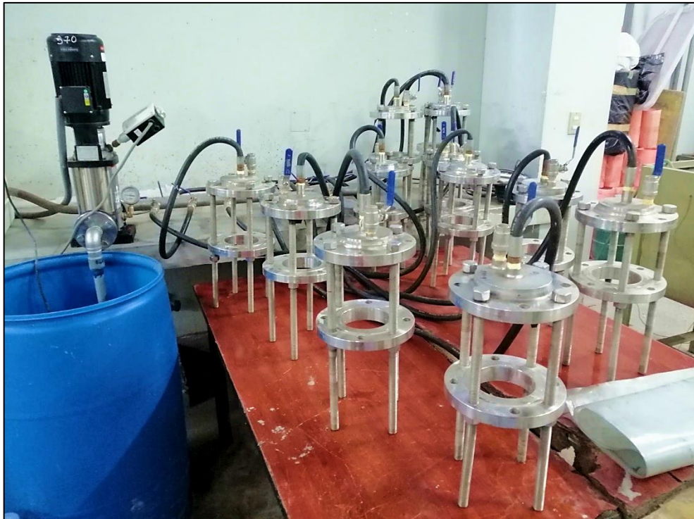
Figura 12 Celdas de acero con sus respectivas mangueras y válvulas de escape
