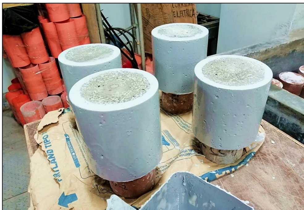
Figura 14 Probetas pintadas con epóxico
