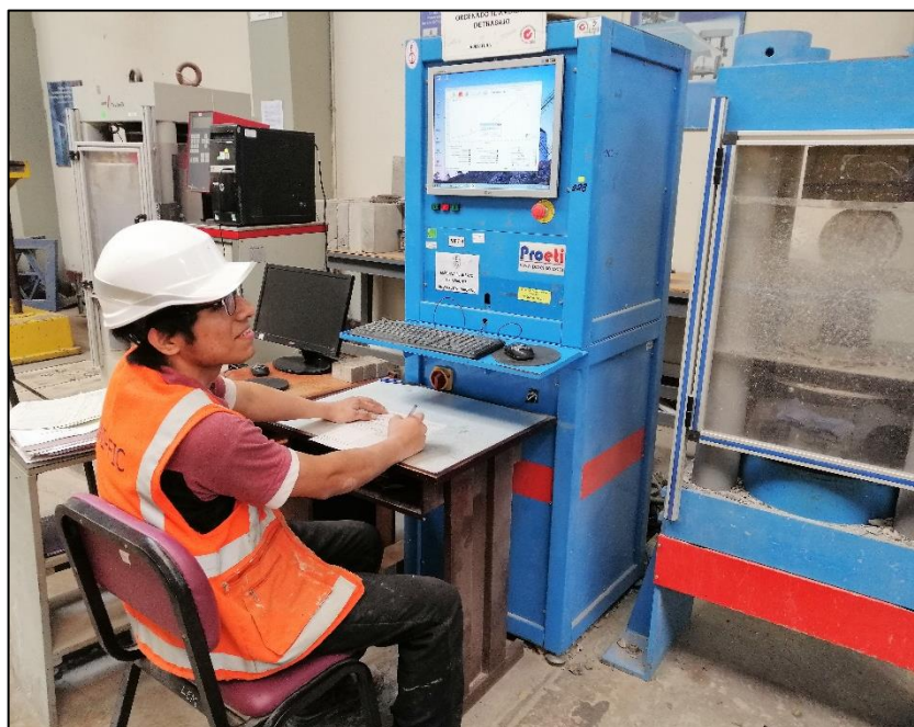
ANEXO 2. 14.- Aplicación de carga para el ensayo de tracción indirecta en la máquina "Proeti".
