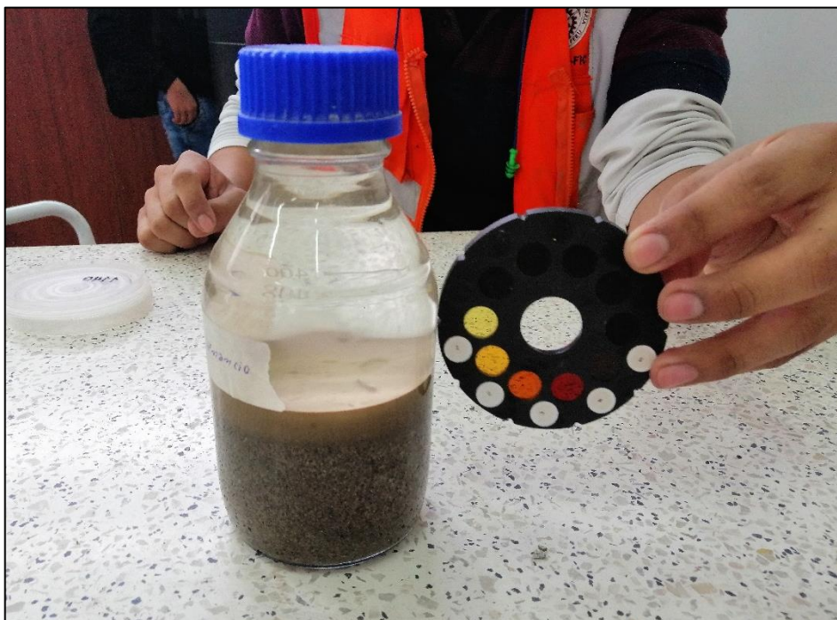
ANEXO 2. 4.- Comparación colorimétrica con el patrón Gardner para el ensayo de impurezas orgánicas.
