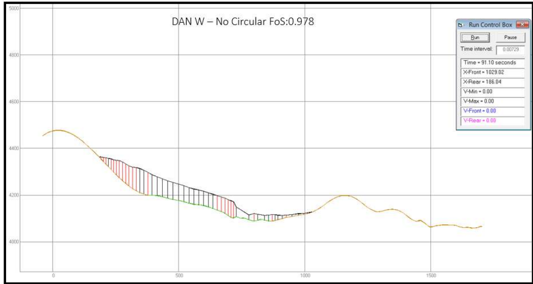
Figura 17.- Se realizo el análisis del flujo del material para las diferentes secciones, de los resultados obtenidos se incrementó la altura de las bermas de impacto de 10 a 15 m. (TSE 6 para el caso de la sección el incremento de berma fue de 10m).
