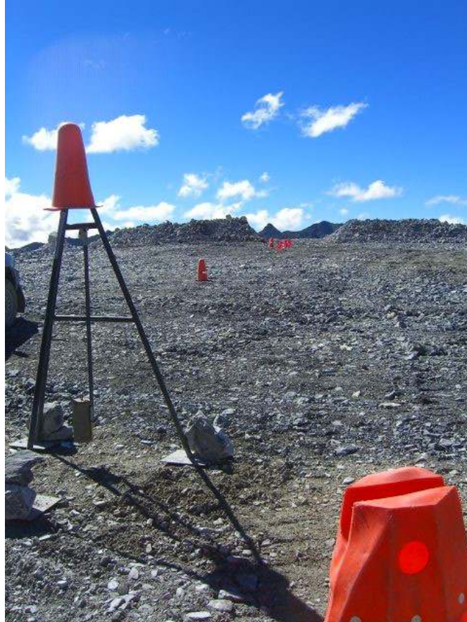
Figura 6.12 Extensómetro manual. Fuente (Cia. Minera Antamina CMA)
