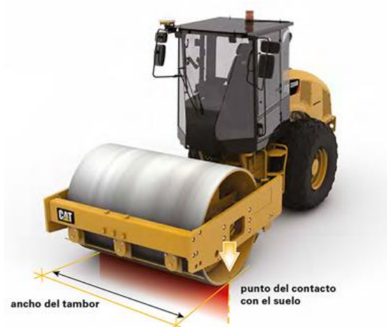
Figura 2.26. Carga lineal estática de un rodillo compactador.
