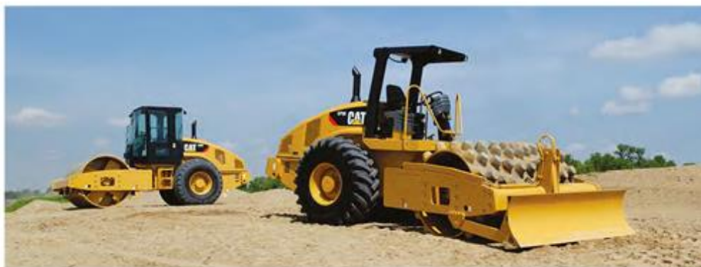
Figura 2.22. Rodillos de tambor liso (izquierda) y tambor con pisones (derecha). Fuente: Caterpillar (2013)
