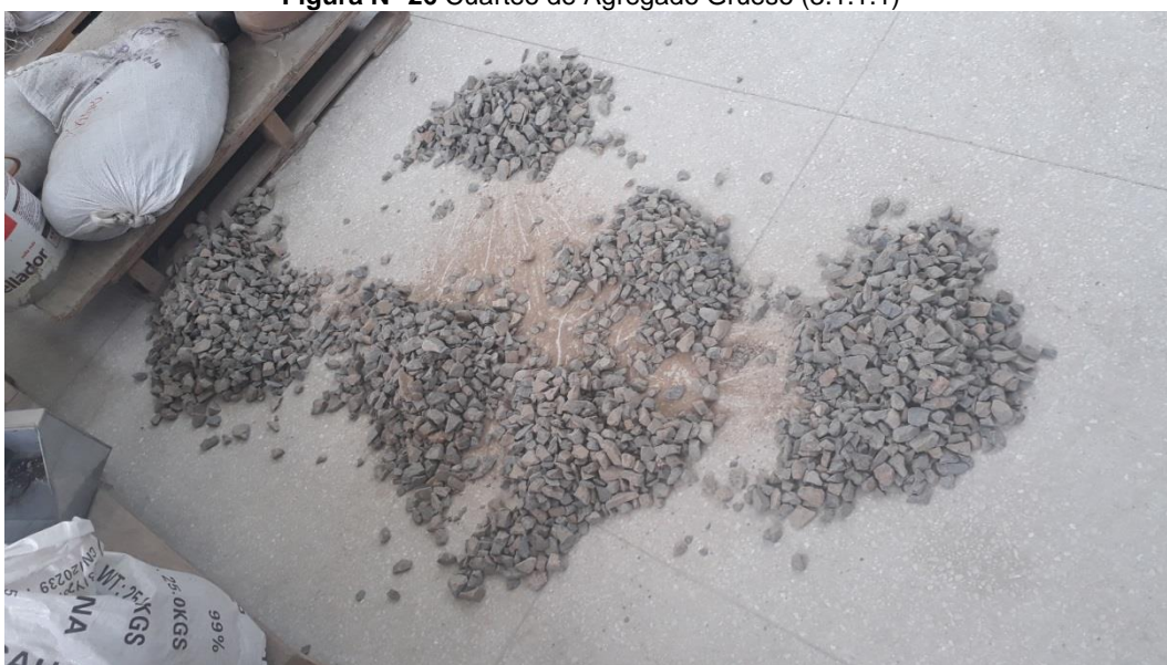
Figura N° 26 Cuarteo de Agregado Grueso (3.1.1.1)
