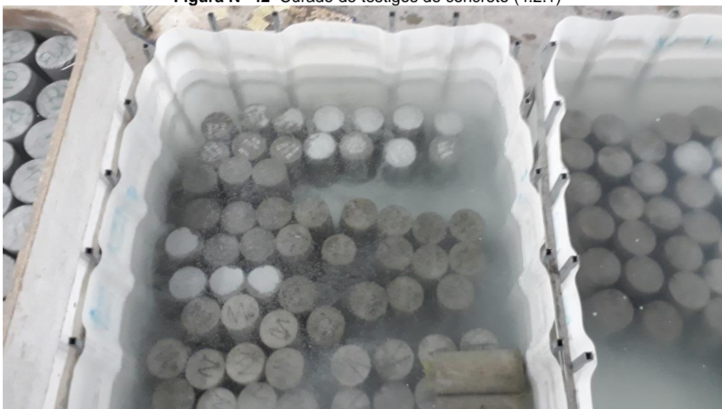
Figura N° 42 Curado de testigos de concreto (4.2.1)
