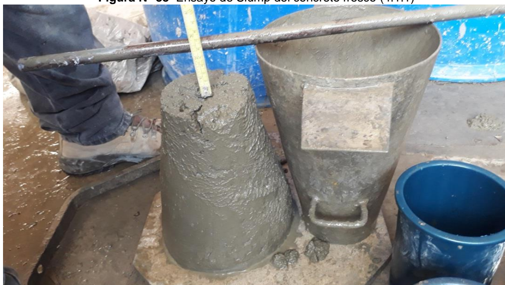
Figura N° 38 Ensayo de Slump del concreto fresco (4.1.1)
