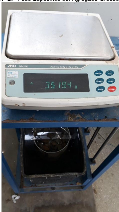
Figura N° 27 Peso Específico del Agregado Grueso (3.1.1.5)
