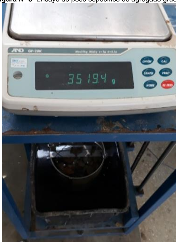
Figura N° 3 Ensayo de peso específico de agregado grueso.
