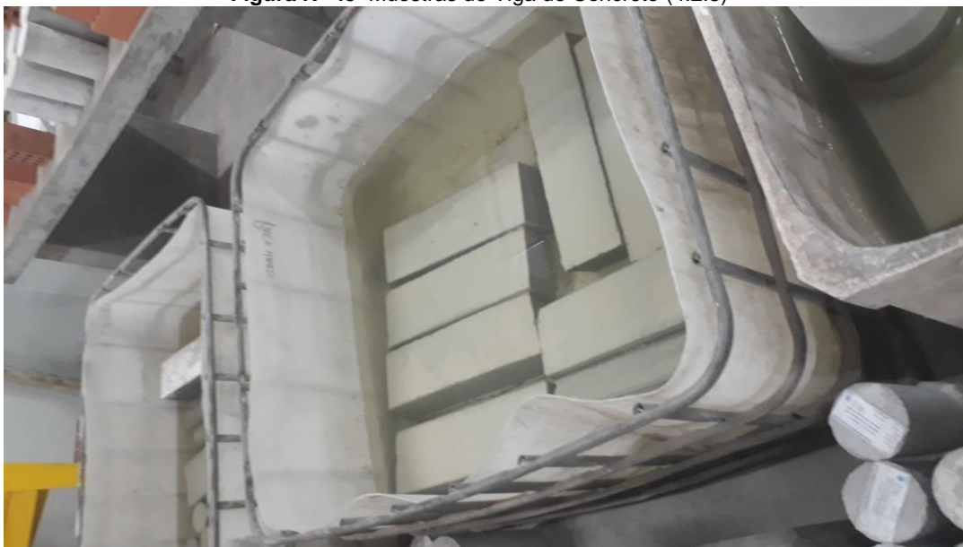
Figura N° 45 Muestras de Viga de Concreto (4.2.3)
