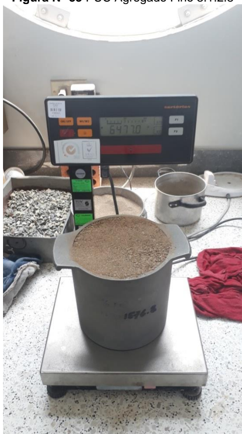
Figura N° 33 PUC Agregado Fino 3.1.2.8
