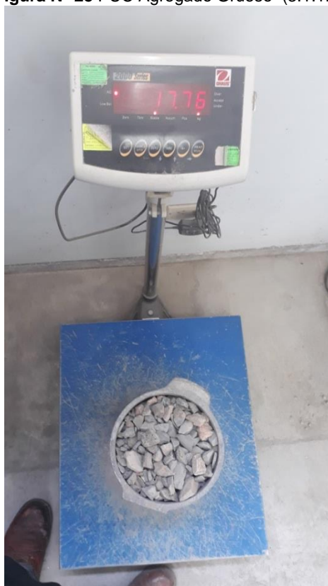
Figura N° 28 PUC Agregado Grueso (3.1.1.8)
