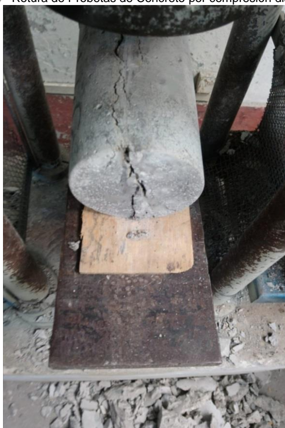
Figura N° 44 Rotura de Probetas de Concreto por compresión diametral (4.2.2)
