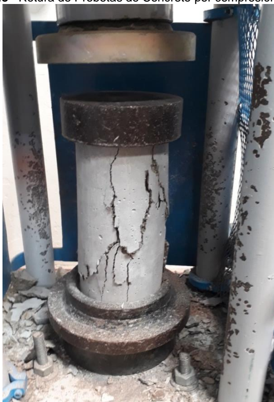
Figura N° 44 Rotura de Probetas de Concreto por compresión diametral (4.2.2)
