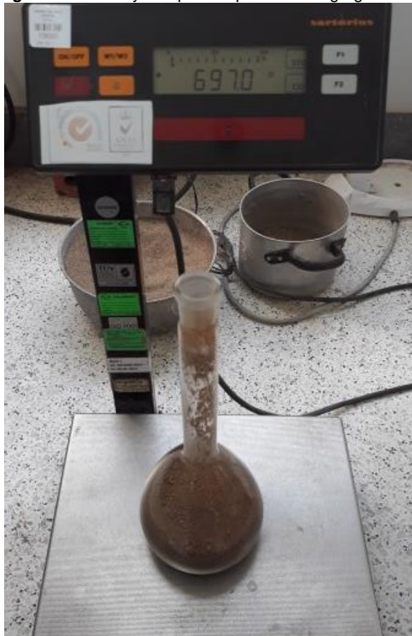
Figura N° 5 Ensayo de peso específico de agregado fino.
