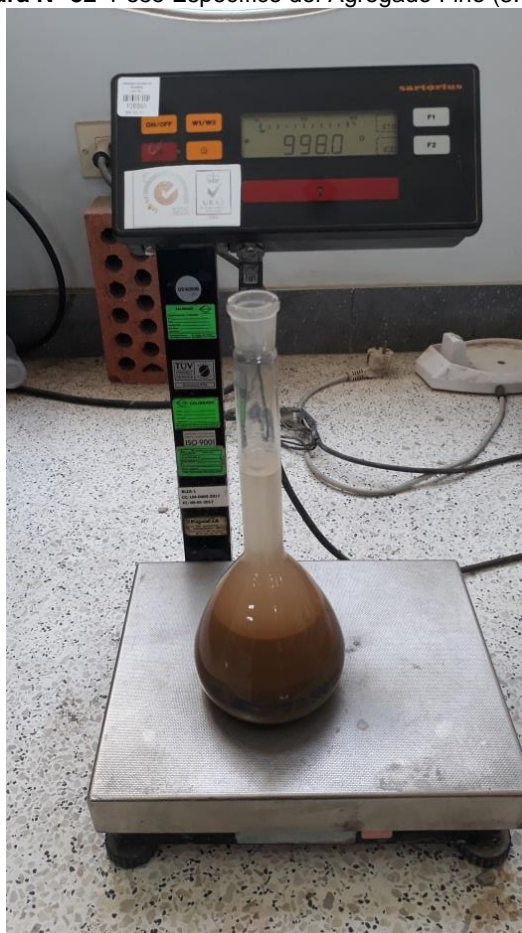
Figura N° 32 Peso Específico del Agregado Fino (3.1.2.5)
