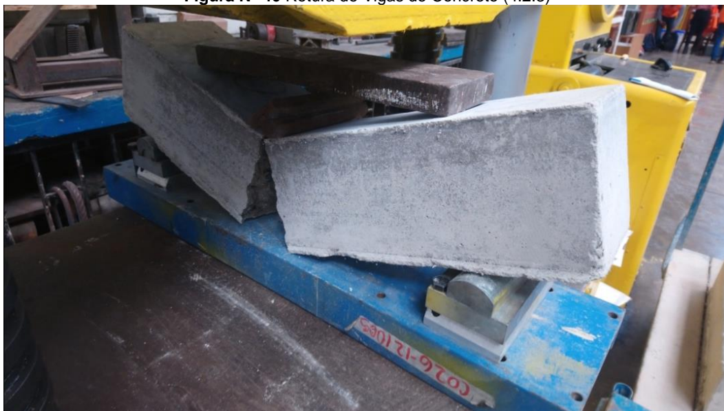
Figura N° 46 Rotura de Vigas de Concreto (4.2.3)
