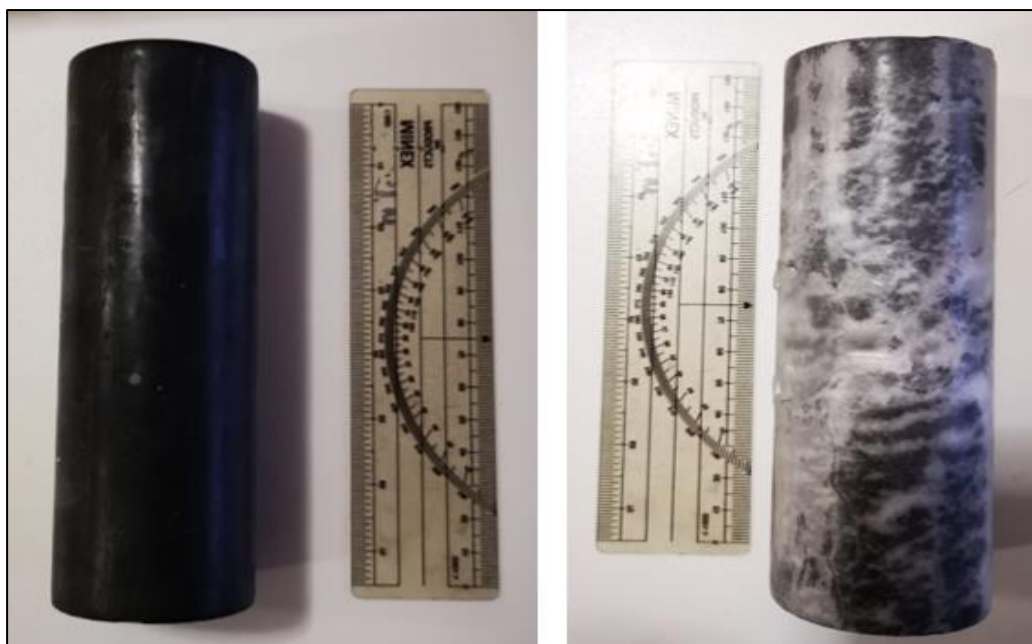
Figura 5,7 Muestras representativas del método de inmersión en cera.
