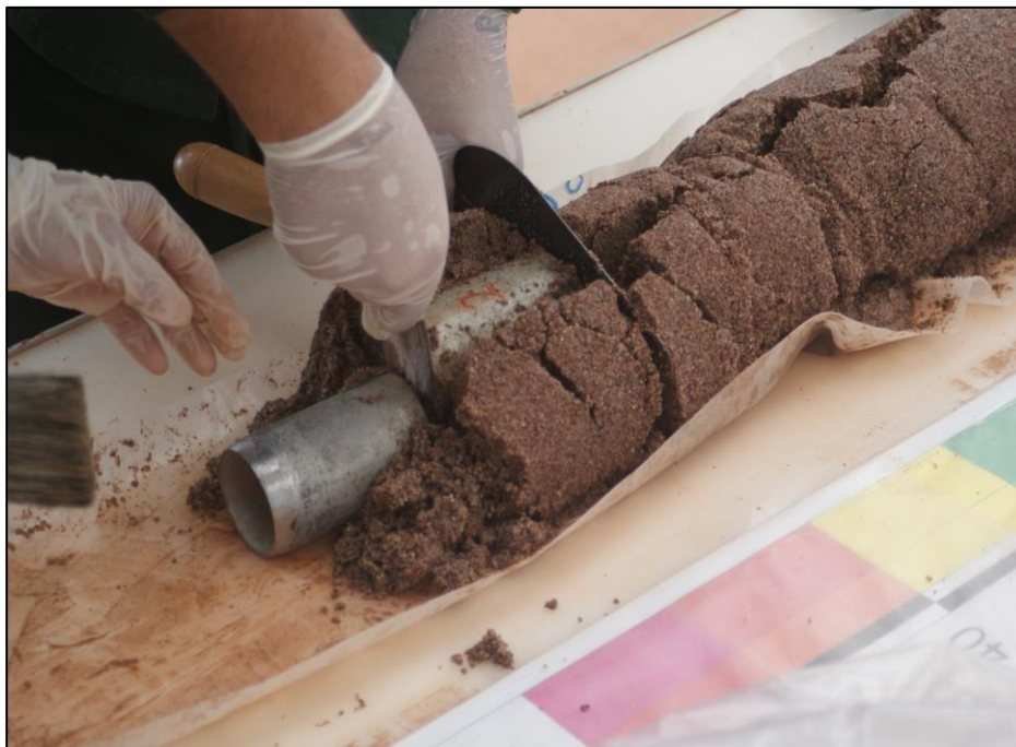
Figura 2,5 Extracción de muestra por método del tubo de pared fina.
