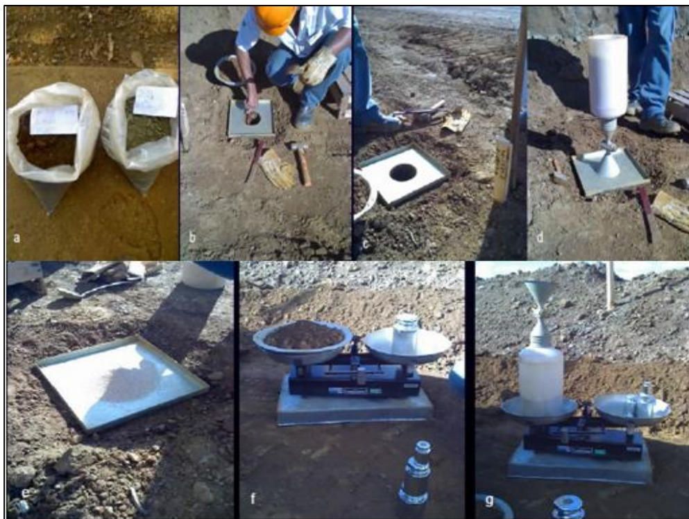
Figura 2,6 Procedimiento para determinar la densidad in situ.
