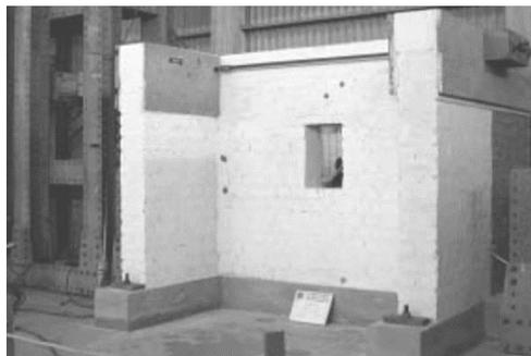
Figura 3.5: Muro de adobe con ventadas ensayado bajo carga Cíclica (Blondet et al. 2005).
