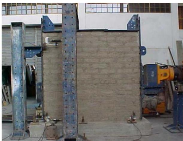
Figura 3.3: Muro de adobe ensayado bajo carga monotónica (Igarashi, 2009).
