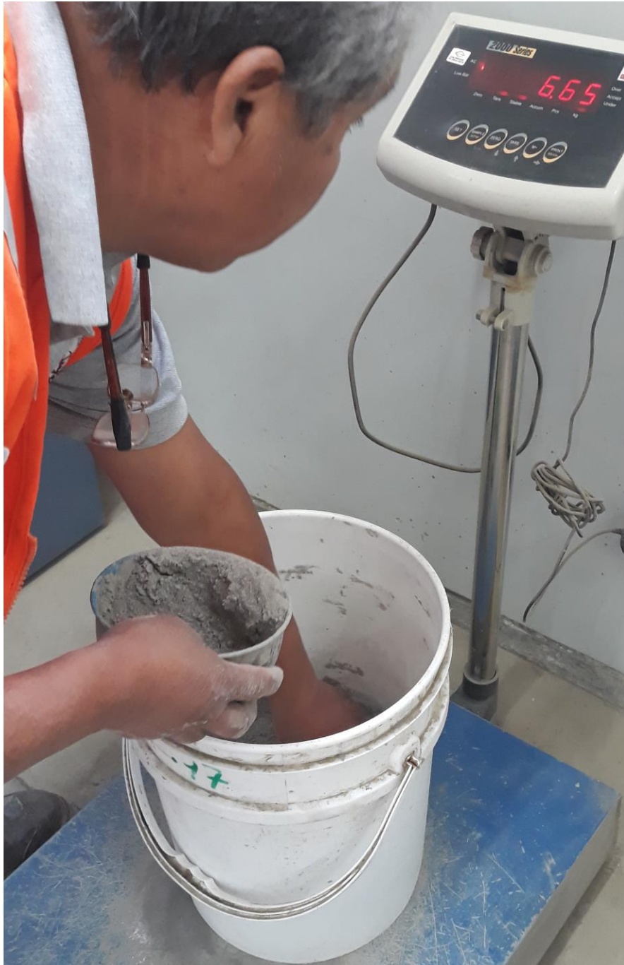
Foto 9. PESADO DEL CEMENTO EN EL LEM – FIC UNI
