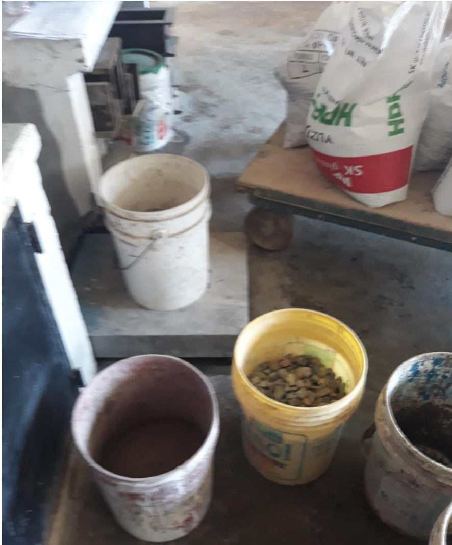
Foto 8. PESADO DE AGREGADO GRUESO EN EL LEM – FIC UNI
