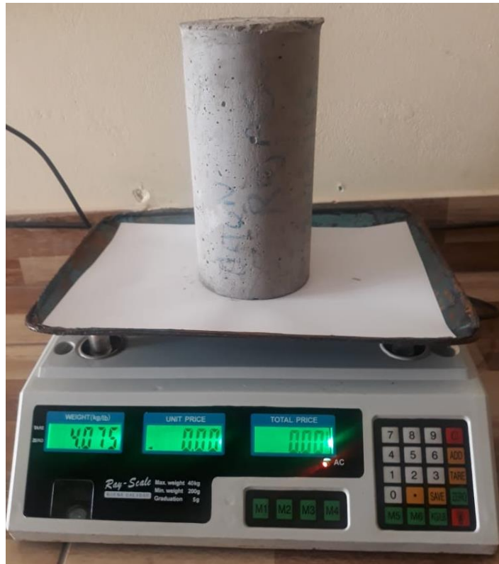
Foto 2. Peso de probeta (a/c: 0.45)
