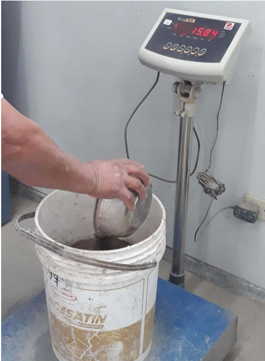
Foto 10. PESADO DE AGREGADO FINO EN EL LEM - FIC UNI
