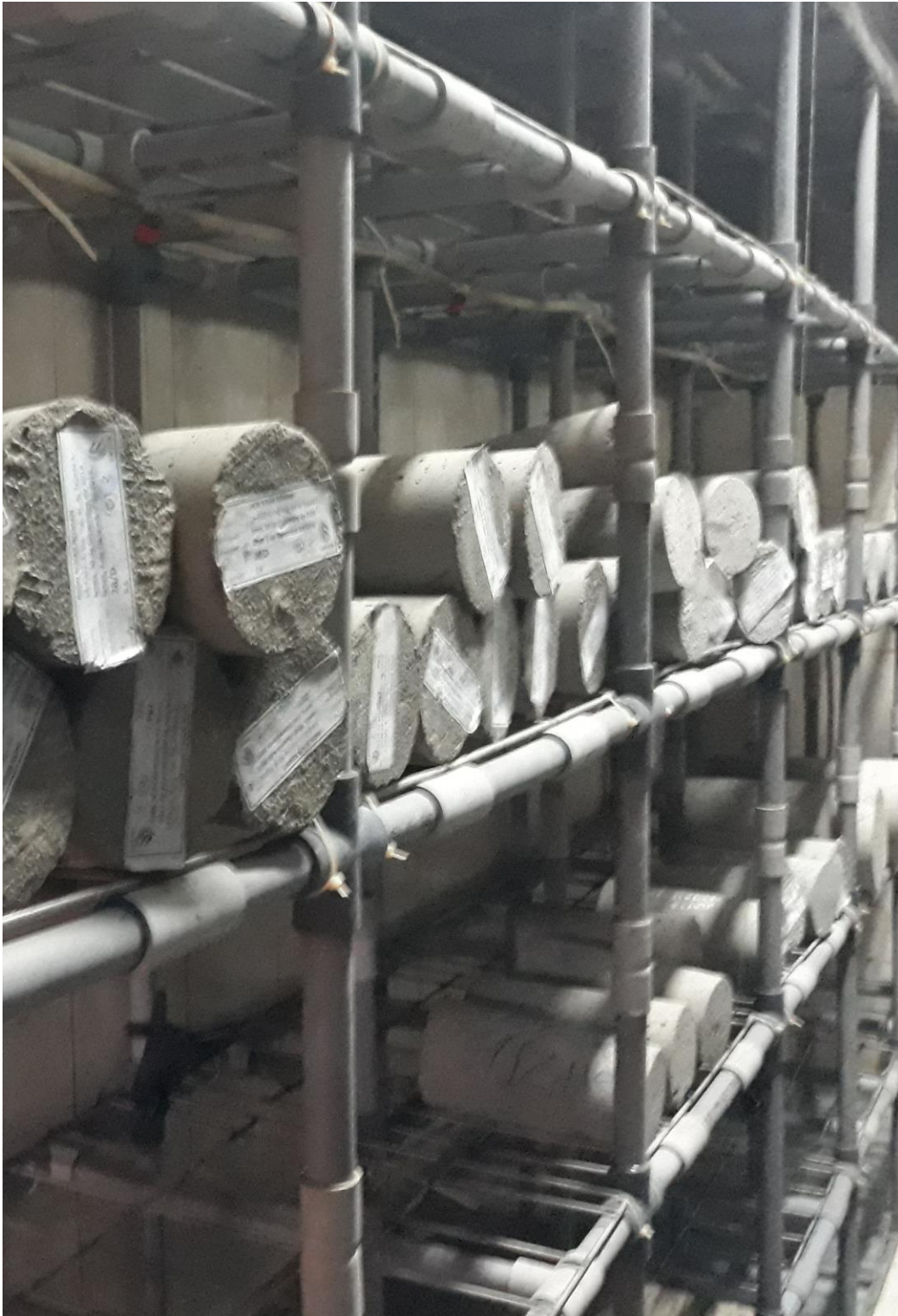
Foto 14. CÁMARA DE CURADO EN EL LEM - FIC UNI
