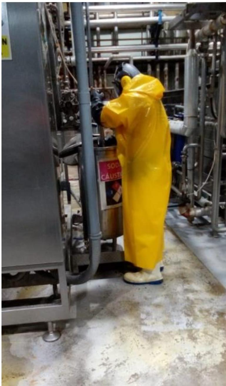
*Foto 1. Adición de soda cáustica y ácido nítrico en los tanques de dosificación en el punto de monitoreo N°01 (Flex 7).*
