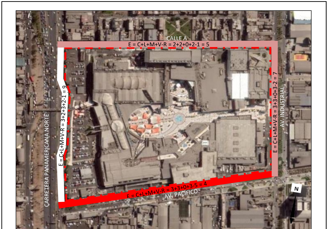
Fuente: Google Earth con elaboración propia. En la Av. Pacífico, el riesgo es máximo R=5 porque pasa una línea de cables de alta tensión
