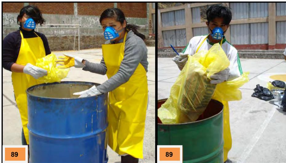
Foto N° 89: Cálculo de la densidad de residuos mediante método del cilindro
