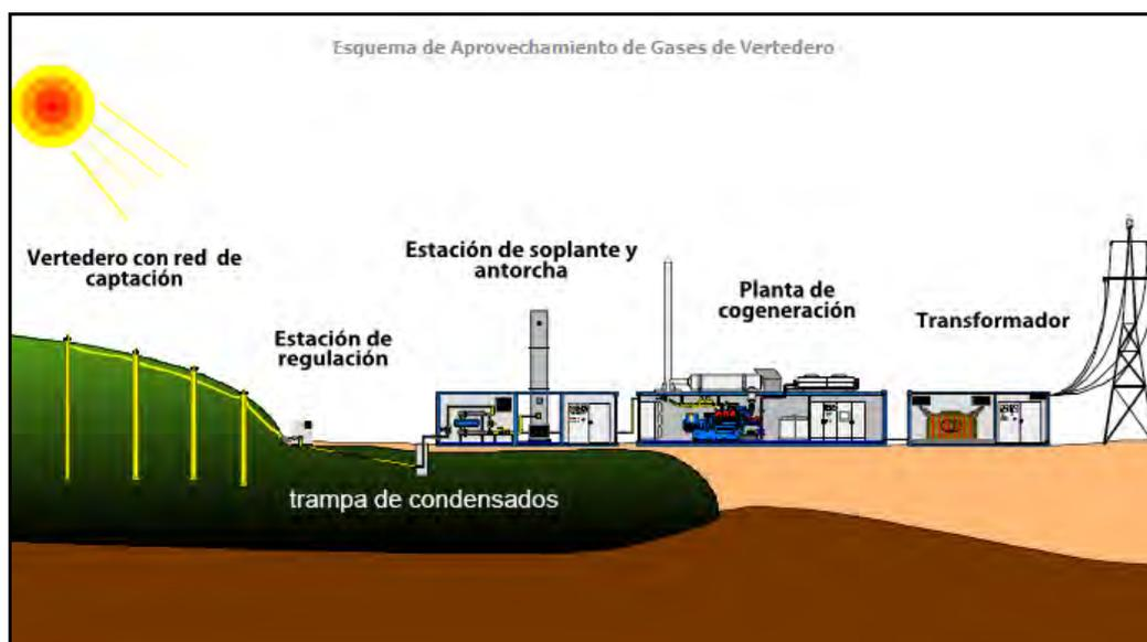
Figura N° 24: Esquema de aprovechamiento de gases de vertedero
