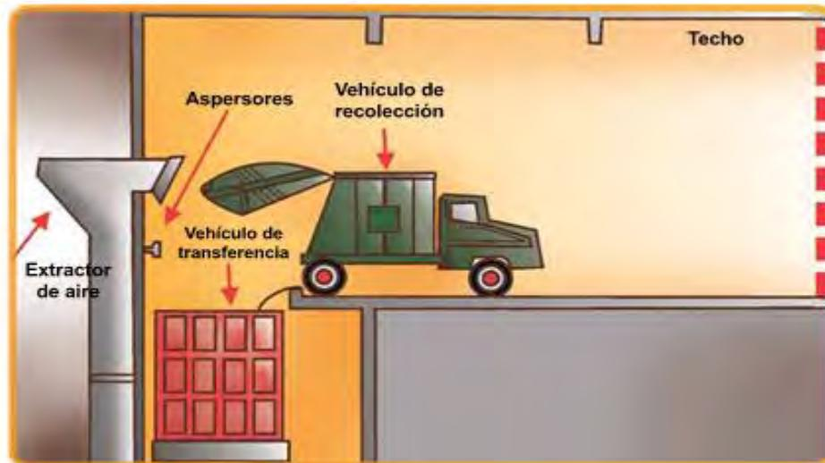
Figura N° 7: Traspardo de residuos sólidos en estación de carga directa
