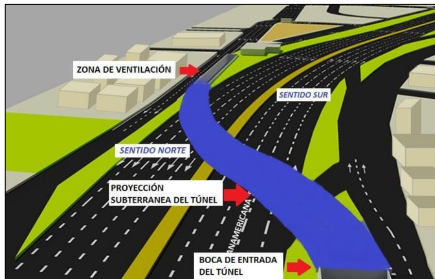
Figura N°3.02 Proyección de la Zona de Ventilación – Elaboración Propia
