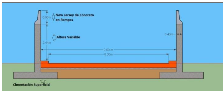
Figura N°3.06 Vista en Corte de Sección en “U” – Elaboración Propia
