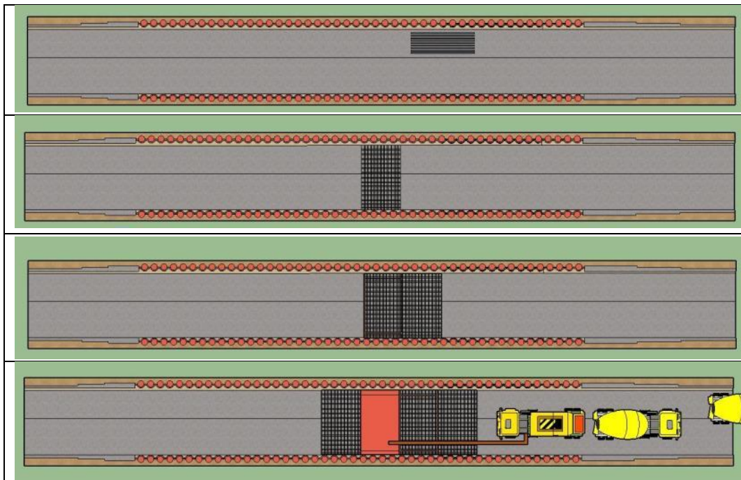
Figura N°5.38 Curado de la Losa de Concreto Armado – Elaboración Propia
