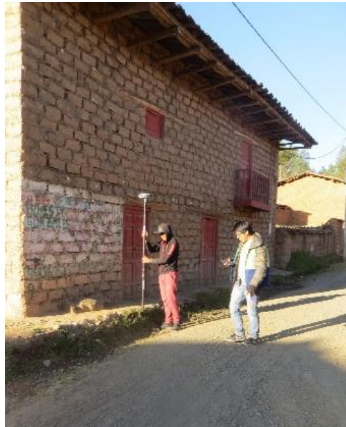
Figura N°3.14: levantamiento geodésico de los 20 predios con GNSS método RTK
