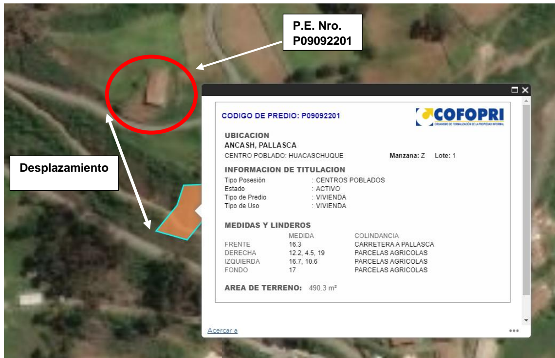
Figura N°3.35: desfase de la P.E. Nro. P09092201 con el portal de COFOPRI
