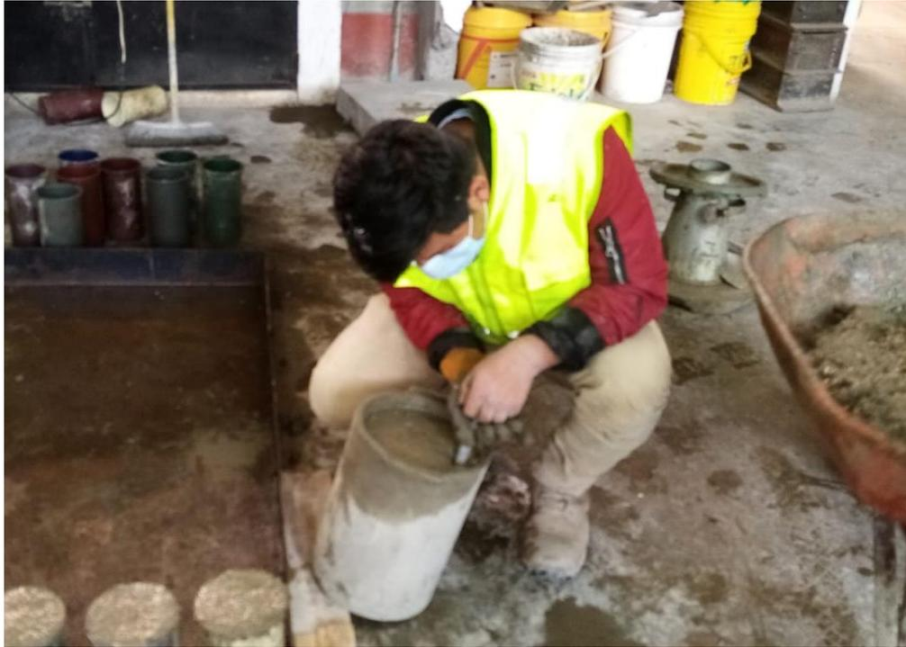
Figura N° 09: Ensayo Exudacion para cada diseño de concreto (capitulo 5.1.2.5)
