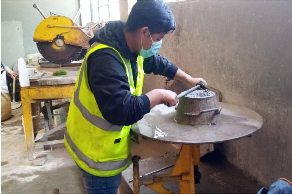
Figura N° 07: Ensayo de fluidez en la mesa de sacudidas para cada diseño de concreto (capítulo 5.1.2.3)
