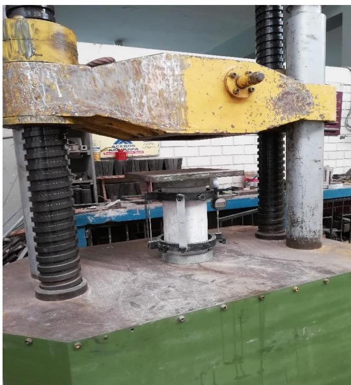
Figura N° 16: Ensayo de M.E. mediante la máquina universal para cada diseño de concreto (capitulo 5.1.3.3)
