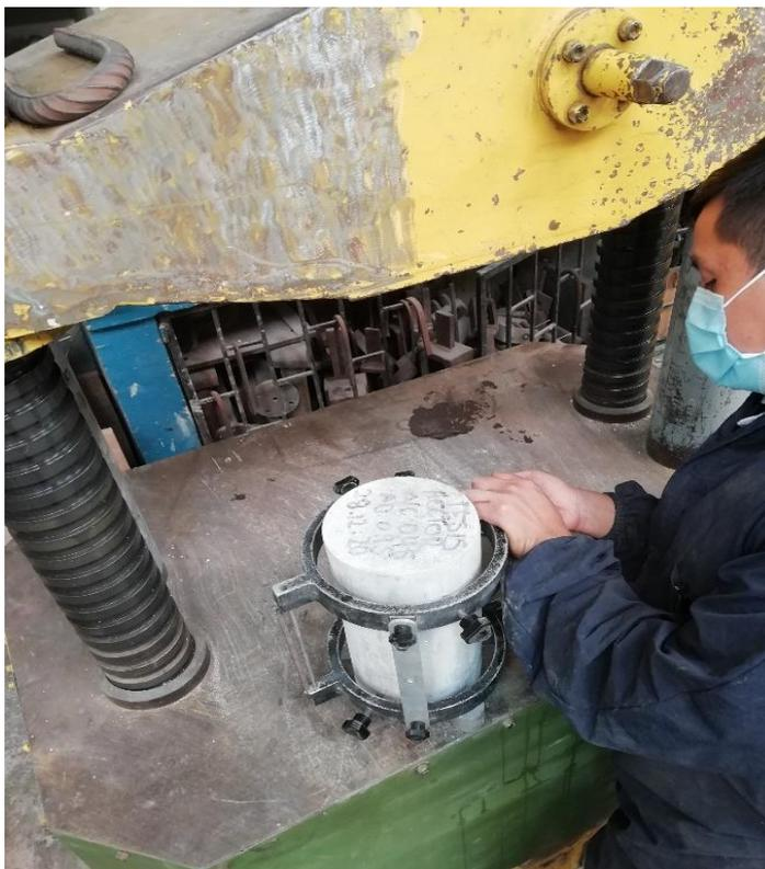
Figura N° 15: Adecuación de comprensometro a probetas de 15x30 cm para ensayo de M.E. de cada diseño de concreto (capitulo 5.1.3.3)
