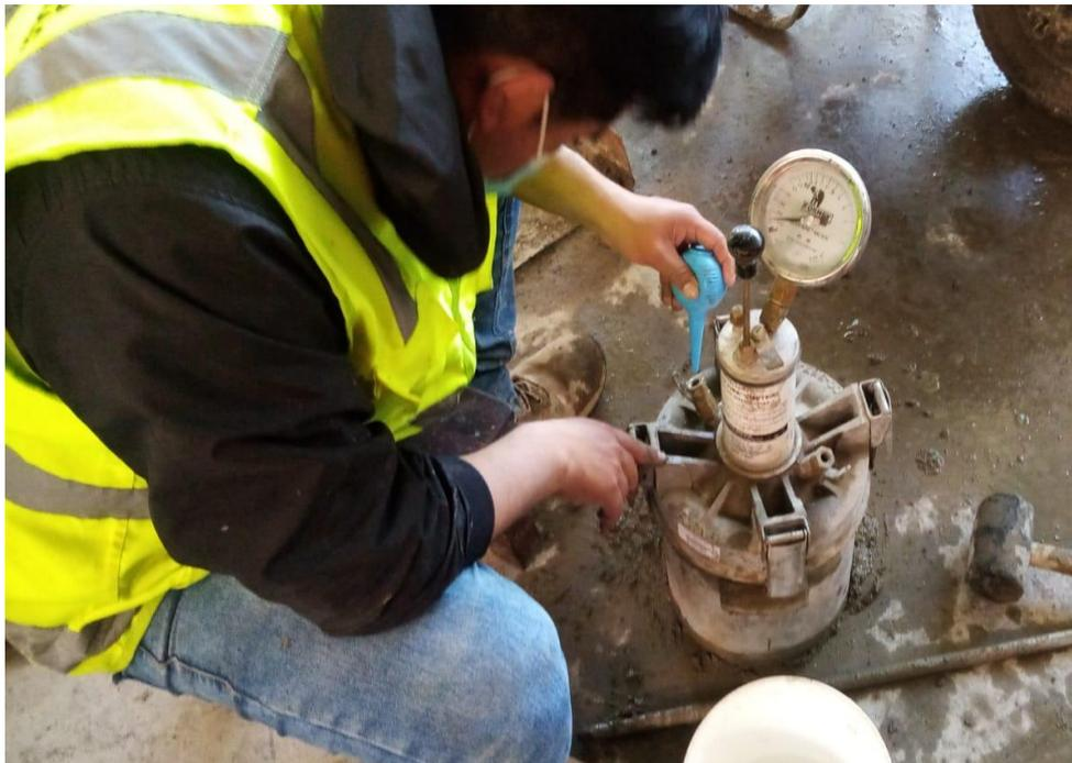
Figura N° 08: Ensayo de contenido de aire mediante la olla de Washington para cada diseño de concreto (capítulo 5.1.2.4)
