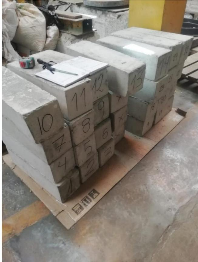
Figura N° 17: Marcado y medición de vigas para ensayo a flexión (capítulo 5.1.3.4)
