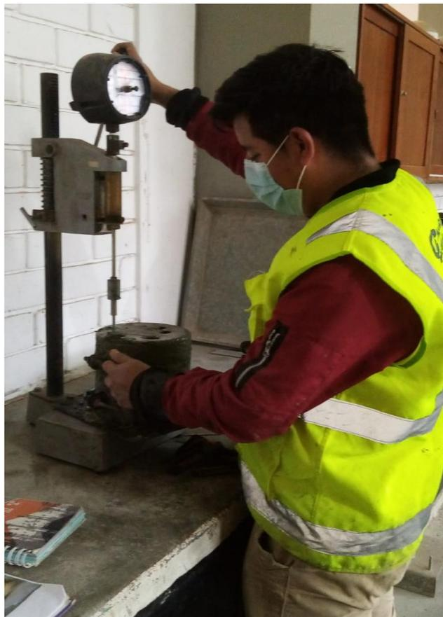
Figura N° 10: Ensayo de tiempo de fragua mediante las agujas de Vicat para cada diseño de concreto (capitulo 5.1.2.6)
