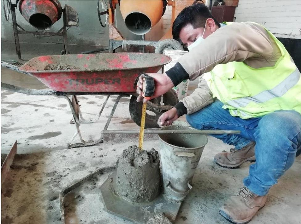
Figura N° 05: Obtención del asentamiento mediante el cono de Abrams de cada muestra preparada (capítulo 5.1.2.1)
