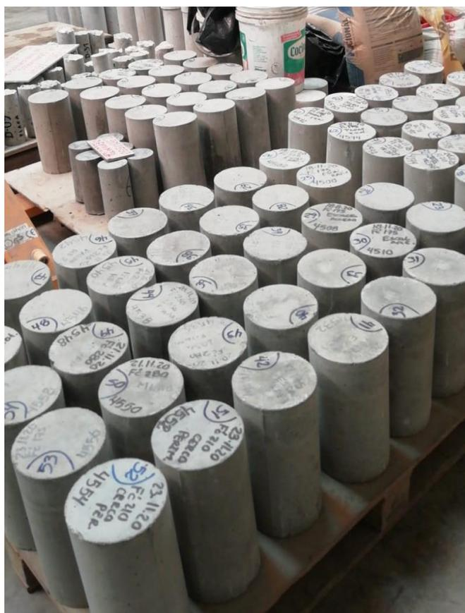
Figura N° 12: Marcado para ensayos de resistencia a la compresión axial, tracción diametral y modulo elástico para cada diseño de concreto (capítulo 5.1.3.)
