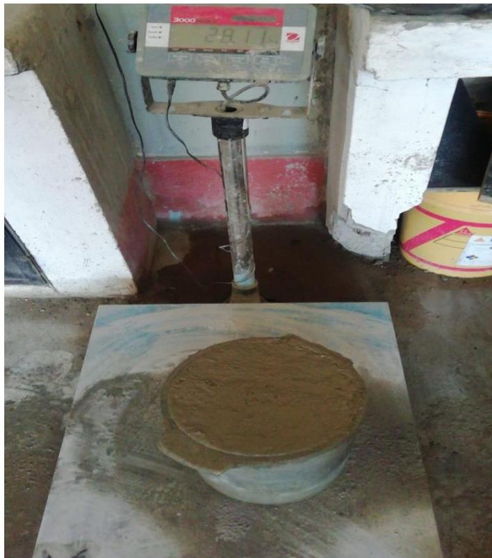
Figura N° 06: Ensayo de peso unitario de todas las muestras de concreto (capítulo 5.1.2.2)
