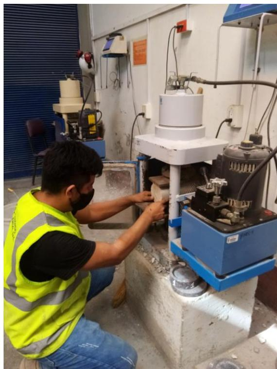
Figura N° 14: Ensayos de resistencia a la tracción diametral para cada diseño de concreto (capítulo 5.1.3.2)
