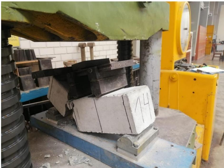
Figura N° 18: Ensayo de resistencia a la flexión de vigas a los 28 días para cada diseño de concreto (capítulo 5.1.3.4)
