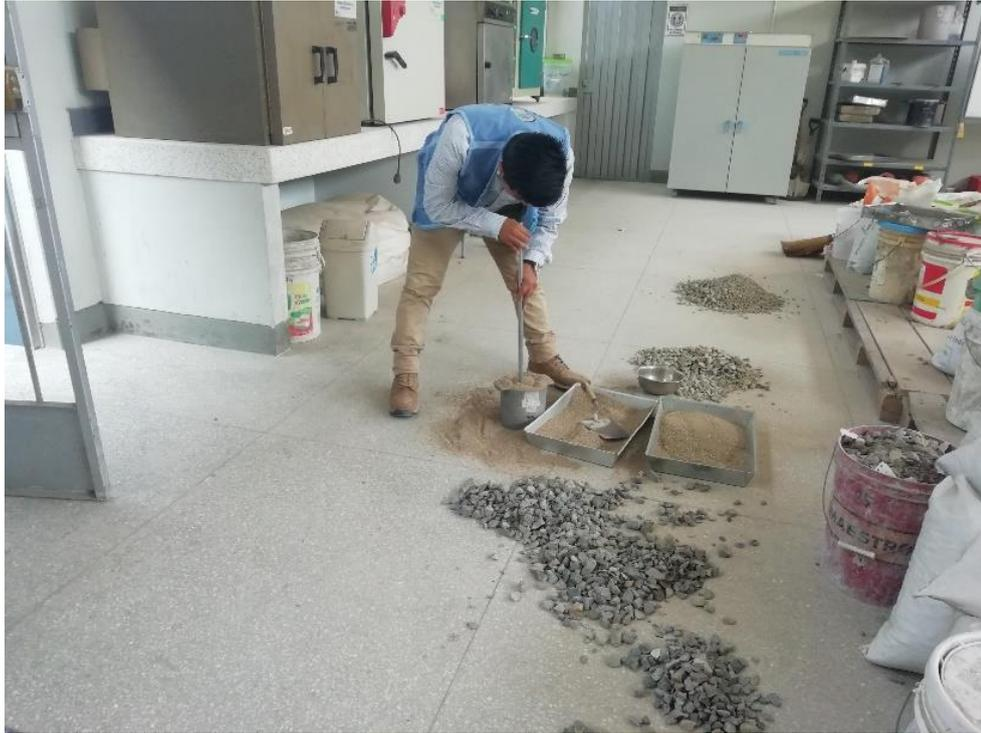
Figura N° 03: Ensayos de peso unitario suelto y compactado del agregado fino (cuadro N°5)
