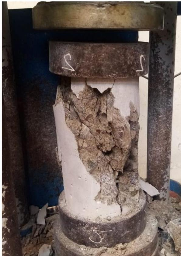
Figura N° 13: Ensayos de resistencia a la compresión axial para cada diseño de concreto (capítulo 5.1.3.1.)
