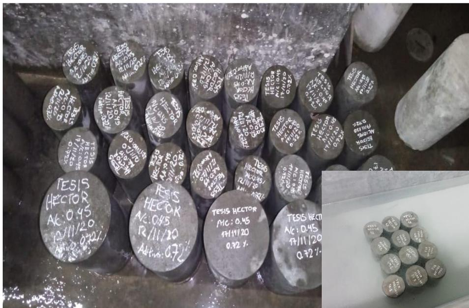
Figura N° 11: Muestreo de probetas de 10x20 cm y 15x30 cm, así como el fraguado a los 7, 14 o 28 días según correspondan para cada diseño de concreto (capítulo 5.1.3.)
