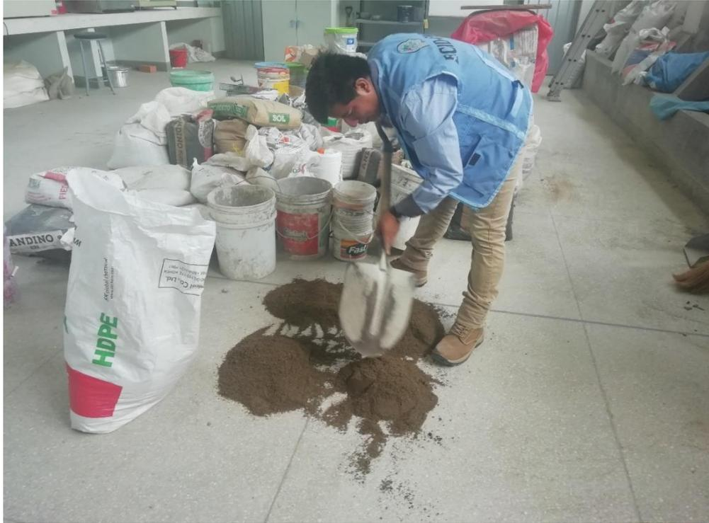
Figura N° 01: Cuarteo para ensayos y obtener propiedades del agregado fino (capítulo 3.2.)
