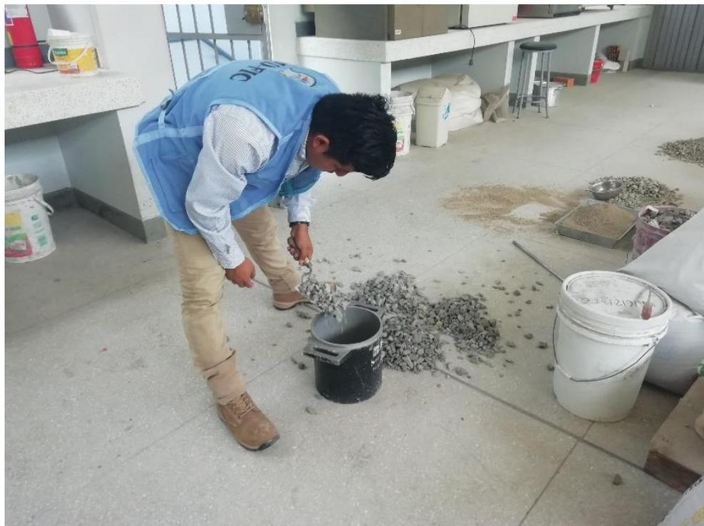
Figura N° 04: Ensayos de peso unitario suelto y compactado del agregado grueso (cuadro N°5)
