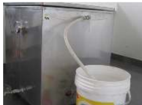
Imagen N° 6. Sistema para el decantado del vapor de agua. Elaboración Propia.
