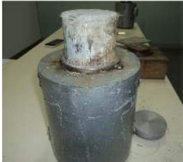
Imagen N° 31. Desmoldamiento de las probetas de concreto. Elaboración Propia.
