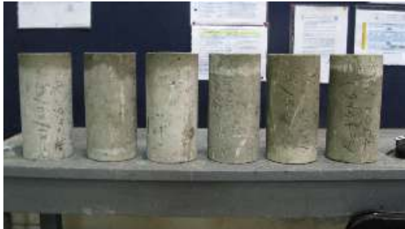
Imagen N° 13. Probetas de concreto desmoldadas después de 23 horas. Elaboración Propia..
