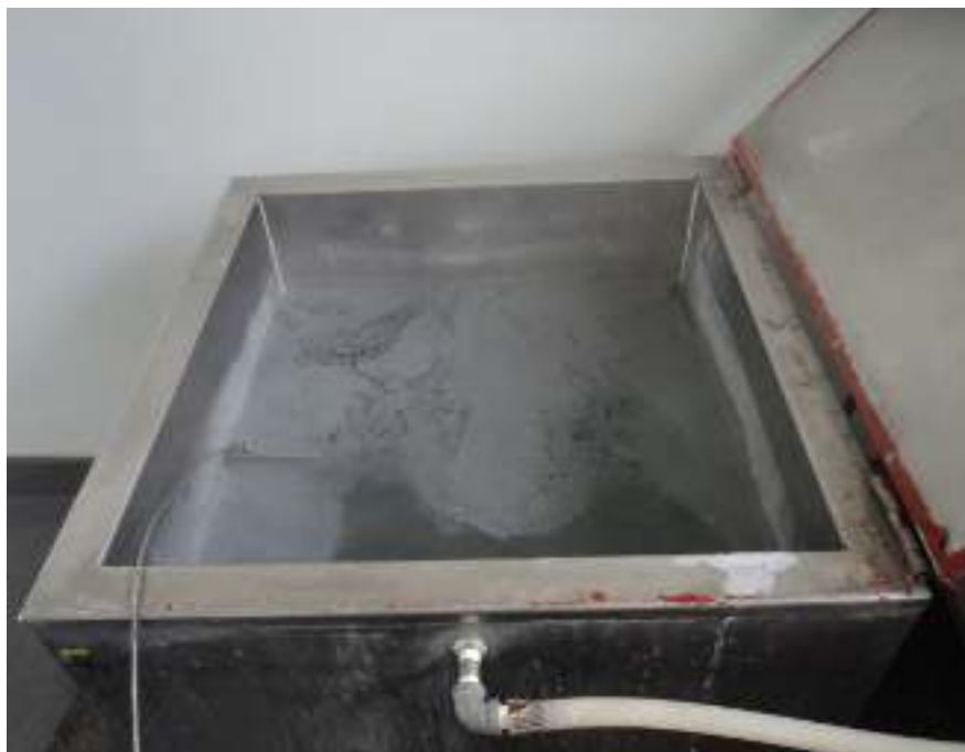
Imagen N° 10. Vista del curado al finalizar el procedimiento de curado acelerado. Elaboración Propia.
