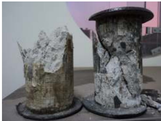
Imagen N° 37. Fotografía de probetas 7.5 cm x 15.0 cm después de sus ensayos de compresión axial. Elaboración Propia.
