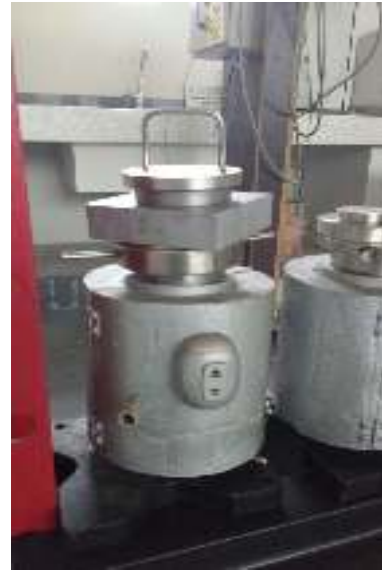
Imagen N° 33. Embaces que contendrán y mantendrán las probetas de concreto en las condiciones requeridas.
