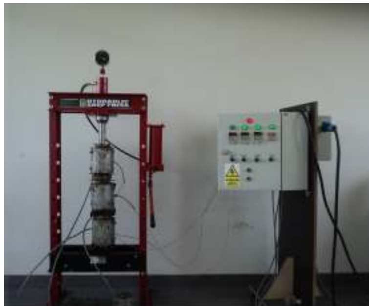
Imagen N° 30. Vista del Procedimiento de Curado acelerado de Alta Temperatura y Presión. Elaboración Propia.
