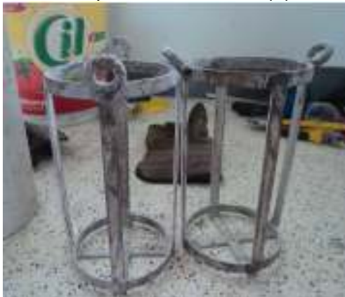
Imagen N° 5. Soporte de probetas para la extracción segura de las mismas a 100 °C.
