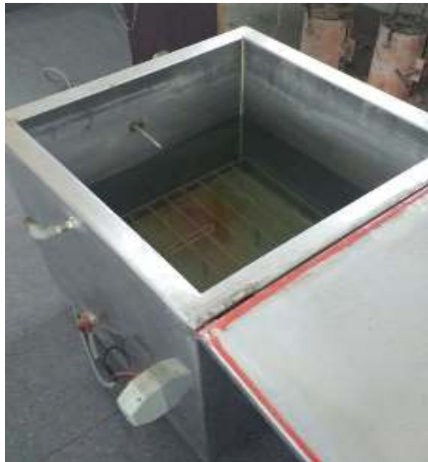
Imagen N° 14. Tanque de curado a punto de comenzar su calentamiento. Elaboración Propia..
