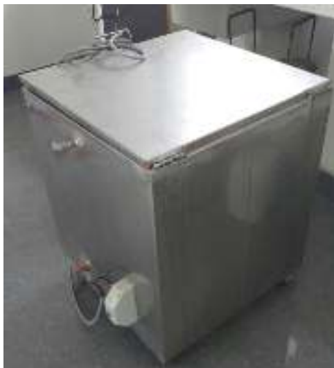
Imagen N° 11. Vista del tanque de curado acelerado para el procedimiento B.
