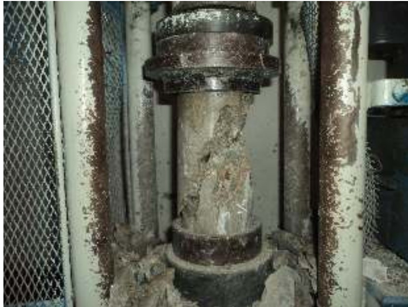
Imagen N° 16. Probeta de concreto de 15 cm x 30 cm después del ensayo de compresión axial. Elaboración Propia.
