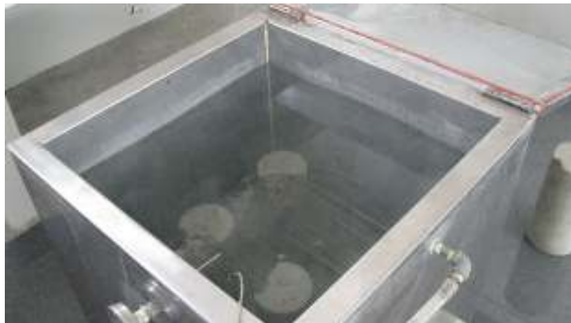
Imagen N° 15. Las probetas deben estar como mínimo 5 cm sumergidos desde la parte superior. Elaboración Propia..
