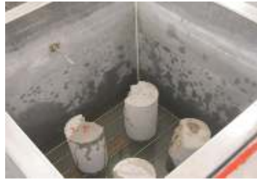
Imagen N° 7. Vista interna de la poza de curado con las probetas de curado encima del soporte.
