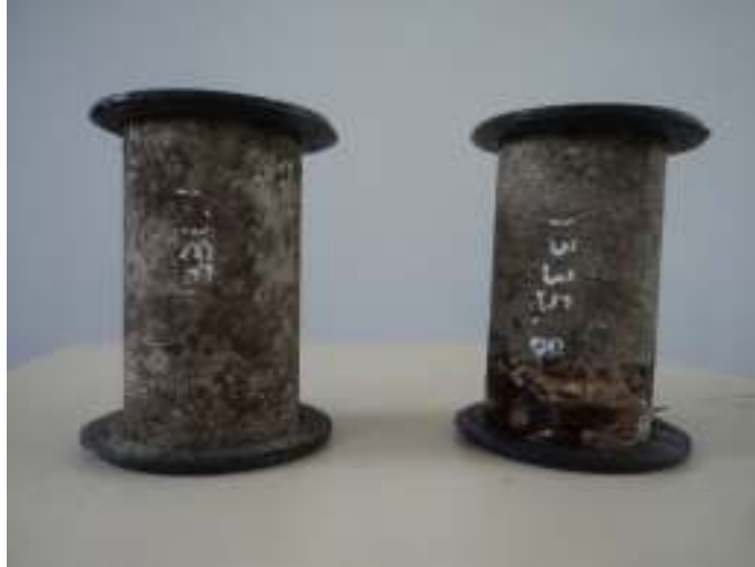
Imagen N° 36. Probetas del procedimiento D que han sido capeados para el ensayo. Elaboración Propia.
