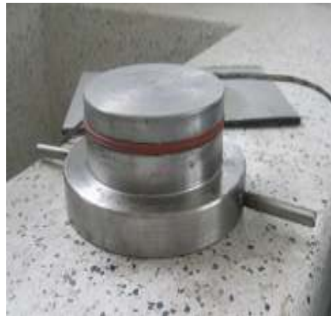
Imagen N° 28. Vista de la Junta Tórica. Elaboración Propia.
