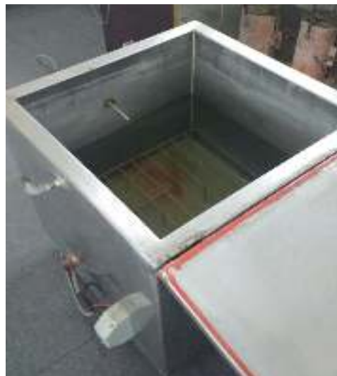
Imagen N° 12. Vista interna del tanque de curado con las características mínimas para su desarrollo.
