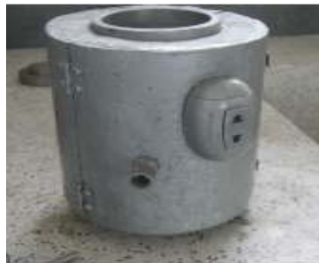
Imagen N° 24. Envase de acero inoxidable con recubrimiento de fibra de vidrio. Elaboración Propia.
