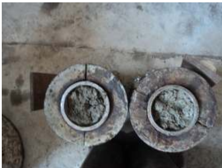
Imagen N° 35. Fotografía superior del vaciado del concreto en los moldes de acero para el procedimiento D. Elaboración Propia.
