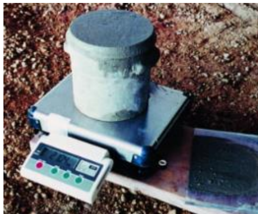
Figura N° 5.2 Ensayo de Peso Unitario del concreto fresco
