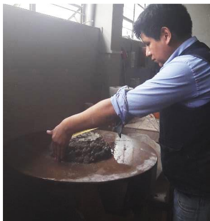
Figura N° 5.3 Ensayo de fluidez del concreto fresco
