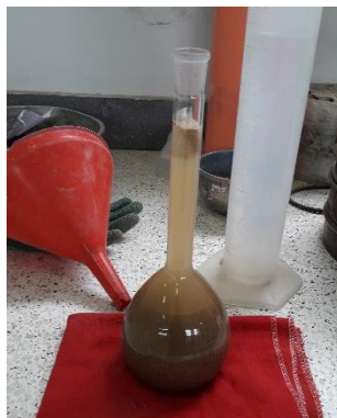
Figura N° 3.2 Ensayo de Peso Específico y Absorción de la arena
