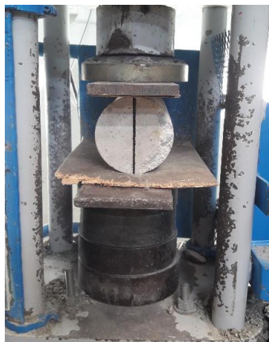
Figura N° 6.2 Ensayo de tracción por compresión diametral del concreto
