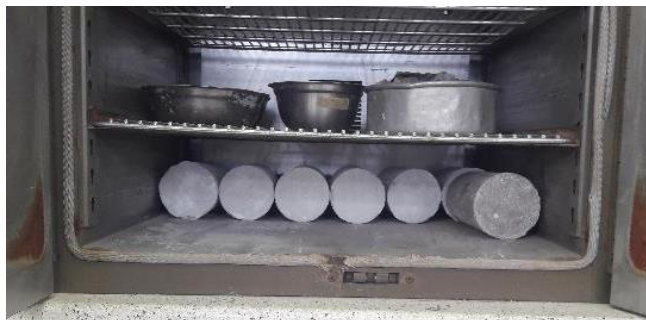
Figura N° 6.4 Secado al horno para el ensayo de absorción
