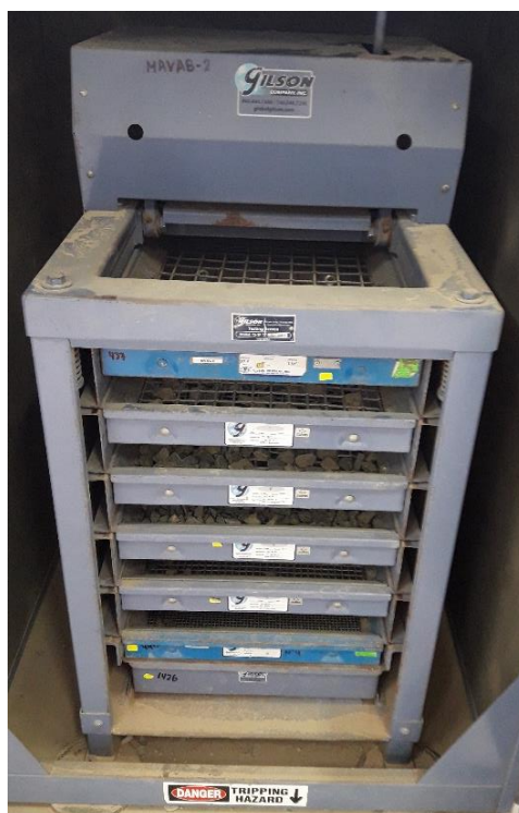
Figura N° 3.3 Ensayo de granulometría de la piedra
