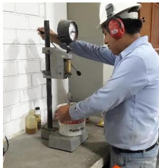
Figura N° 5.5 Ensayo de tiempo de fraguado
