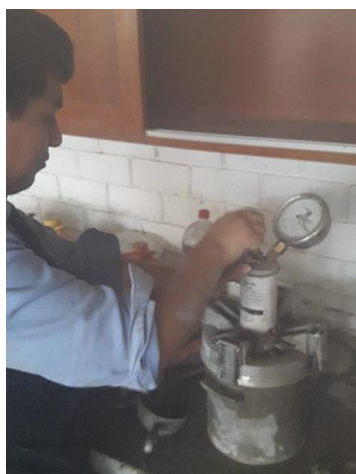
Figura N° 5.4 Ensayo de Contenido de Aire
