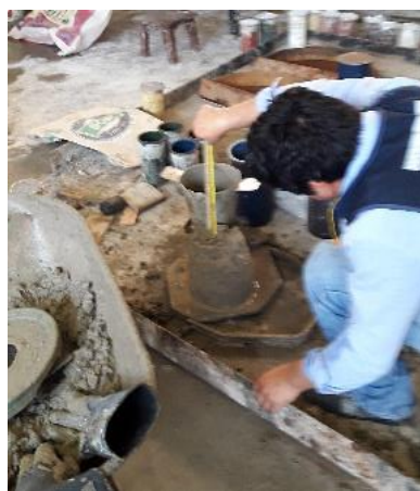
Figura N° 5.1 Ensayo de Asentamiento del concreto fresco
