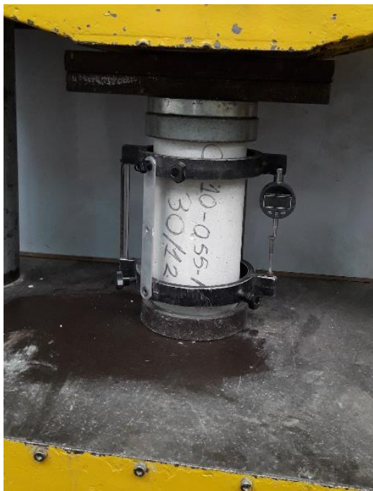
Figura N° 6.3 Ensayo de módulo elástico del concreto
