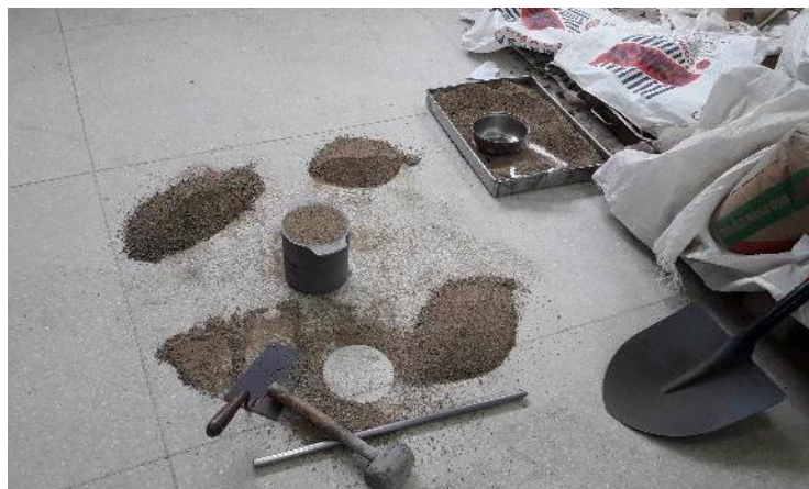
Figura N° 3.1 Ensayo de Peso Unitario de la arena
