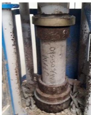
Figura N° 6.1 Ensayo de compresión axial del concreto
