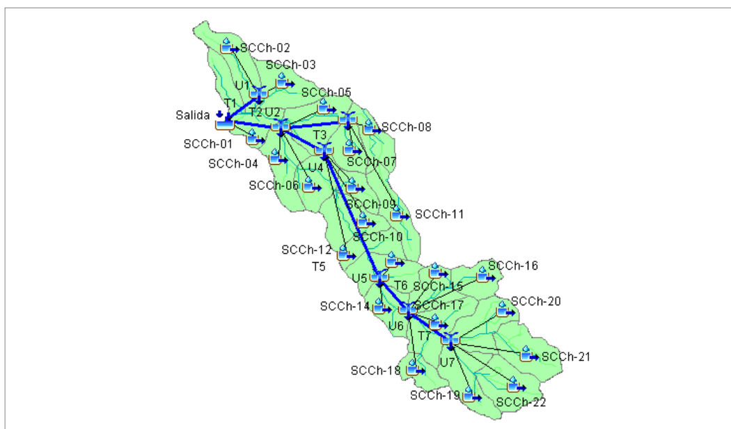
Figura N° 64. Esquema del modelo hidrológico para la transformación precipitación – escorrentía, subcuenca Chumbao, puente Pochccota.
