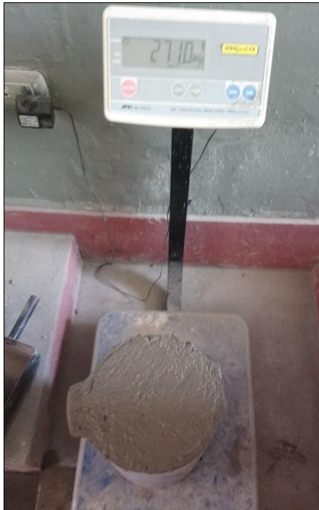
Figura IV-4: Peso del recipiente de volumen nominal ( 1/3 \text{ pie}^3 ) + muestra de concreto fresco compactado.
