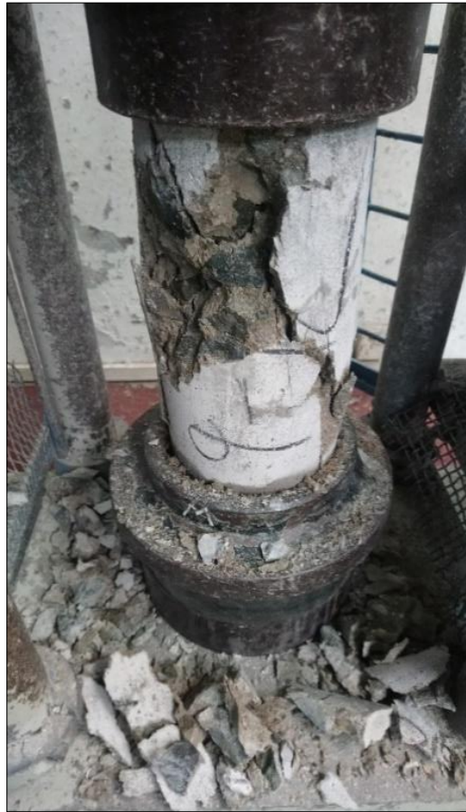
Figura II-5: Falla frágil o explosiva de una probeta de concreto simple
