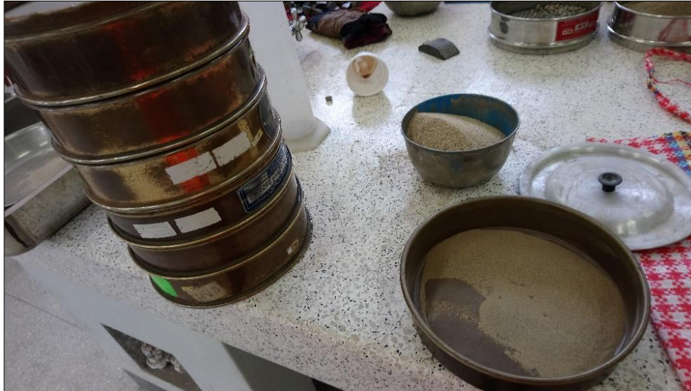
Figura III-21: Agregado fino retenido en la base fondo del tamiz.
