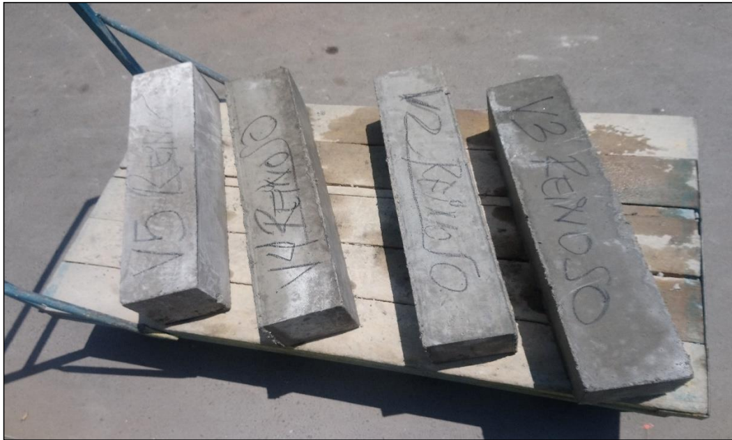
Figura IV-14: Vigas de concreto secando al ambiente.
