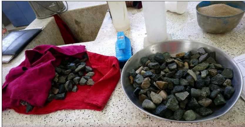
Figura III-35: Muestra de agregado grueso en estado saturado superficialmente seco.
