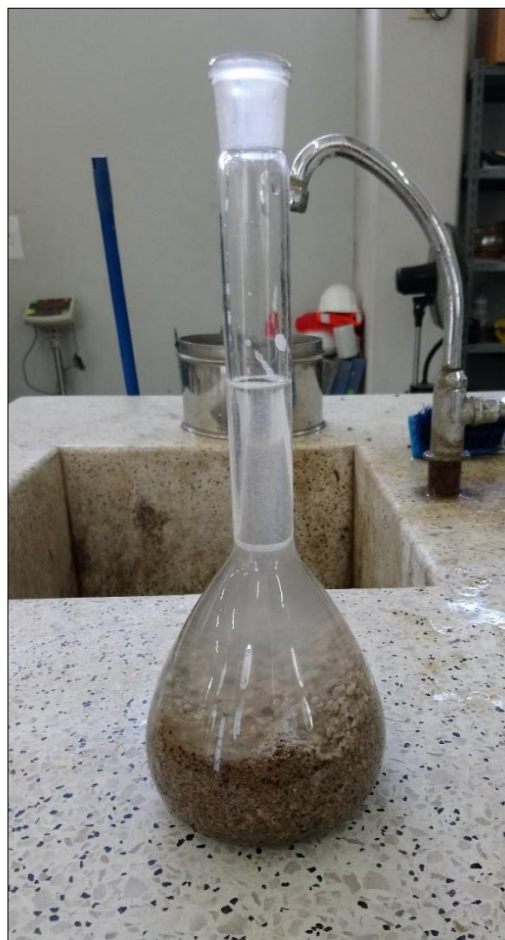
Figura III-15: Picnómetro lleno hasta marca graduada.
