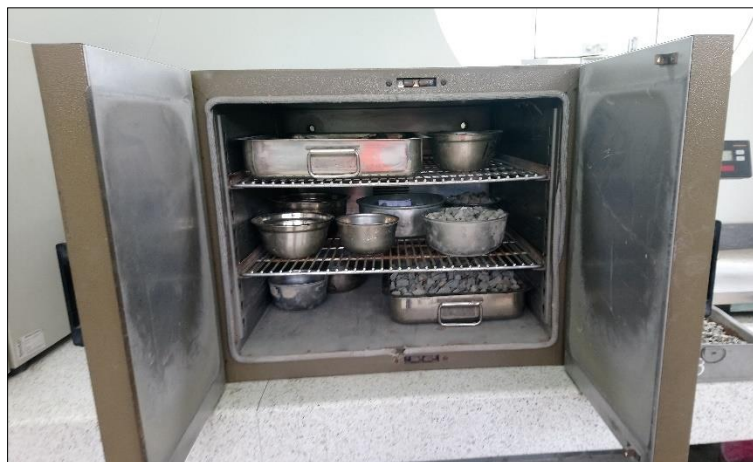
Figura III-4: Proceso de secado de muestras en horno eléctrico a la temperatura de 110 °C.
