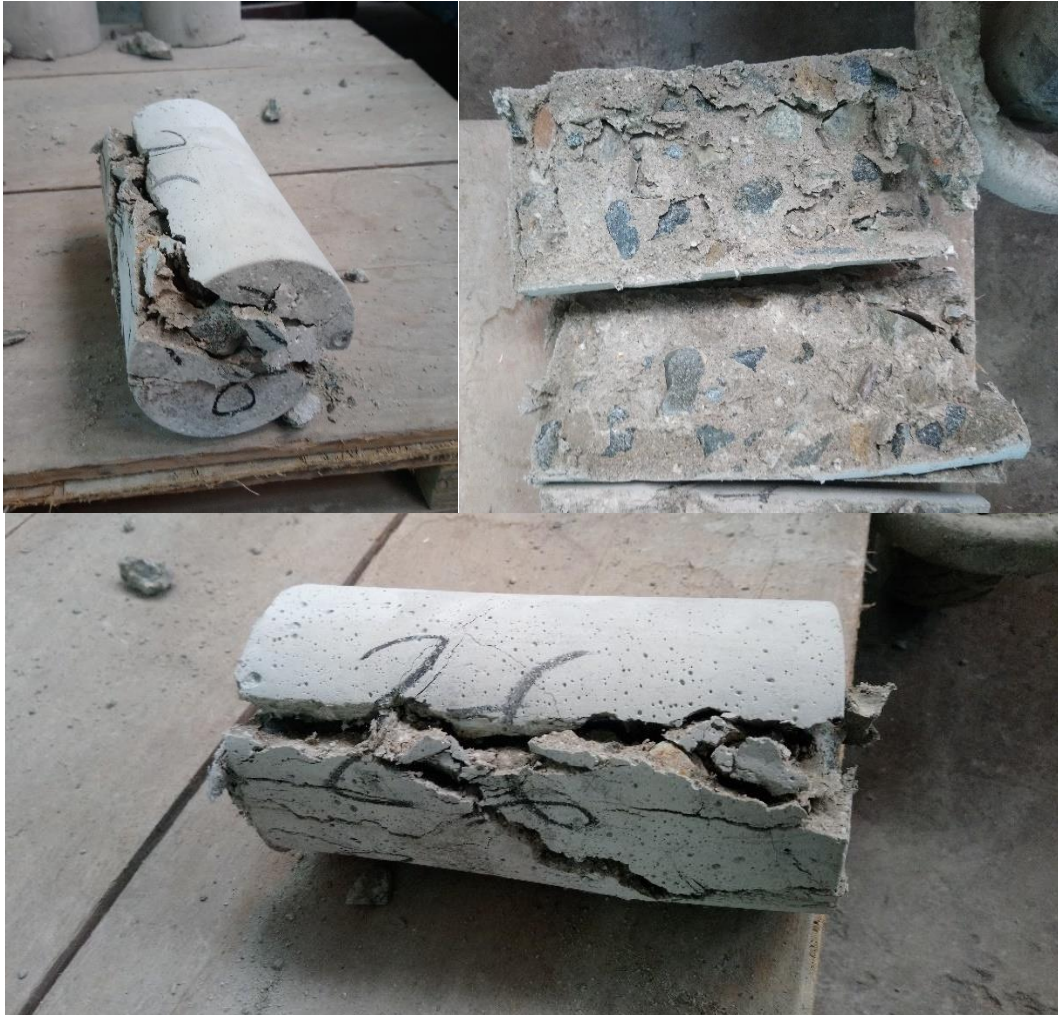
Figura VI-27: Fallas en probetas con relación ( a/c = 0.60 ) fibrorreforzadas al 0.50%, con 28 días de curado (ensayo de tracción por compresión diametral).
