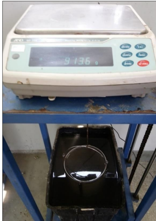
Figura III-37: Lectura de peso de canastilla vacía sumergida.
