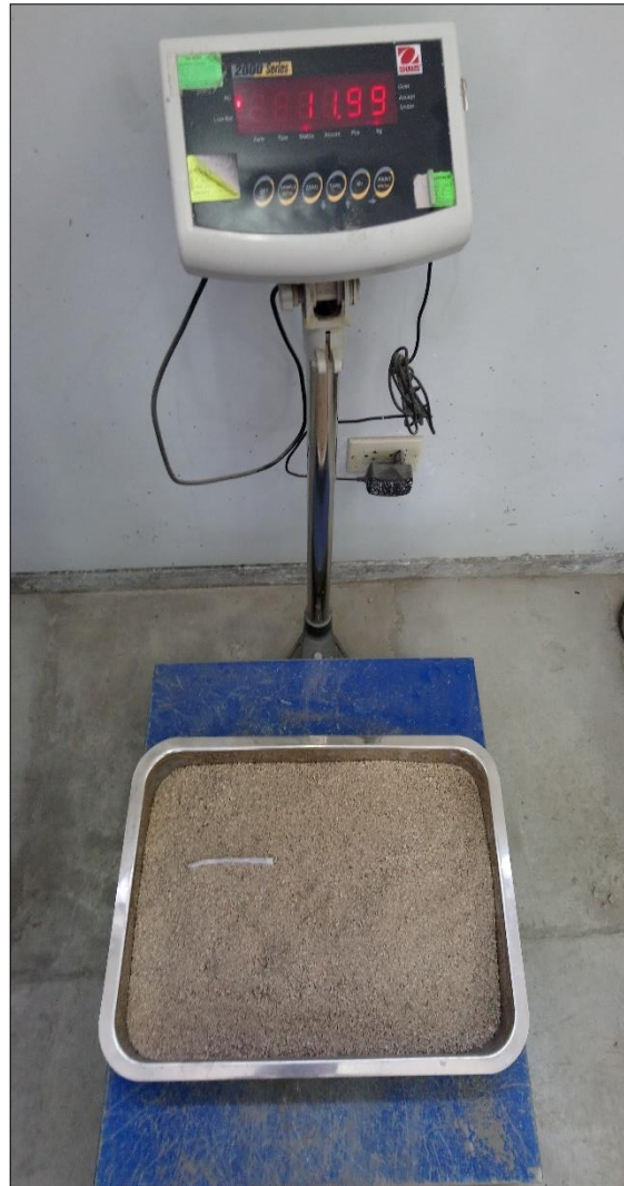
Figura III-5: Peso en balanza de muestra seca de 9.96 kg de agregado fino, cabe resaltar que el peso del recipiente metálico es de 2.03 kg, resultando una lectura total de 11.99 kg en el panel de la balanza.
