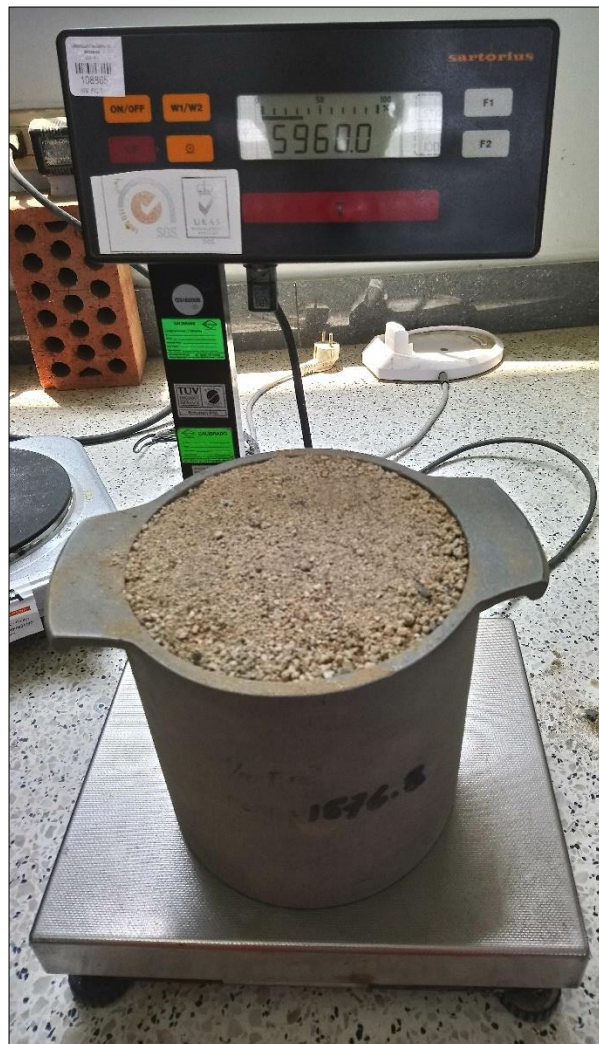
Figura III-7: Peso del recipiente normalizado de volumen nominal ( 1/10 \text{ pie}^3 ) + muestra de agregado fino en estado suelto (sin compactar).
