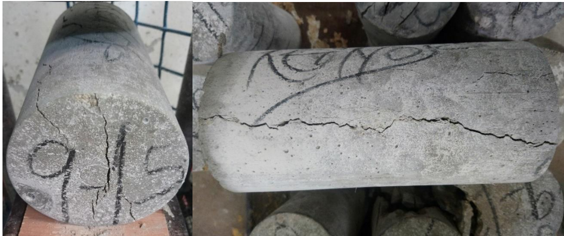
Figura VI-34: Fallas en probetas con relación ( a/c = 0.70 ) patrón, con 28 días de curado (ensayo de tracción por compresión diametral).
