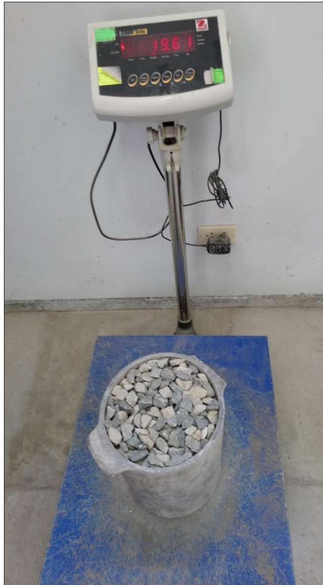
Figura III-33: Peso del recipiente normalizado de volumen nominal ( 1/3 \text{ pie}^3 ) + muestra de agregado grueso en estado compactado.
