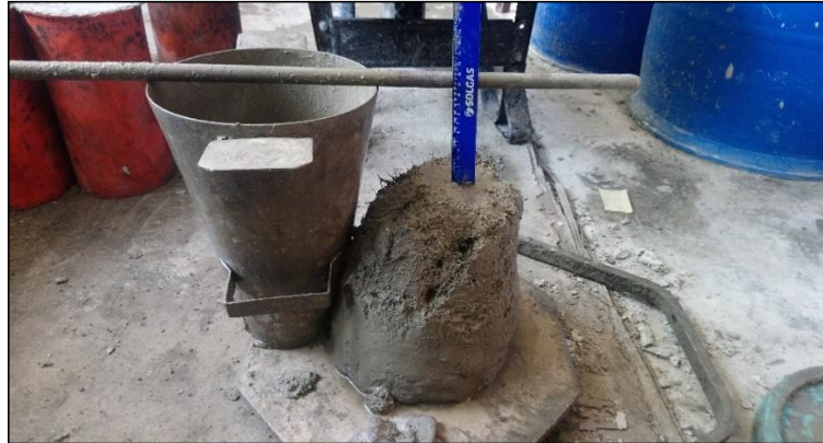
Figura VI-3: Asentamiento en concreto fibrorreforzado al 1.00% – ( a/c= 0.65 ).
