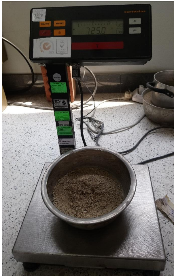
Figura III-18: Peso de la muestra seca en horno incluido recipiente metálico.
