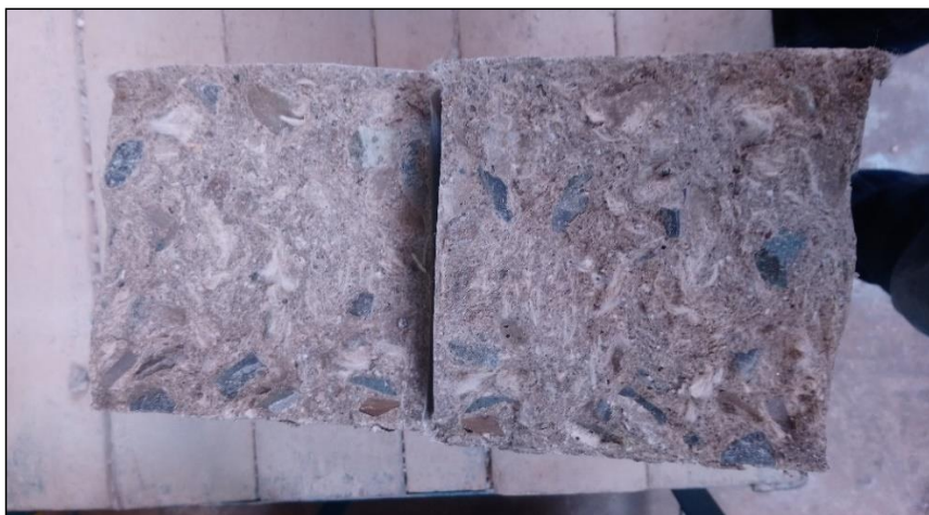
Figura IV-21: Zona de fractura de la viga, ensayada a flexión con carga aplicada en el centro de la luz.
