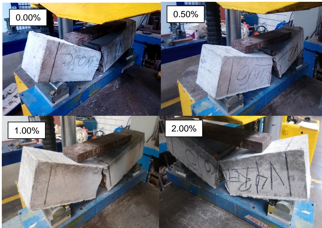
Figura VI-39: Vigas con relación (a/c=0.60) una vez finalizado el ensayo de módulo de rotura.
