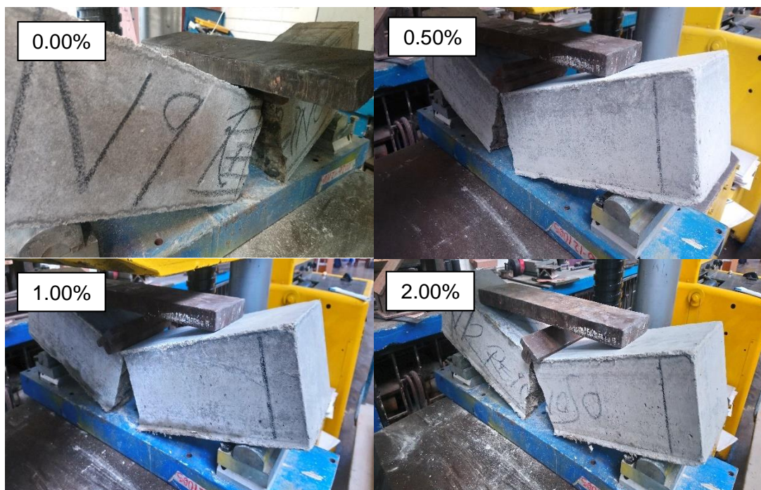
Figura VI-41: Vigas con relación ( a/c=0.70 ) una vez finalizado el ensayo de módulo de rotura.
