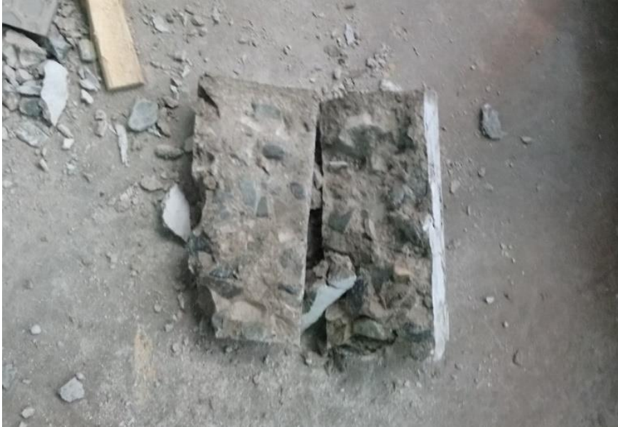
Figura VI-30: Fallas en probetas con relación ( a/c = 0.65 ) patrón, con 28 días de curado (ensayo de tracción por compresión diametral).
