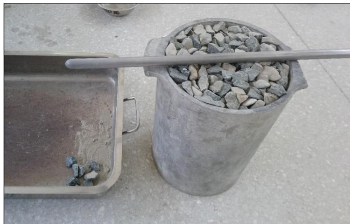
Figura III-32: Recipiente más muestra de agregado grueso en estado compactado.
