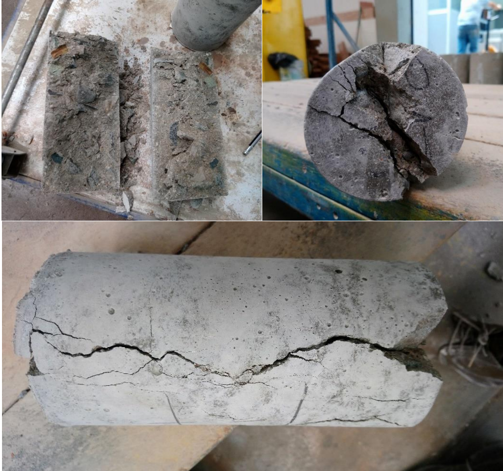
Figura VI-26: Fallas en probetas patrón con relación ( a/c = 0.60 ), con 28 días de curado (ensayo de tracción por compresión diametral).
