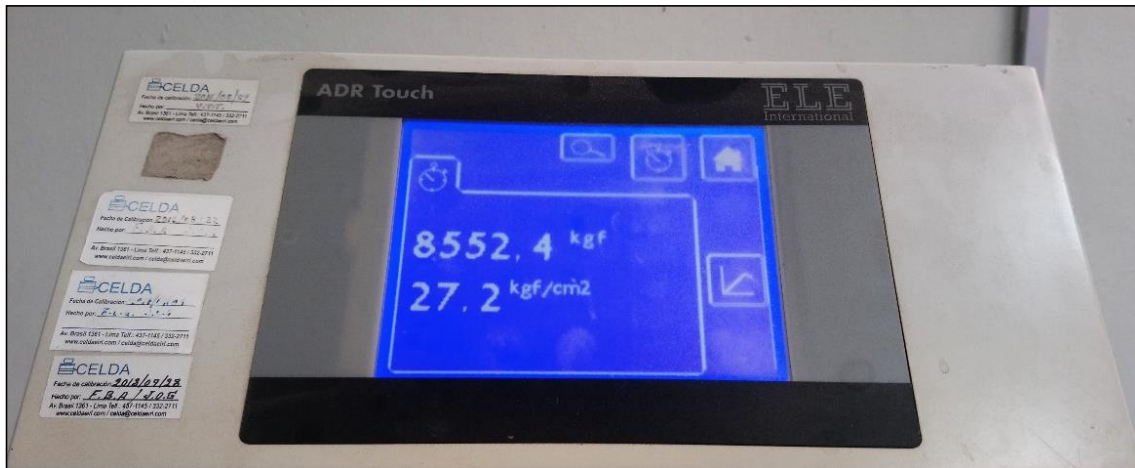
Figura IV-12: Fuerza máxima en kilogramos aplicada en compresión diametral a la probeta de concreto
