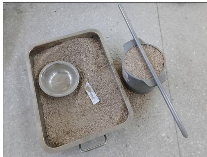
Figura III-6: Recipiente más muestra de agregado fino en estado suelto (sin compactar).
