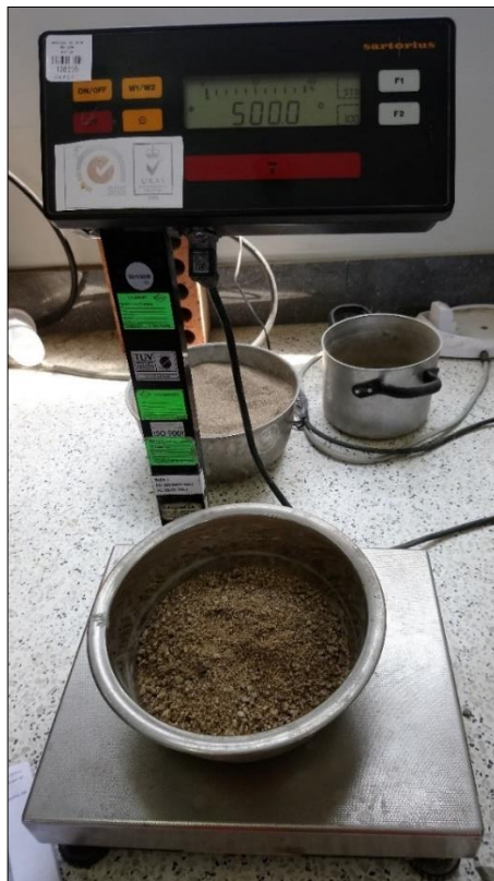
Figura III-12: Muestra de 500g de agregado fino en estado saturado superficialmente seco.
