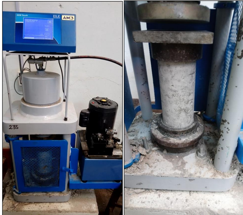
Figura IV-8: Ensayo de compresión simple en probeta de concreto
