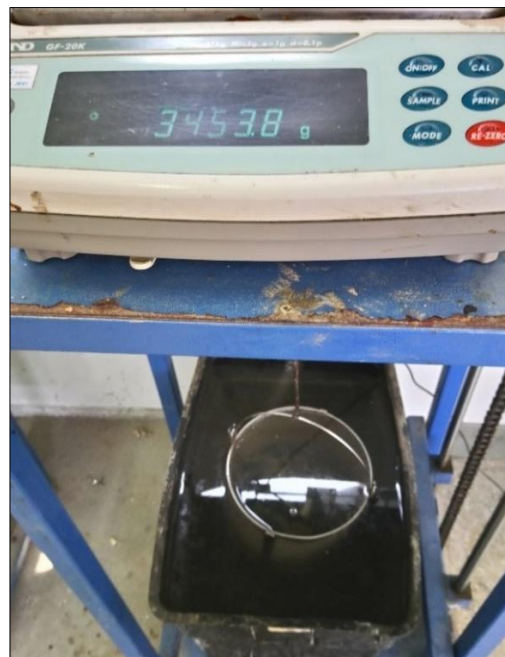
Figura III-38: Peso de muestra más canastilla sumergida en agua.
