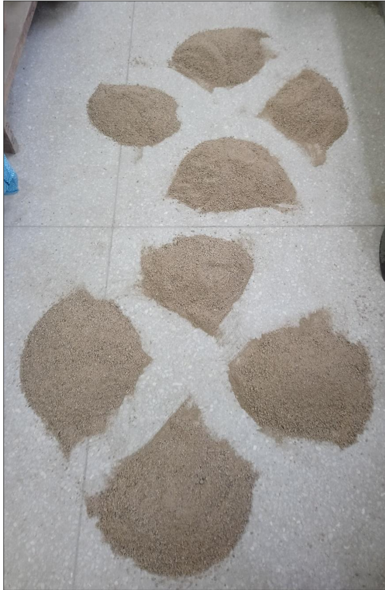
Figura III-2: Proceso de cuarteo para obtención de muestras representativas de agregado fino.
