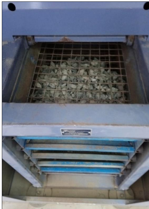
Figura III-40: Colocación de la muestra de agregado grueso en los tamices normalizados.
