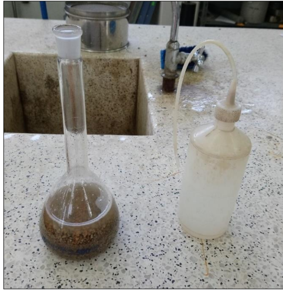
Figura III-14: Procedimiento de llenado de picnómetro.
