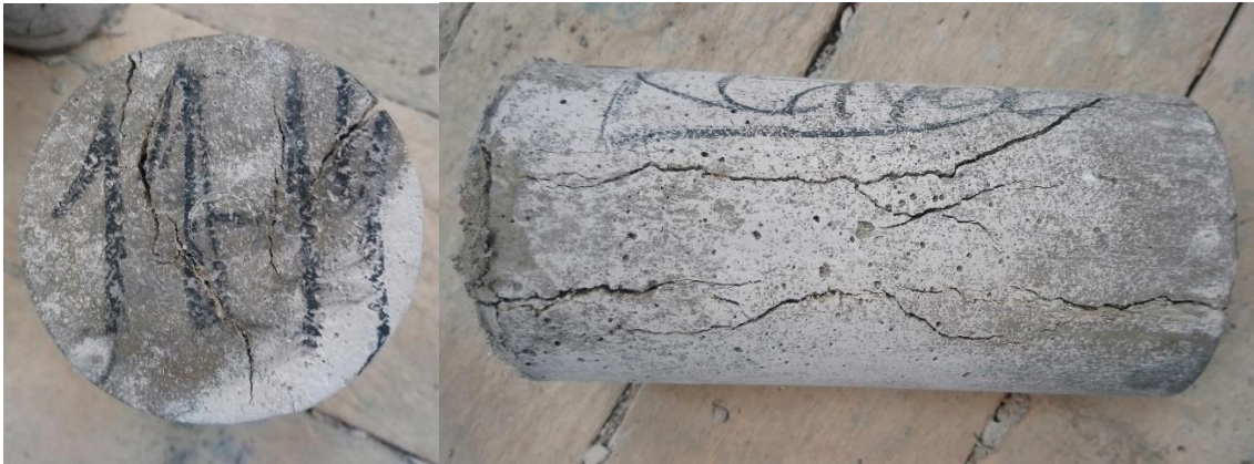
Figura VI-36: Fallas en probetas con relación ( a/c = 0.70 ) fibrorreforzadas al 1.00%, con 28 días de curado (ensayo de tracción por compresión diametral).
