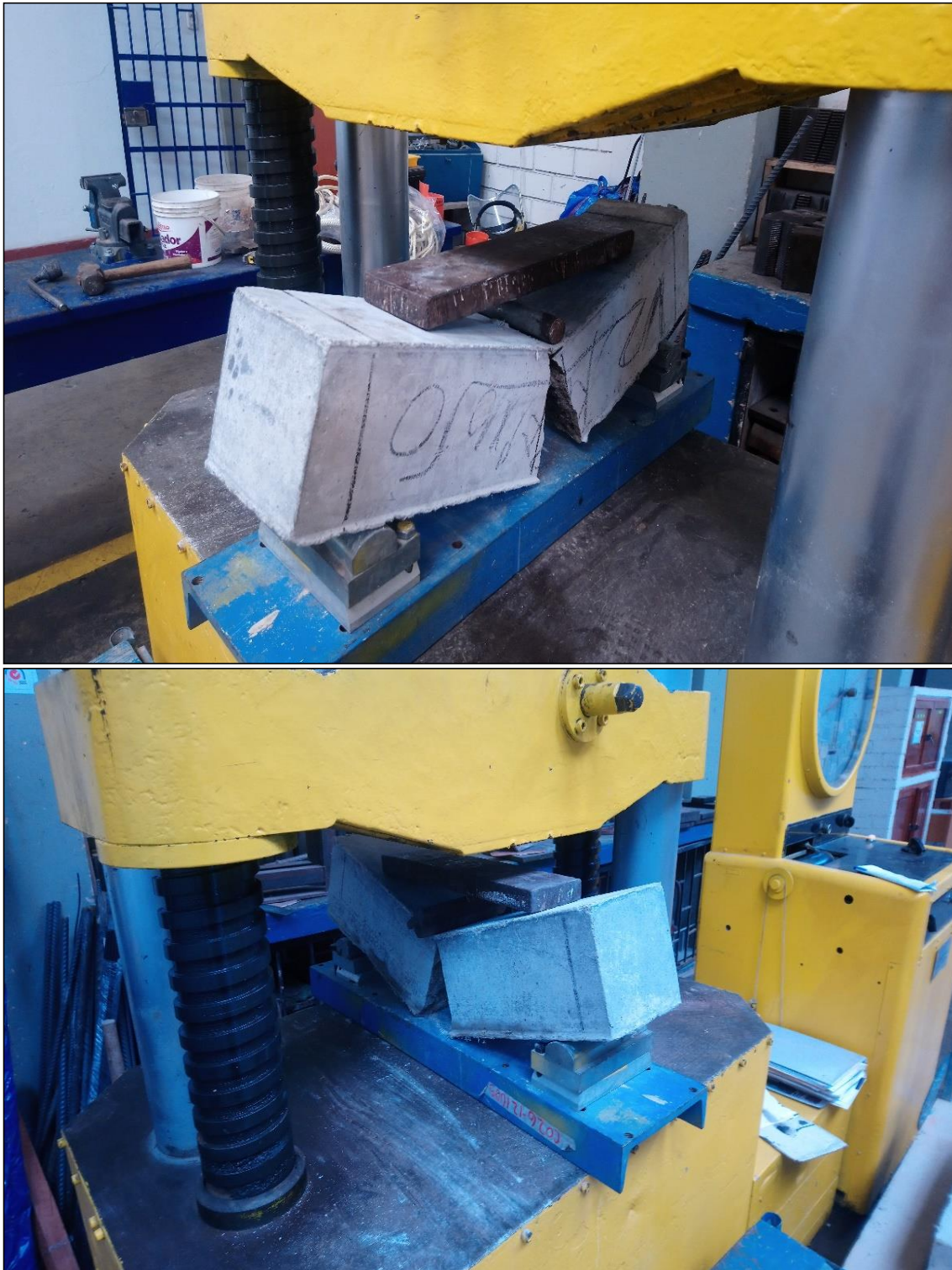
Figura IV-19: Estado de falla de la viga de concreto, ensayada a flexión con carga aplicada en el centro de la luz
