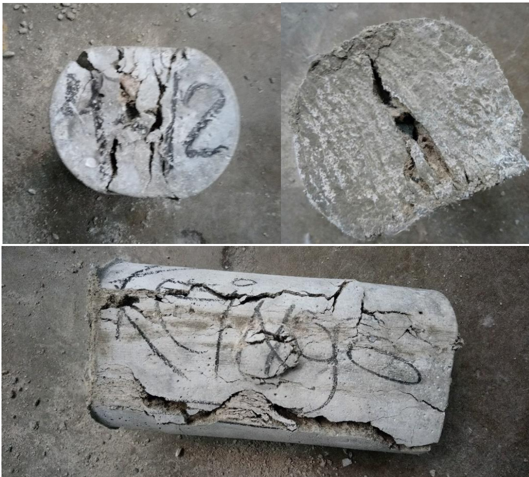
Figura VI-29: Fallas en probetas con relación ( a/c = 0.60 ) fibrorreforzadas al 2.00%, con 28 días de curado (ensayo de tracción por compresión diametral).
