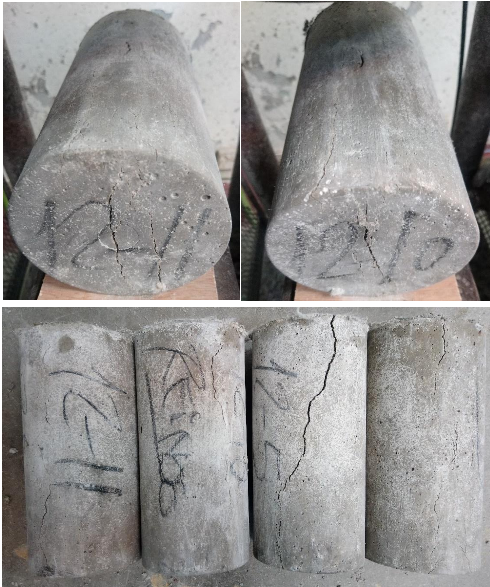
Figura VI-37: Fallas en probetas con relación ( a/c = 0.70 ) fibrorreforzadas al 2.00%, con 28 días de curado (ensayo de tracción por compresión diametral).
