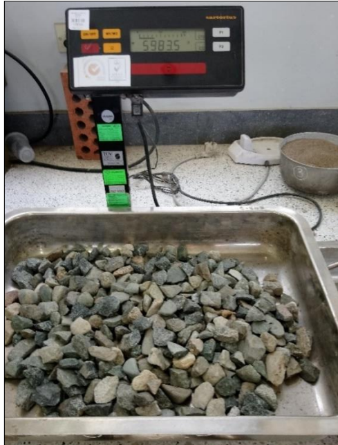
Figura III-39: Peso de muestra de agregado grueso en estado seco más recipiente.
