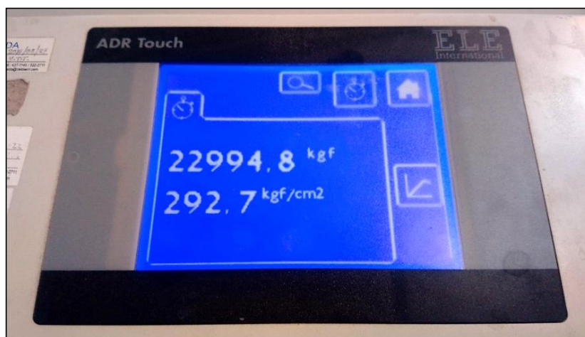
Figura IV-9: Fuerza máxima en kilogramos aplicada en compresión axial a la probeta de concreto
