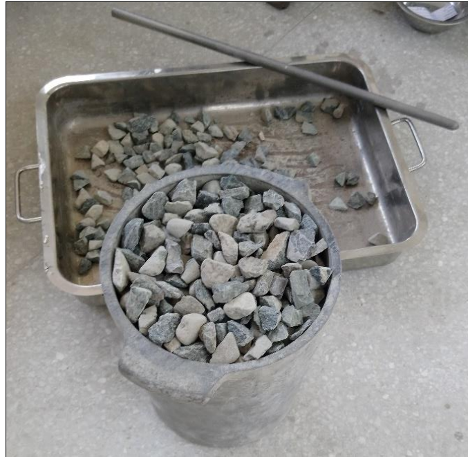
Figura III-29: Proceso de llenado de recipiente de 1/3 \text{ pie}^3 para ensayo de peso unitario suelto.
