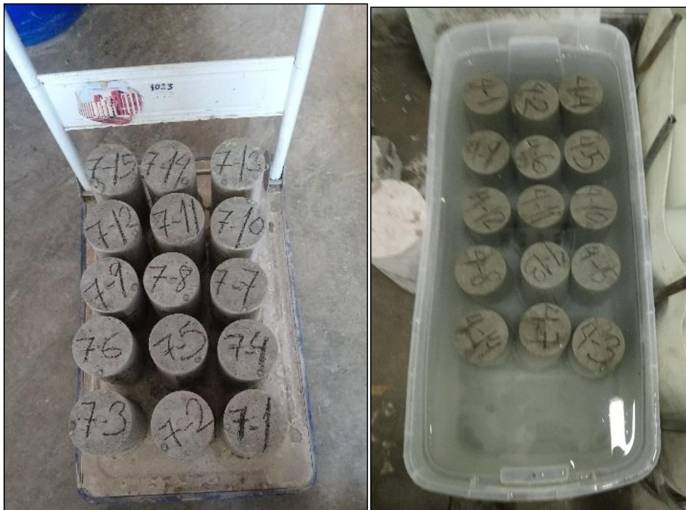
Figura IV-5: Fabricación y curado de probetas de concreto.
