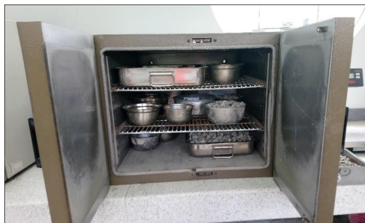
Figura III-26: Proceso de secado de muestras en horno eléctrico a la temperatura de 110 °C.
