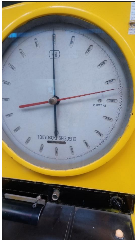
Figura IV-20: Fuerza máxima en kilogramos aplicada a la viga en el centro de luz
