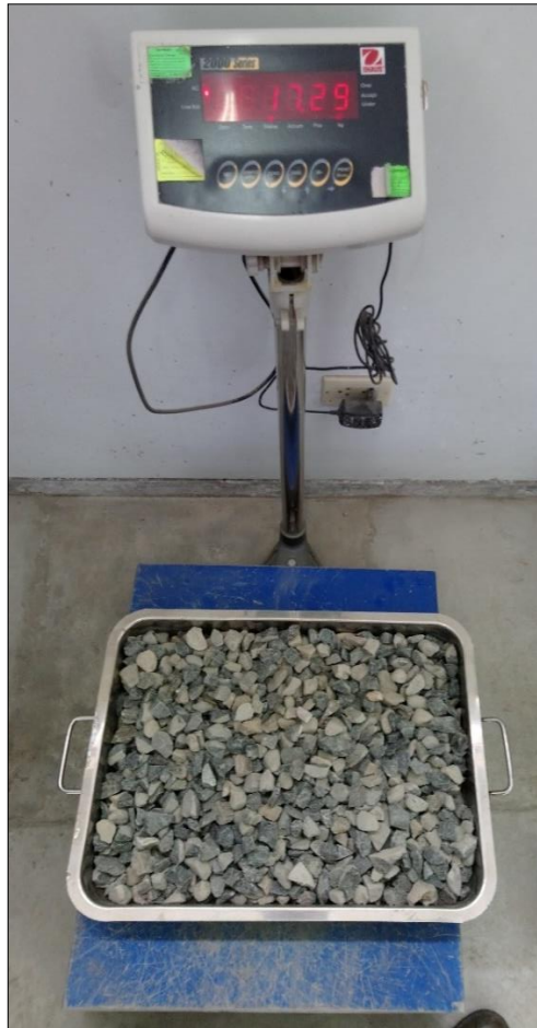
Figura III-25: Peso en balanza de muestra de 15.00 kg de agregado grueso, cabe resaltar que el peso del recipiente metálico es de 2.29 kg, resultando una lectura total de 17.29 kg en el panel de la balanza.
