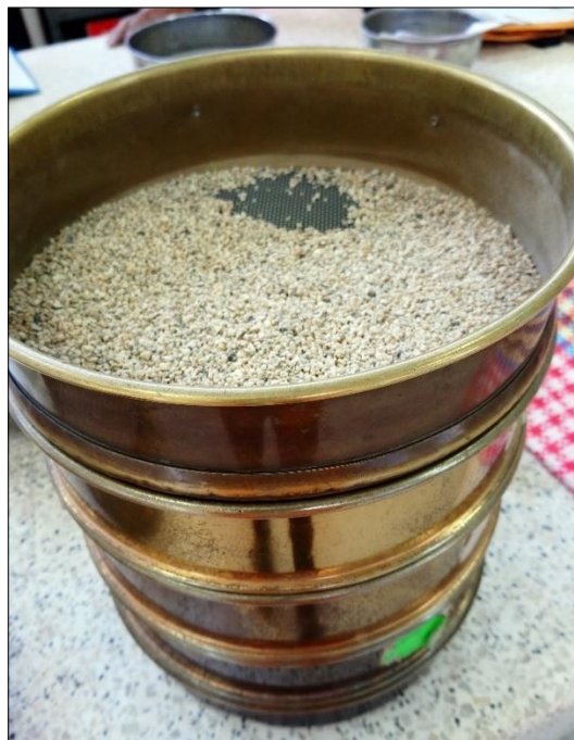
Figura III-20: Colocación de la muestra de agregado fino en los tamices normalizados.
