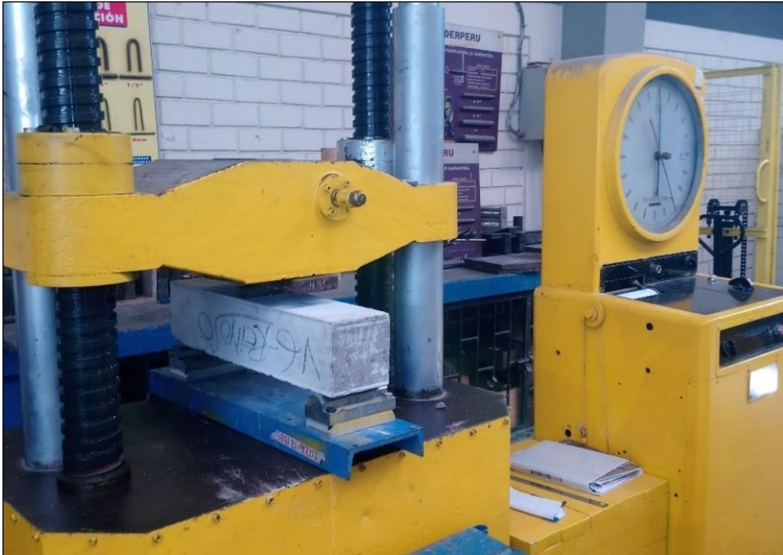
Figura IV-18: Ensayo de flexión de vigas concreto, con carga aplicada en el centro de la luz
