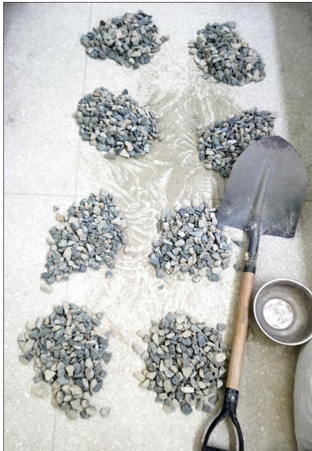
Figura III-24: Proceso de cuarteo para obtención de muestras representativas de agregado fino.
