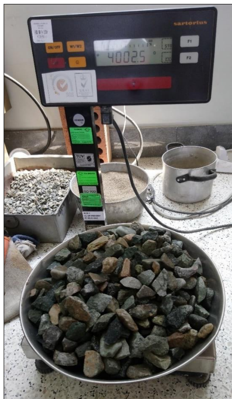
Figura III-36: Muestra de 4002.50 g de agregado grueso en estado saturado superficialmente seco.
