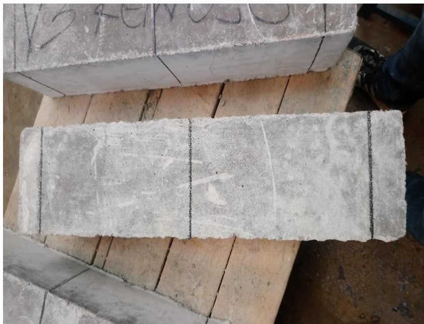
Figura IV-15: Líneas guía marcadas en las vigas de concreto.
