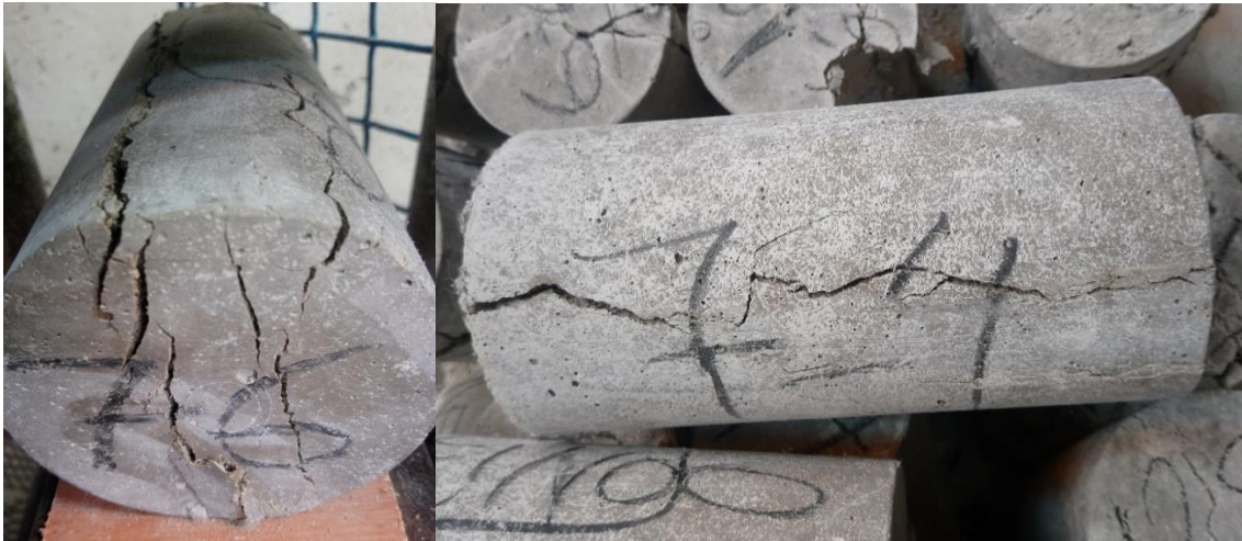
Figura VI-32: Fallas en probetas con relación ( a/c = 0.65 ) fibrorreforzadas al 1.00%, con 28 días de curado (ensayo de tracción por compresión diametral).
