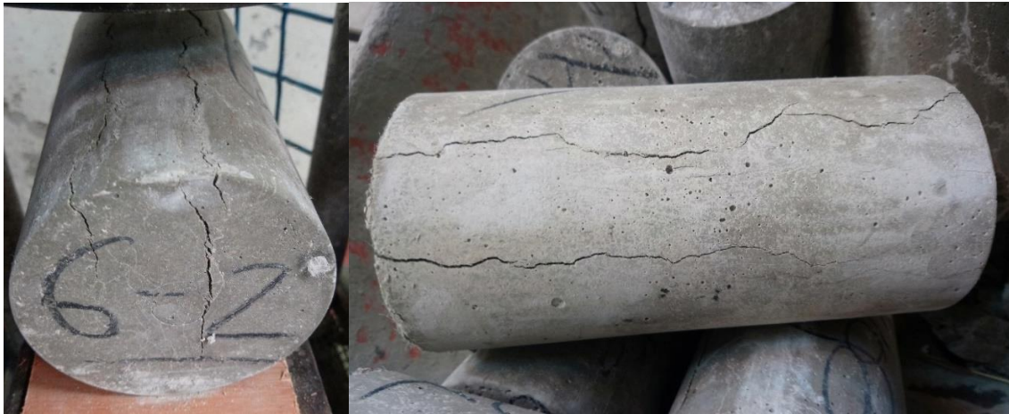
Figura VI-31: Fallas en probetas con relación ( a/c = 0.65 ) fibrorreforzadas al 0.50%, con 28 días de curado (ensayo de tracción por compresión diametral).
