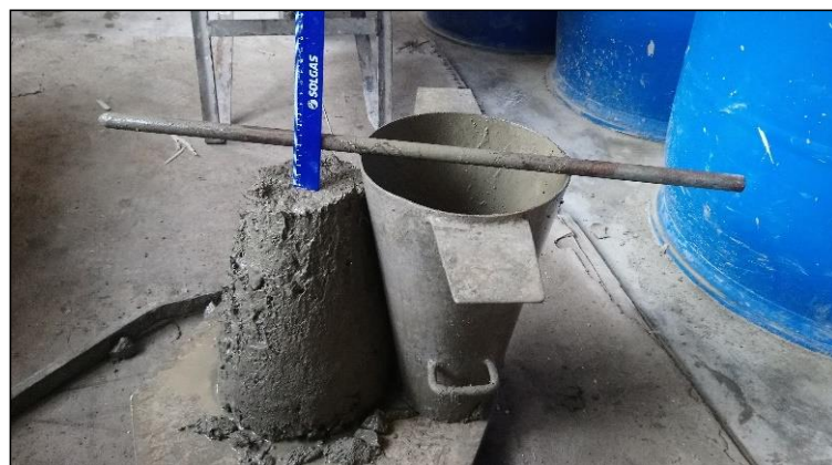
Figura VI-4: Asentamiento en concreto fibrorreforzado al 2.00% – ( a/c= 0.65 ).
