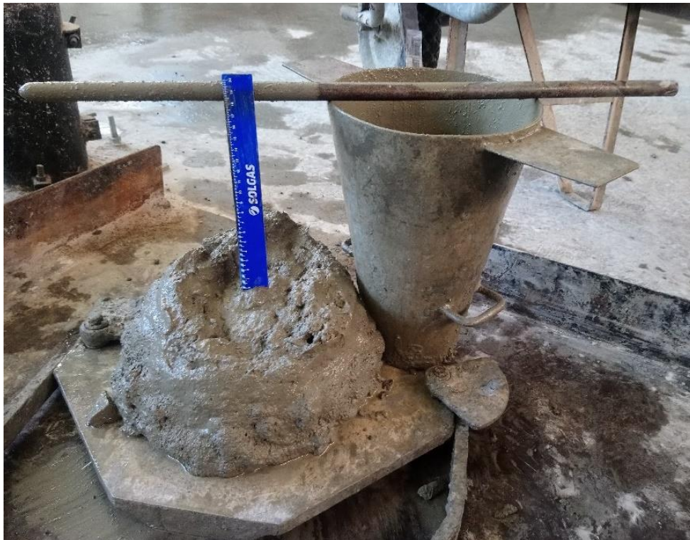
Figura IV-2: Lectura de asentamiento en muestra de concreto fresco.
