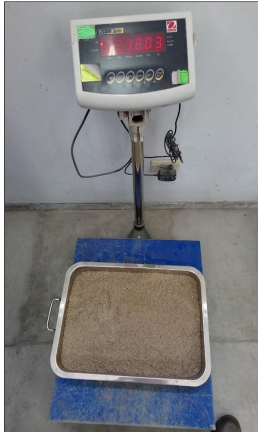
Figura III-3: Peso en balanza de muestra de 10.00 kg de agregado fino, cabe resaltar que el peso del recipiente metálico es de 2.03 kg, resultando una lectura total de 12.03 kg en el panel de la balanza.
