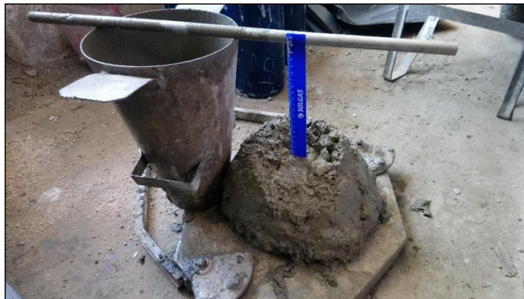
Figura VI-2: Asentamiento en concreto fibrorreforzado al 0.50% – (a/c= 0.65).
