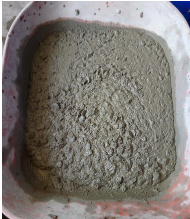
Figura IV-1: Muestra de concreto para el ensayo de Asentamiento
