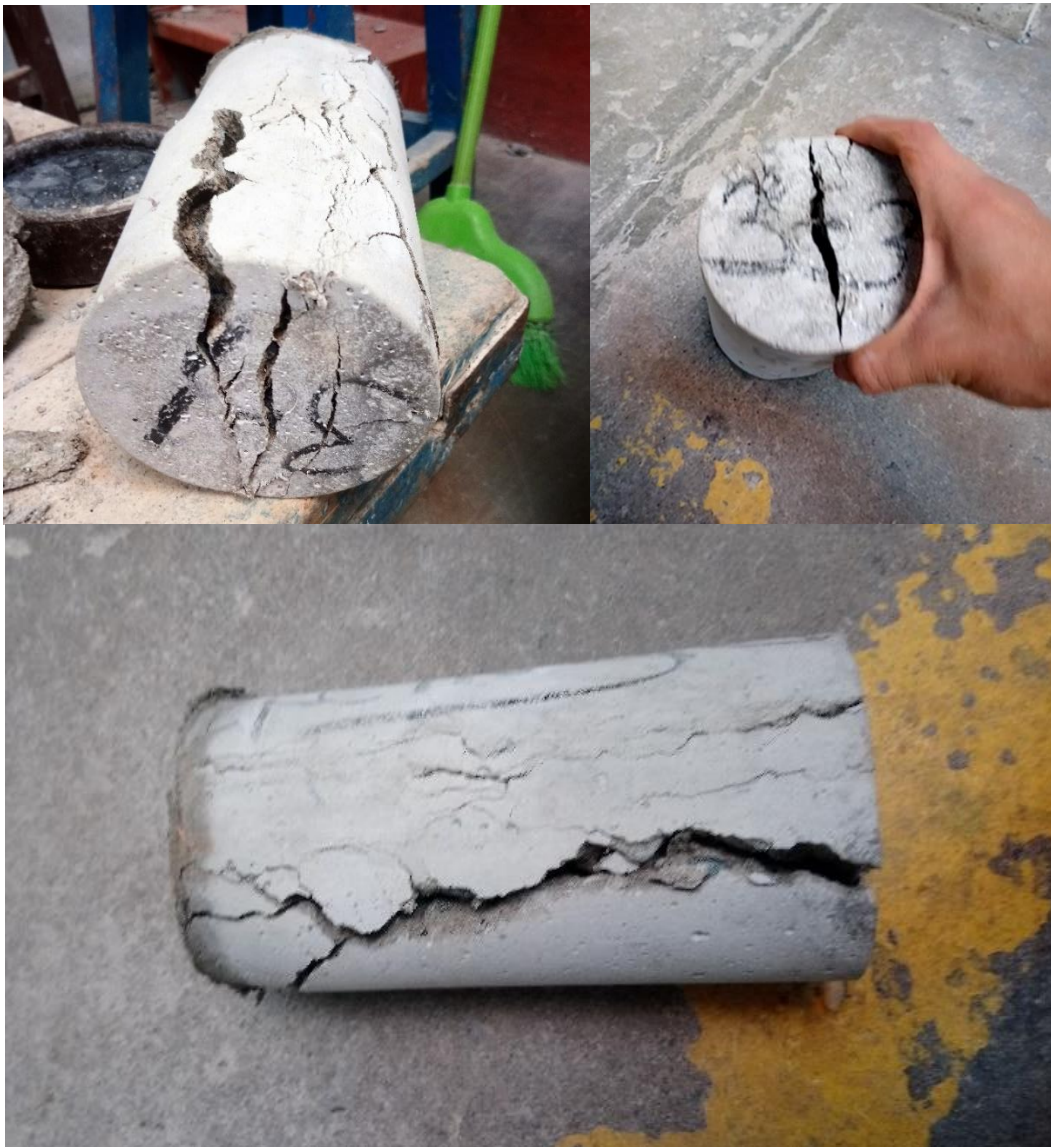
Figura VI-28: Fallas en probetas con relación ( a/c = 0.60 ) fibrorreforzadas al 1.00%, con 28 días de curado (ensayo de tracción por compresión diametral).
