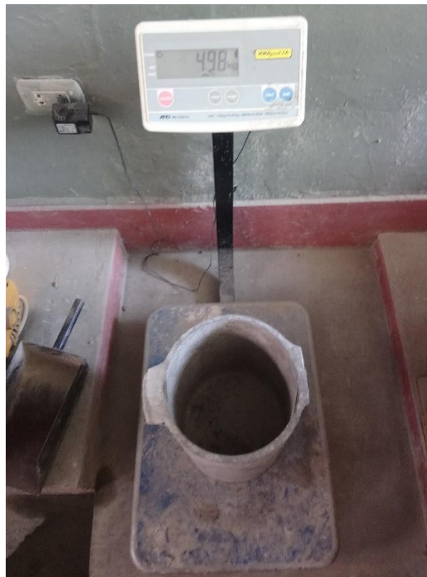
Figura IV-3: Peso de recipiente normalizado de volumen nominal ( 1/3 \text{ pie}^3 ), para el ensayo de "Peso unitario" de concreto fresco
