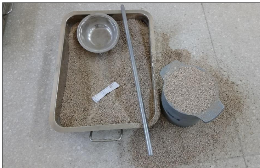
Figura III-8: Recipiente más muestra de agregado fino en estado compactado.
