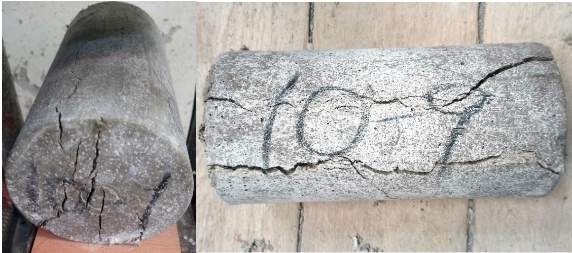
Figura VI-35: Fallas en probetas con relación ( a/c = 0.70 ) fibrorreforzadas al 0.50%, con 28 días de curado (ensayo de tracción por compresión diametral).
