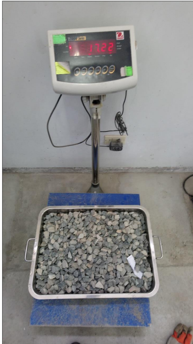
Figura III-27: Peso en balanza de muestra seca de 14.93 kg de agregado grueso, cabe resaltar que el peso del recipiente metálico es de 2.29 kg, resultando una lectura total de 17.22 kg en el panel de la balanza.
