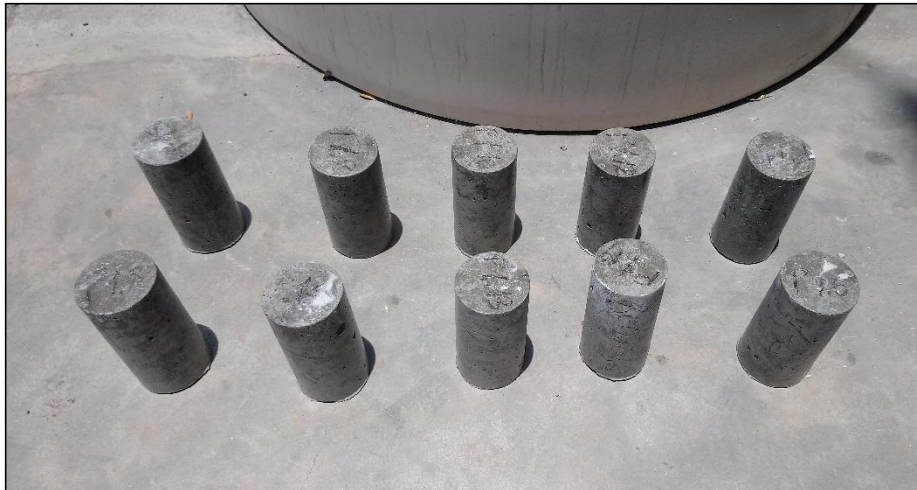
Figura IV-6: Muestra de probetas de concreto secando al ambiente.
