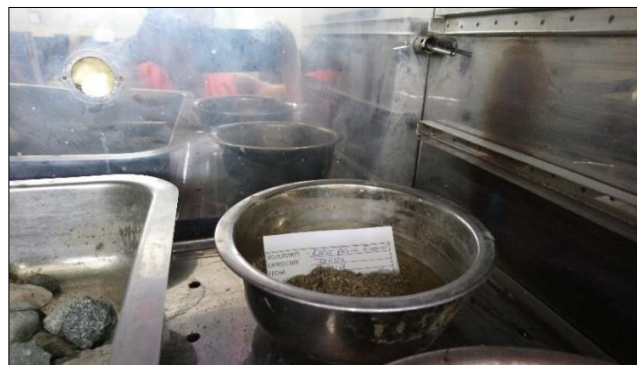
Figura III-17: Secado en horno de la muestra durante 24 horas a una temperatura de 110°C.
