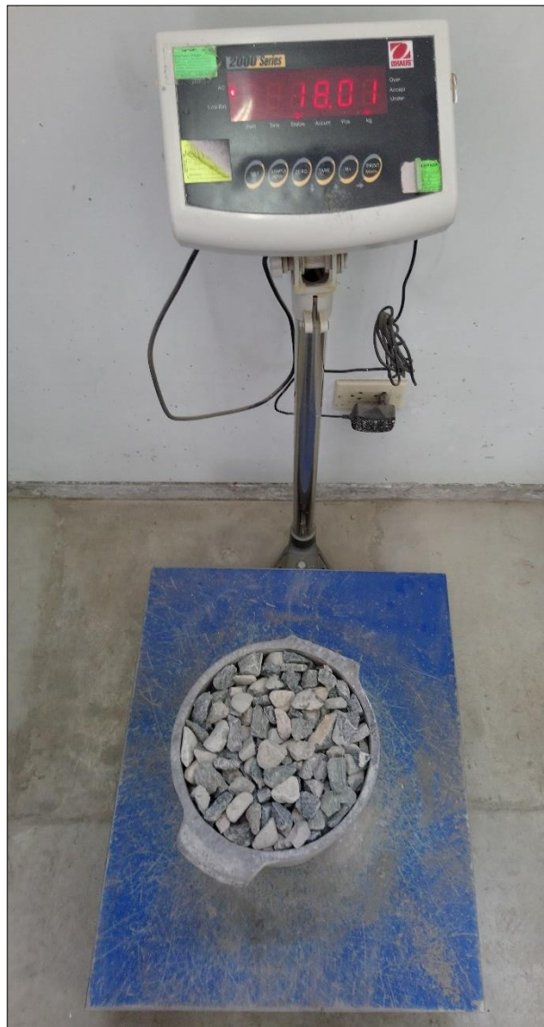
Figura III-31: Peso del recipiente normalizado de volumen nominal ( 1/3 \text{ pie}^3 ) + muestra de agregado grueso en estado suelto (sin compactar).
