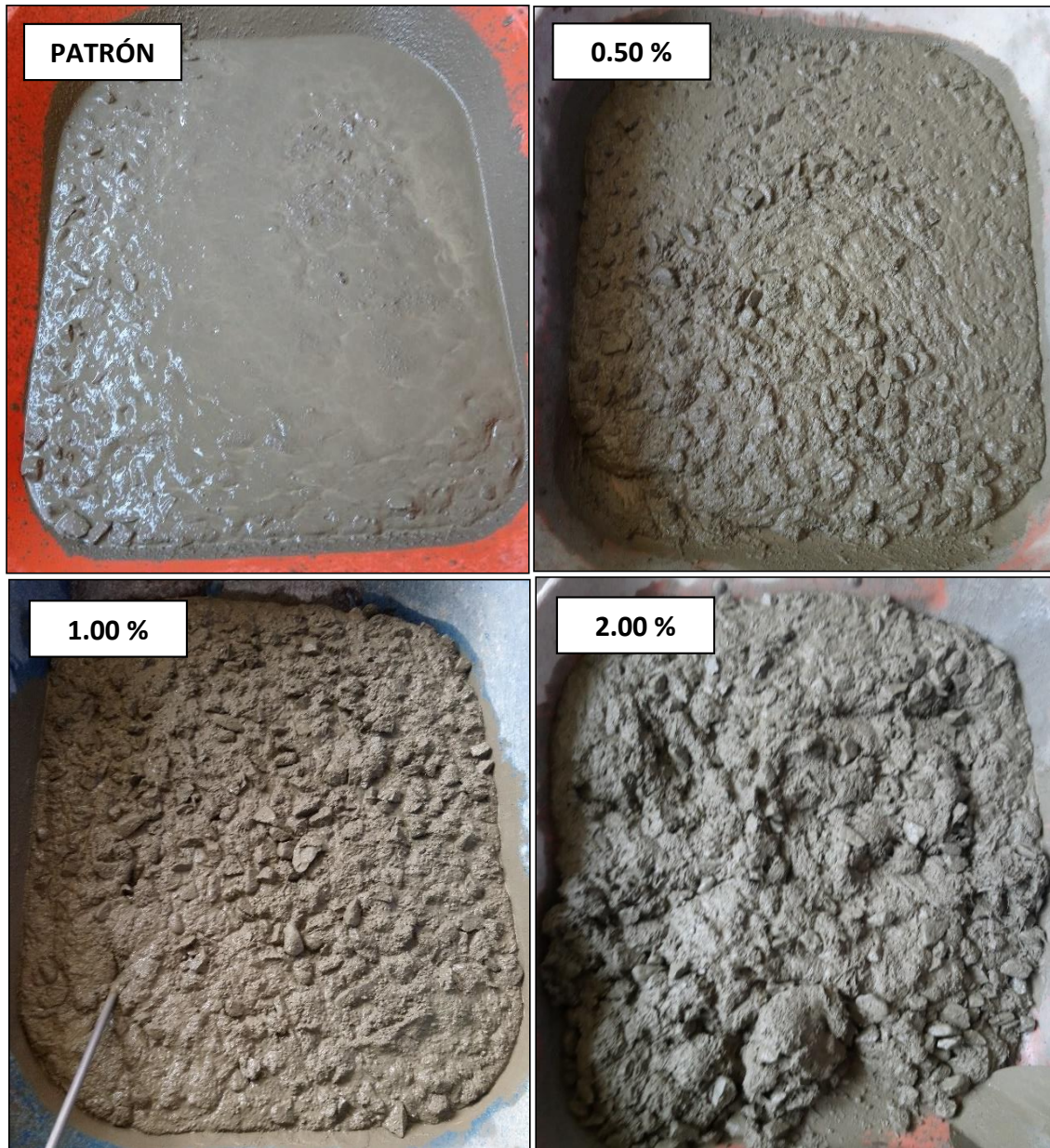
Figura VI-5: Mezclas de concreto patrón y fibrorreforzado al 0.50%, 1.00% y 2.00% – ( a/c= 0.65 )
