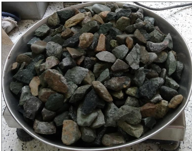
Figura III-34: Muestra de agregado grueso saturado durante 24 horas.
