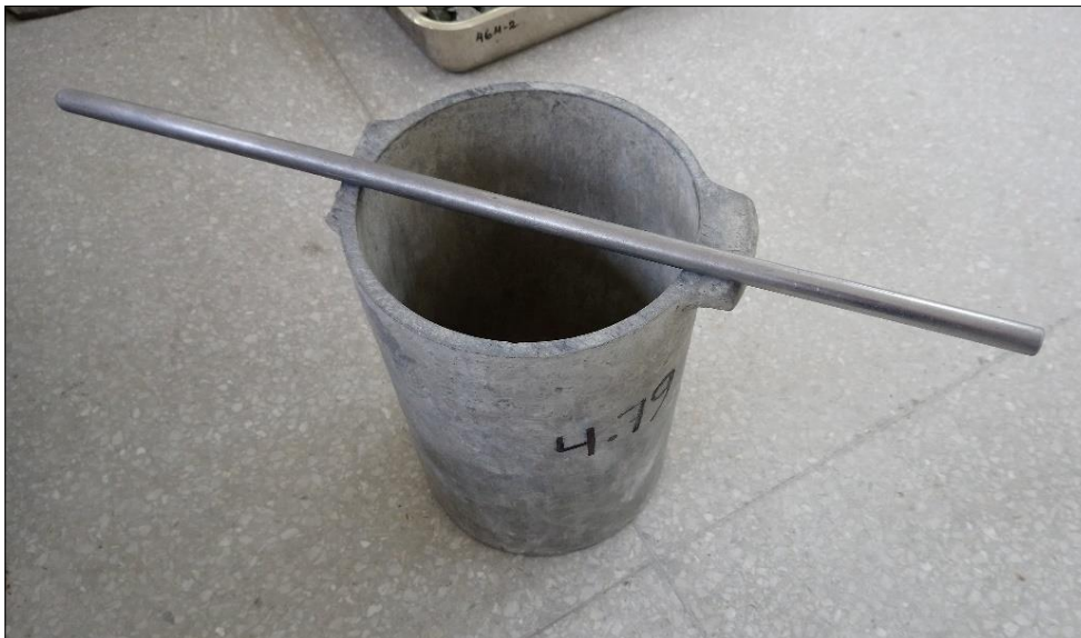
Figura III-28: Recipiente normalizado de volumen nominal ( 1/3 \text{ pie}^3 ), para ensayo de peso unitario suelto y compactado.
