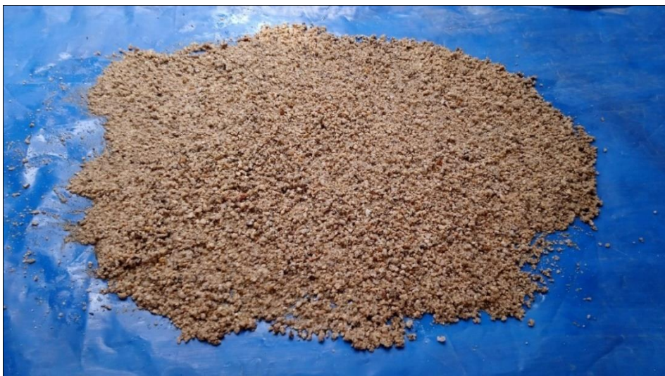
Figura III-10: Muestra de agregado fino saturado, extendida sobre superficie plana no absorbente.
