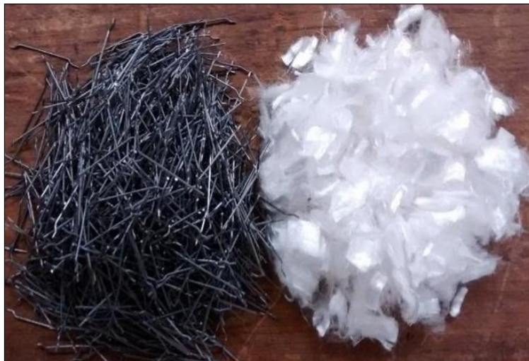
Figura II-13: Macrofibra metálica vs Microfibra de polipropileno.
