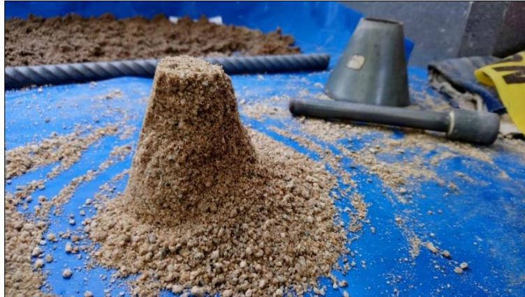
Figura III-11: Muestra de agregado fino en estado saturado superficialmente seco.
