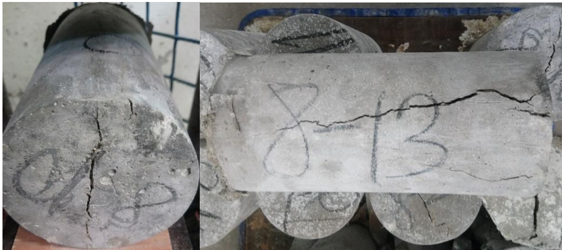
Figura VI-33: Fallas en probetas con relación ( a/c = 0.65 ) fibrorreforzadas al 2.00%, con 28 días de curado (ensayo de tracción por compresión diametral).
