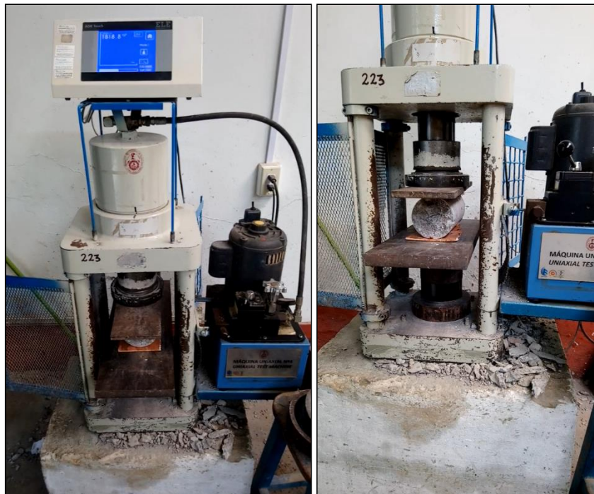
Figura IV-11: Ensayo de tracción por compresión diametral en probeta de concreto
