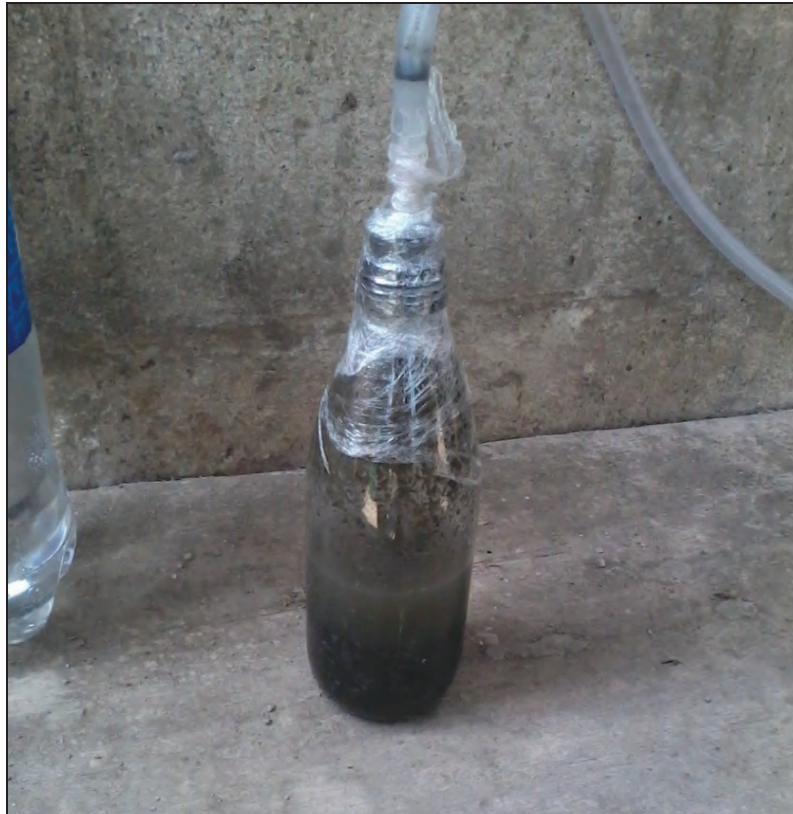
Foto 6. 6: Se muestra el sellado hermético de un reactor. El frasco se une a la manguera de silicona en forma de “Y” mediante una aguja hipodérmica N° 16. La junta entre el frasco y la manguera de silicona se cubre con papel film.
