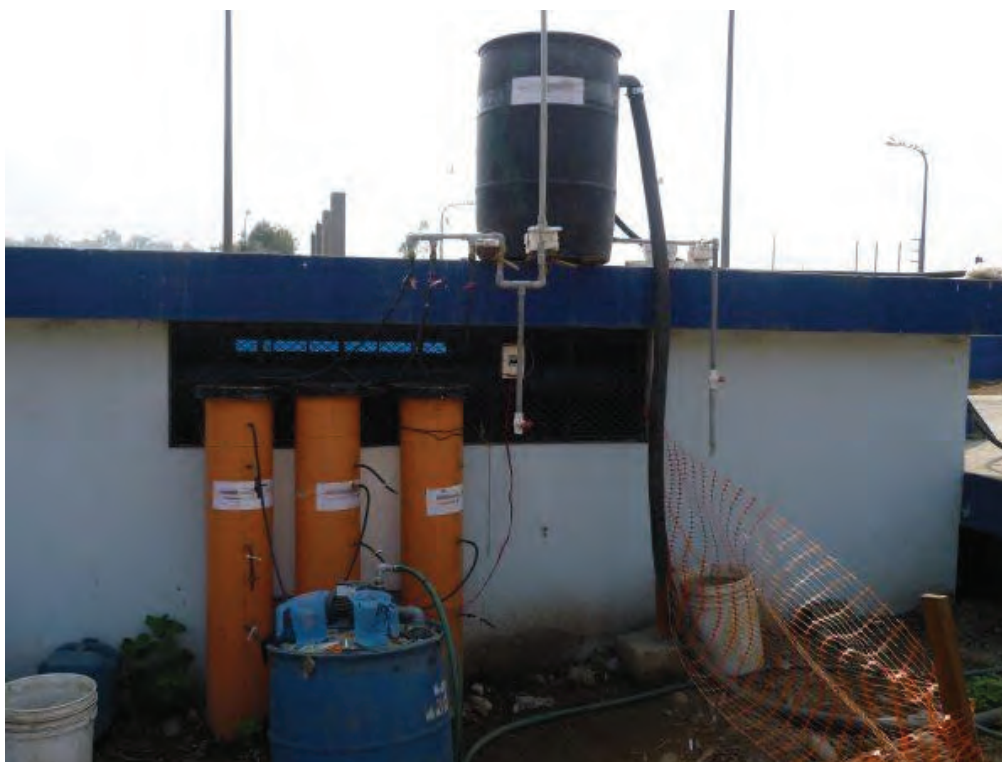
Foto 6. 1: En la fotografía se observa el piloto de TSA 1, 2 y 3 ubicado en la PTAR Carapongo – Sedapal.
