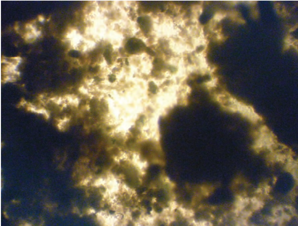
Foto 7. 2: Se muestra lodo proveniente del TSA2. La forma del flóculo es ovalada.
