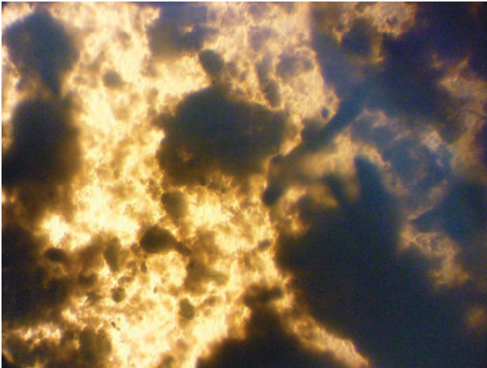
Foto 7. 3: Se muestra lodo proveniente del TSA3. La forma del flóculo es ovalada.
