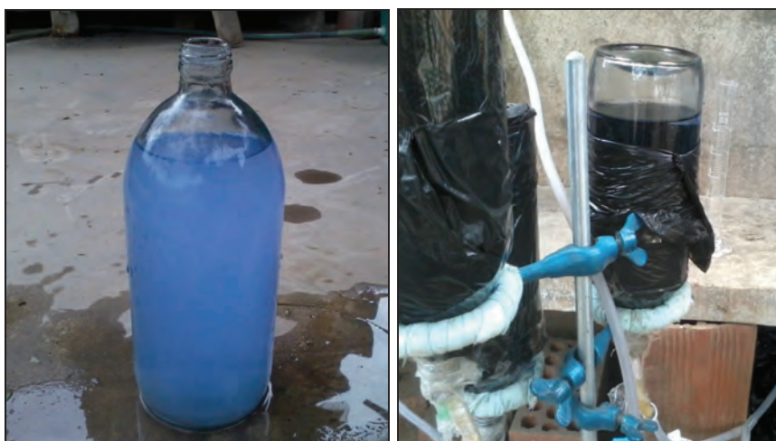
Foto 6. 9: La foto de la izquierda se aprecia el frasco de 1000 mL con la solución de NaOH después de vertido el azul de timol. La foto de la derecha muestra el frasco ya colocado en el soporte universal el cual tendrá la función de mantener los frascos de agua invertidos y dirigidos hacia las probetas. Para hermetizar el frasco se realiza el mismo procedimiento que el descrito en la fotografía 6.6.
