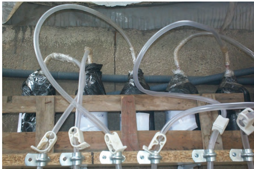
Foto 6. 7: Se muestra los 4 reactores AME instalados sobre una repisa de madera.
