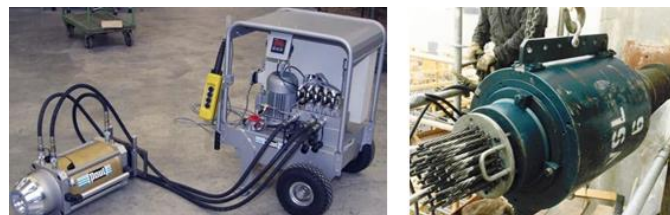
Figura 39: Equipo de tensado (gato multi-torón) Fuente: Google Imágenes, n.d.
