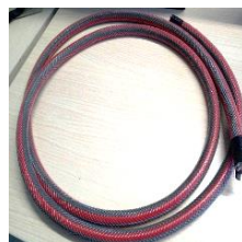
Figura 21: Tubo de inyección de grout.
