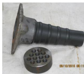
Figura 18: Trompeta con su correspondiente cabeza de anclaje.
