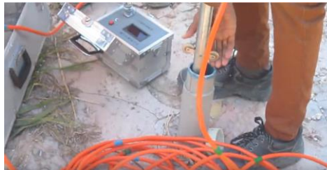
Figura 92: Colocación de la sonda inclinométrica para la toma de medidas. Fuente: Google Imágenes, n.d.
