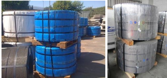
Figura 86: Rollos de acero de pretensar, almacenados a una altura respecto del suelo.
