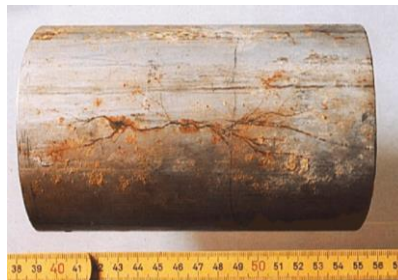
Figura 78: Tubo de acero que fue sometido a esfuerzos de tracción, presenta fisuras y corrosión por esfuerzo.
