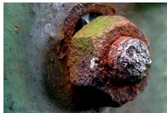
Figura 81: Tuerca y vástago, corroídos por ataque bacteriano.
