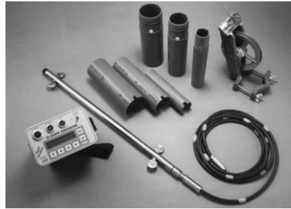
Figura 91: Componentes típicos del equipo de inclinometría. Fuente: ASTM, D 6230-98 (Reapproved 2005): Standard Test Method for Monitoring Ground Movement Using Probe-Type Inclinometers, 2005.
