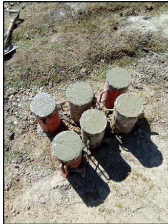
Fig. N° 51: Extracción de muestras de concreto Fuente: Propia
