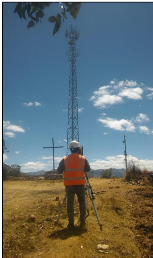
Fig. N° 58: Prueba de Verticalidad Fuente: Propia
