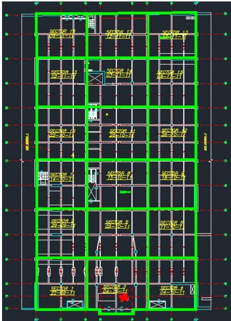
Figura N° 5.1 Modelo de Planeamiento de obra en Obras de Envergadura. Identificación de Unidades de Producción. – Elaboración Propia
