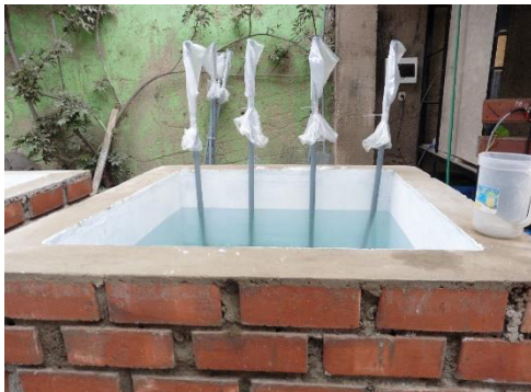
Figura 8-2 Prueba hidráulica de los humedales
