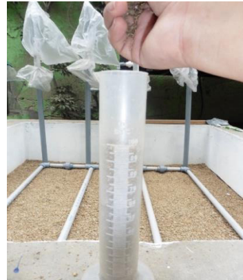
Figura 8-12 Medición de la porosidad del sustrato arena gruesa
