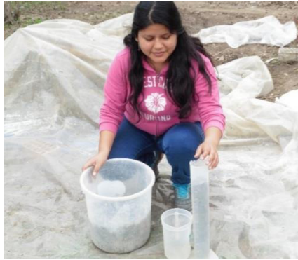
Figura 8-11 Medición de la porosidad del sustrato grava media (confitillo)
