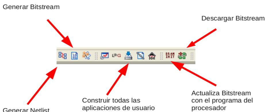
Fig.3.3 Botones de barra de herramientas Hardware y Software (Fuente: Elaboración propia)
