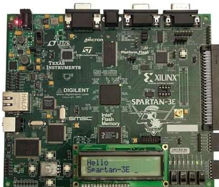
Fig.3.2 Módulo de desarrollo basado en el FPGA Spartan 3E (Fuente: Guía de usuario del kit de inicio Spartan 3E [21])
