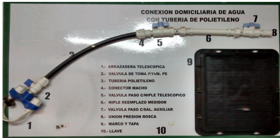
Figura N°03: Conexión de agua potable
